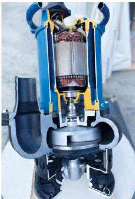
**Blick in eine Schmutzwasserpumpe:** Gehäuse, Motor, Laufrad, Schmierung und Dichtungen sind Bauteile mit hoher Relevanz für die Zuverlässigkeit des Aggregats. (Foto: Tsurumi)
