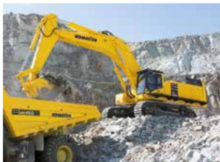
**Neu im Portfolio:** Der 98 t-Hydraulikbagger PC950LC-11 wurde von Komatsu für Mining- und Steinbruch-Einsätze entwickelt. (Foto: Komatsu)
