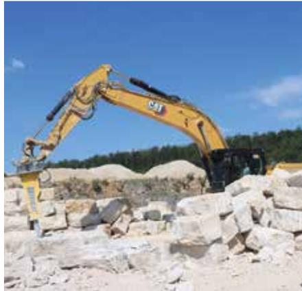
**Ressourcenschonendes Arbeiten:** Ein Cat Kettenbagger 336 der neuen Generation bearbeitet Mauersteine mit dem Hammer.
