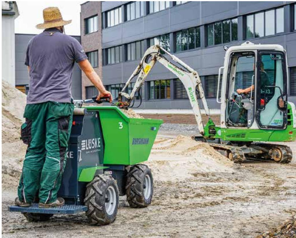
**Vielseitig:** Mit seiner Nutzlast von 800 kg, der Breite von 900 mm und seinem akkubetriebenen Elektromotor ist der Minidumper C301L von Bergmann für verschiedene Einsätze im GaLaBau geeignet. (Fotos: Bergmann)
