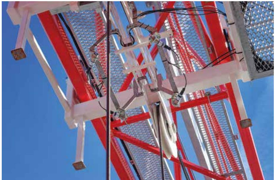
**Sicherer arbeiten:** Mit Hilfe von akkubetriebenen Sensoren an Laufkatze und Unterflasche des Kranhakens passt das zuschaltbare Assistenzsystem HiSPS die Bewegungen des Seils der Bewegung und der Geschwindigkeit von Drehwerk und Laufkatze automatisch an. (Fotos: Wolffkran)
