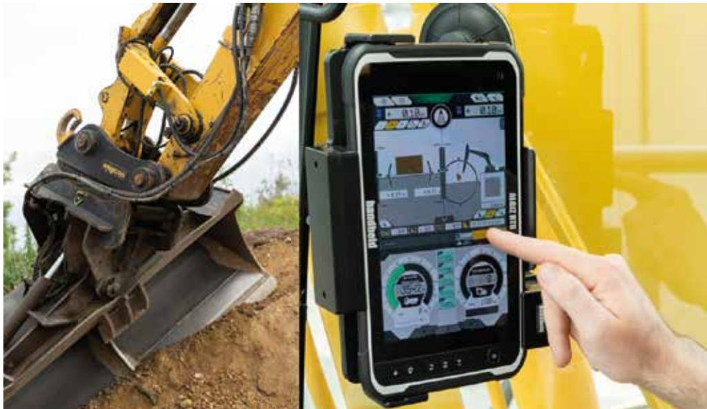
**Digitales Tool:** Komatsu führt 3D-Anzeigesystem 3D Machine Guidance Kit mit optionaler Nutzlastwaage für Hydraulik- und Mobilbagger ein. (Foto: Komatsu)
