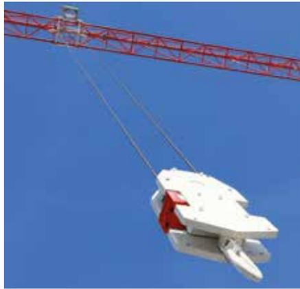
**Zukunftsgerichtet:** Das High-Speed-Positioning-System legt den Grundstein für den autonom fahrenden, digitalisierten Kran. Die generierten Kranbewegungs- und Positionsdaten können mittels BIM in die moderne digitale Baustellenorganisation integriert werden.
