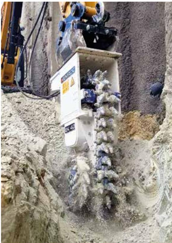
Bagger-Anbaufräsen von KEMROC wie diese Kettenfräse der Baureihe EK lösen schwierige Aufgaben im Bauwesen, die mit anderen Anbaugeräten nur schwierig oder überhaupt nicht zu schaffen sind. Gleich zwei Modelle des Herstellers kamen beim Einrichten einer Baugrube in Königstein im Taunus zum Einsatz.
