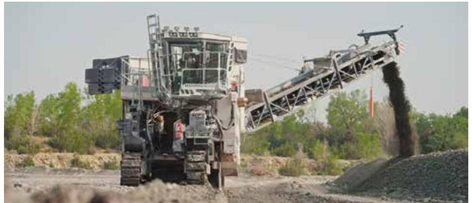
**Effektiv:** Der 280 SM(i) schneidet, zerkleinert und verlädt das gewonnene Material in einem Arbeitsgang. (Foto: Wirtgen)
