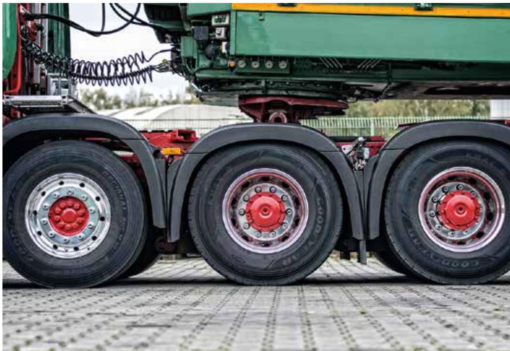
**Kein Pardon:** Ein Fahrer darf sich bei Übernahme eines Sattelzuges nicht mit der Information begnügen, dass das zulässige Gesamtgewicht nicht überschritten ist. Er muss die Achslasten per Waage feststellen oder eine Unterladung in Kauf nehmen. (Foto: pixabay/Tama66)
