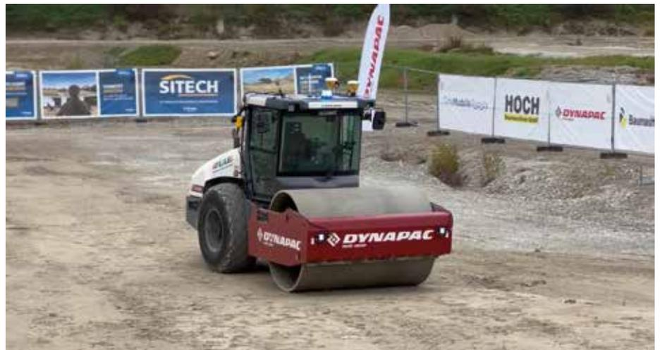
**Autonome Walze:** Trimble und sein Vertriebs- und Servicepartner Sitech haben im Rahmen der bauma die fahrerlose Bodenverdichtung vorgeführt. (Fotos: Trimble)
