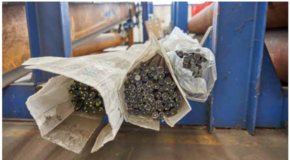
**Verschleißbeständig:** Hardox 400 und 500 Rundstäbe sind, wie auch die Rohre, in vielen gängigen Dimensionen verfügbar. (Foto: SSAB)
