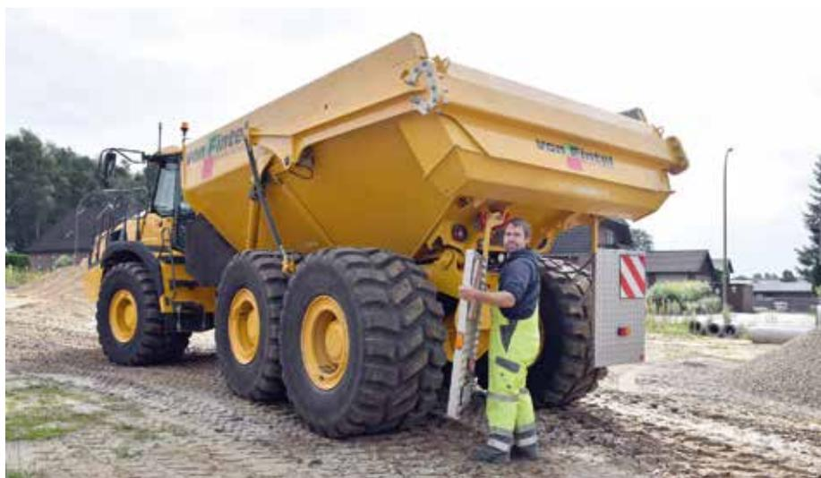
**Schnell umgerüstet:** Mit wenigen Handgriffen hat Fahrer Nils Bölter den Spritzschutz für den Straßenbetrieb auf der Baustelle abmontiert. (Foto: Kiesel)
