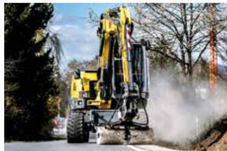
Mit der DMS Bodenfräse können Arbeiten im GaLaBau statt mit einer handgeführten Motorhacke aus dem Bagger heraus erledigt werden. (Foto: DMS Technologie GmbH)
