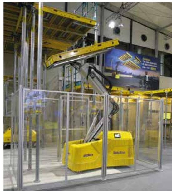
**In Richtung Automatisierung:** Der Schalungsroboter DokaXbot von Doka passt durch jede Tür und schalt Decken in Höhen von bis zu 5,2 m sicher und schnell. (Foto: VDBUM/Spoo)
