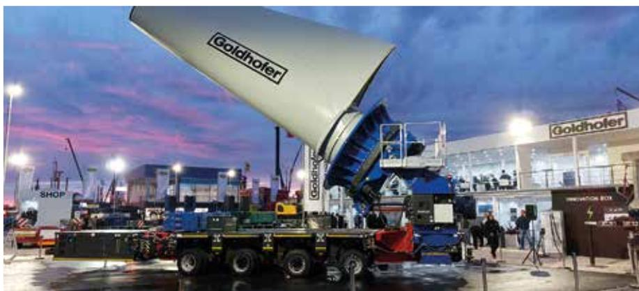
**Schweregewicht:** Die Goldhofer PST/SL-E Split-Kombination mit der neuen Flügeltransportvorrichtung FTV 850 wurde auf der bauma vorgestellt. Sie beeindruckt mit hoher Seitenstabilität. (Foto: Goldhofer)
