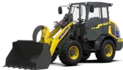
**Prototyp:** Komatsu stellte den Prototyp des ersten vollelektrischen Kompaktraders vor, der zusammen mit Moog Inc. hergestellt wurde. Sein intelligentes Maschinenelektrifizierungssystem ermöglicht Vernetzung und Automatisierung. (Foto: Komatsu)
