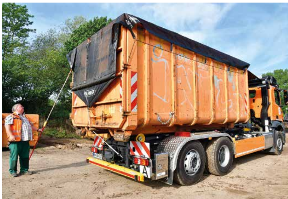
Absolute Neuerung: Das automatische Container-Abdecksystem Palcover erlaubt schnelles und ergonomisches Handling und gewährleistet die Transportsicherheit des Ladegutes.
