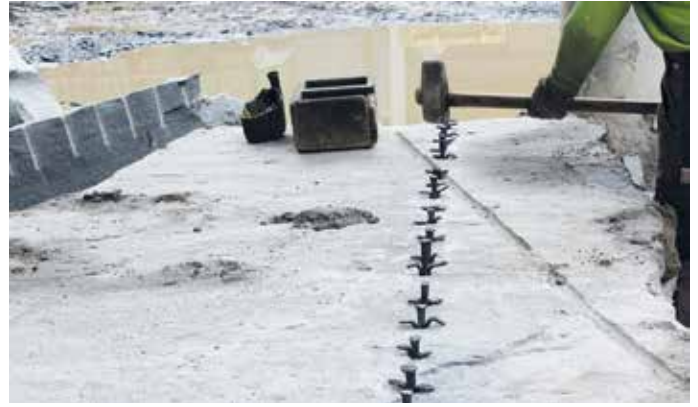
Gneis spaltet sich mit wenigen Hammerschlägen zu kleineren Blöcken. (Fotos: Volvo CE)
