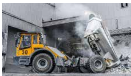
Der 12-Tonner wird für den Abtransport glühend heißer Schlacke eingesetzt. Diese fällt bei der Stahlproduktion an und kann Temperaturen von bis zu 700 °C erreichen.
