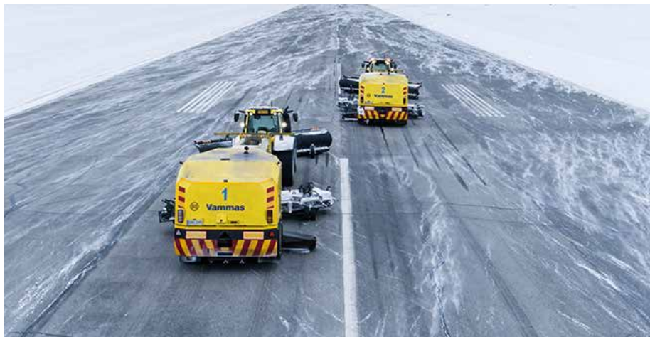
Traktoren sind eine interessante Alternative für Flughafenflotten, bei denen Arbeitsbreiten von 4,5 m ausreichend sind. Die Gesamtbetriebskosten sind erheblich günstiger als die von Lastwagen.
