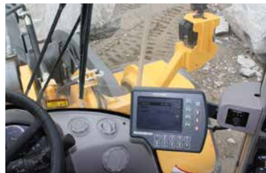
Das Wiegesystem Loadtronic 3 verhindert Überladung und liefert Produktionsdaten des abtransportierten Materials aus dem Steinbruch. Anhand von Größe und Gewicht werden die Blöcke der jeweiligen Werkstatt zugeordnet.
