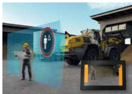
Die aktive heckseitige Personenerkennung bei Großladern schützt vor Unfällen mit Personenschaden.
