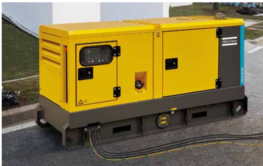
Der QAS 60/35 VSG verfügt über eine automatische, variable Drehzahlregelung zwischen 950 und 2550 U/min und ein integriertes Energiespeichersystem. Dies ermöglicht eine Reduzierung des Kraftstoffverbrauchs um bis zu 40 Prozent. (Bild: Atlas Copco)
