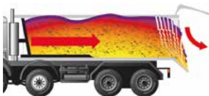
Abschiebemulden verhindern die thermische Entmischung, die beim Abkippen auftritt.
