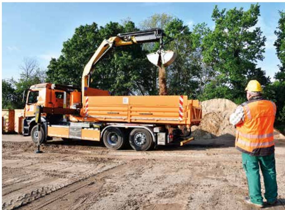
Alleskönner: Der orangefarbene MB Arocs 2645 mit Container-Wechselsystem, Ladekran und Abrollmulde ist in seiner Art ein Unikat. (Fotos: Palfinger)
