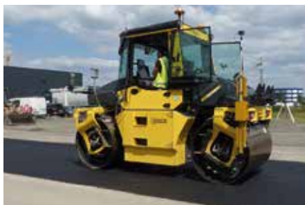
Die Walze fungiert nun nicht mehr rein als abschließendes Verdichtungswerkzeug, sondern liefert wichtige Messergebnisse.
