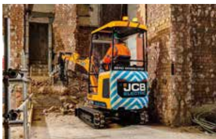
Der vollelektrische Minibagger 19C_1 E-TEC arbeitet komplett ohne Abgasemissionen und hat mit sieben Dezibel (dB) eine sehr geringe Lärmbelastung. (Foto: JCB)
