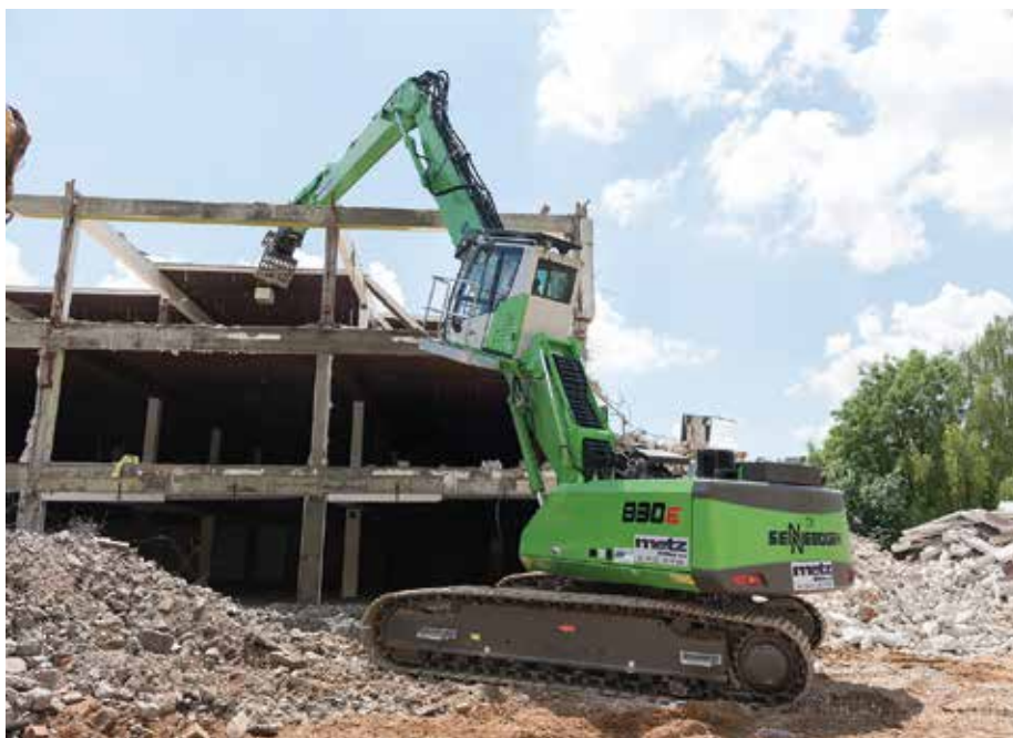
Das hochfahrbare Fahrerhaus bietet optimale Sicht für feinfühliges Arbeiten.
