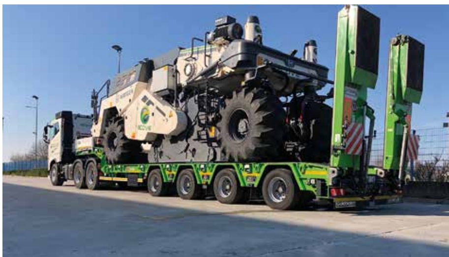
Mit seiner niedrigen Ladehöhe eignet sich der robuste Semiaufleger MPA 4 optimal für den Transport hoher Nutzlasten und Ladungen wie Baumaschinen, Anlagenkomponenten oder Kransegmenten. (Foto: Goldhofer)
