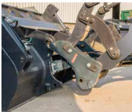
Wechsel ohne Risiko. Der Fahrer des Radladers kann den kompletten Austausch bequem und sicher von seiner Kabine aus steuern. (Foto: Kiesel)
