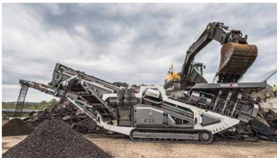
Mit seinem Raupenfahrwerk ist der mobile Asphalt-Shredder von Ammann auch an schwer zugänglichen Stellen einsetzbar
