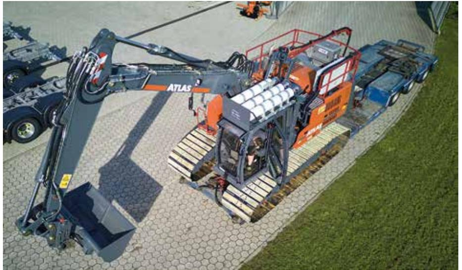
**Transportbereit:** Der Atlas 225 LC Twin Power wurde auf der NordBau gezeigt, bevor er seinen Dienst in der Kampfmittelbeseitigung in der Lüneburger Heide antrat. Auf dem Dach sind die drei verbauten Druckluftflaschen zu sehen, die im Fall der Fälle die Sauerstoffversorgung des Bedieners sicherstellen. (Foto: Atlas von der Wehl)
