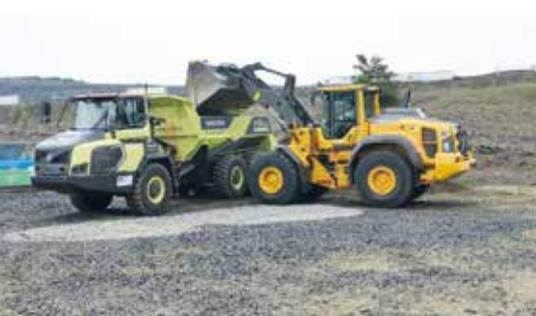
**Prototyp:** Volvo zeigte mit dem X04 den weltweit ersten Brennstoffzellen-Dumper im Einsatz. Dafür wurde auf dem Quarry Vision-Gelände eine Wasserstoff-Tankstelle aufgebaut.
