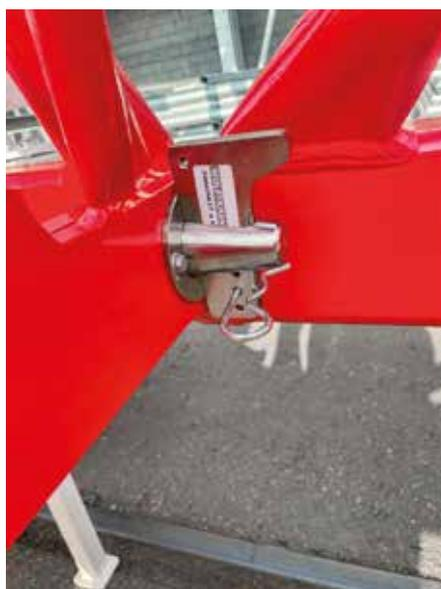
**Praktisch:** Statt mit einer Bolzenverbindung, werden die Auslegerstücke mit einer Dorn- und Keilverbindung an der Stirnseite montiert.
