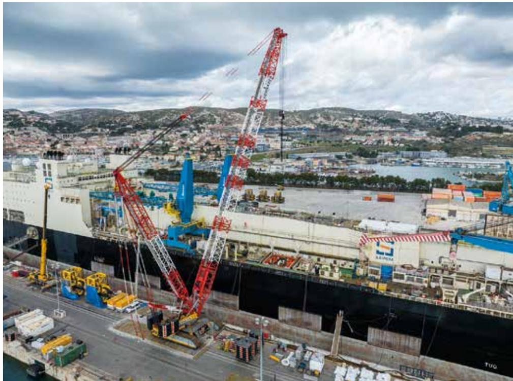
**Kein alltäglicher Einsatz:** Der Tadano-Gittermastraupenkran CC 68.1250-1 hebt im Hafen von Marseille bis zu 500 t schwere Bauteile auf das Pipeline-Verlegeschiff Saipem CastorOne. (Fotos: Tadano)
