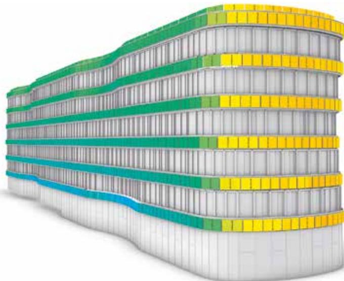
**Veranschaulicht:** Das Photovoltaik-Modul in GD ENERGY errechnet direkt mögliche Energieerträge. (Foto: Strabag)
