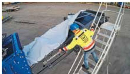
**Spürbare Maßnahme:** Spezielle Bandabdeckungen sorgen für eine effektive Staubreduktion.
