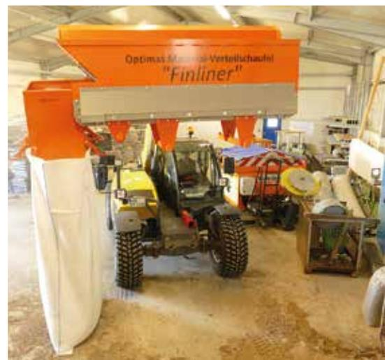
**Durchdachte Lösung:** Über das Förderband der Finliner Materialverteilerschaukel wird das Füllgut in den Big Bag gebracht, der dann am Haltehaken angehängt zum Einsatzort gefahren wird. (Foto: Optimas)
