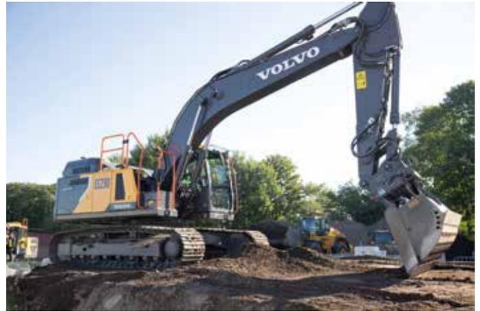
**In Aktion:** Einige NordBau-Aussteller präsentierten aktuelle Maschinenteknik live. Am Swecon-Stand war der Elektro-Raupenbagger E230 Electric von Volvo CE zu bestaunen. (Foto: NordBau)
