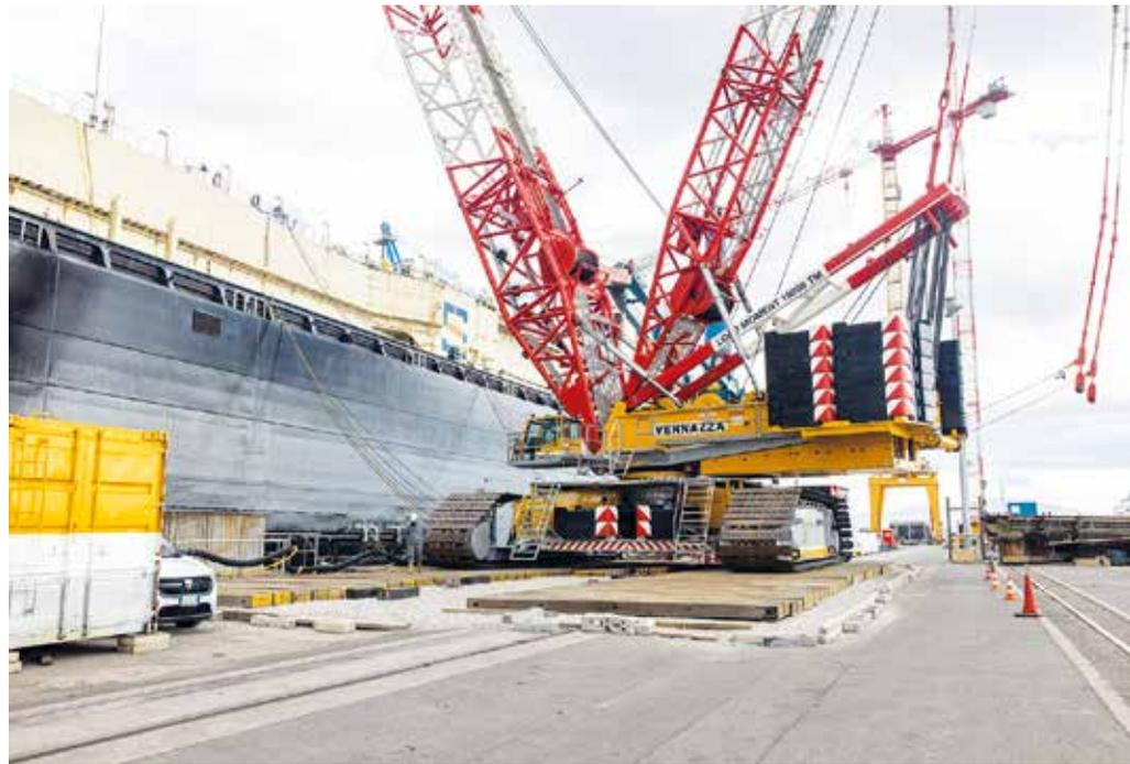
**Perfekt ausgestattet:** Der Kran wurde mit 84 m Hauptausleger und SSL mit komplettem Oberwagen- und Superlift-Gegengewicht konfiguriert.
