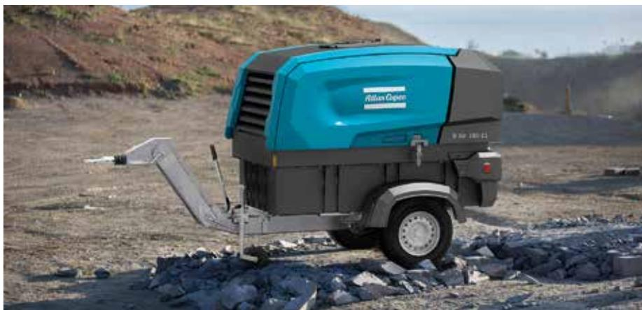
**Saubere Sache:** Der batteriebetriebene mobile Kompressor von Atlas Copco, B-Air 185-12 (Foto: Atlas Copco)
