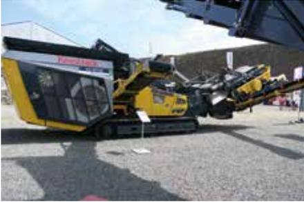
**Variabel:** Der Keestrack-Prallbrecher am Stand von Oppermann & Fuss ist in verschiedenen Varianten erhältlich - als R3h dieselelektrisch, als R3e dieselelektrischen mit Netzeinspeisung und als R3e zero in der Netzstrom-Variante.
