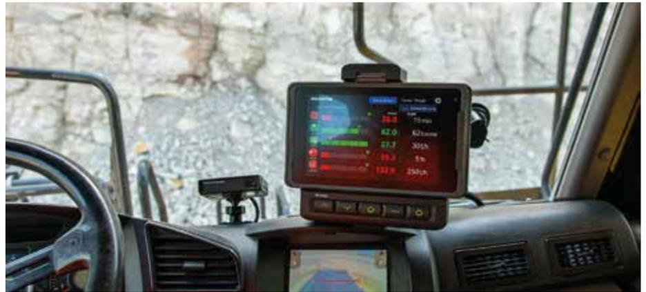
**Effizienzsteigerung:** Mit OGM, einem Monitorsystem zur Fahrerunterstützung, möchte Komatsu seine Kunden bei der täglichen Arbeit im Steinbruch unterstützen. (Foto: Komatsu)
