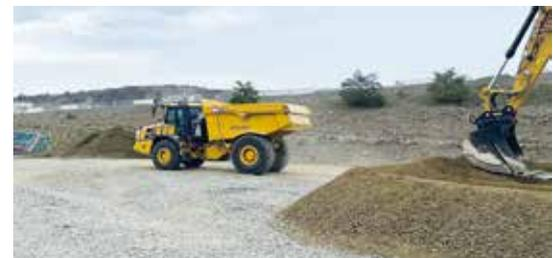
**Wie von Geisterhand:** Gemeinsam mit Bell Equipment zeigte Kiesel auf dem Quarry Vision-Gelände mit einem Bell 30E 4x4, wie autonomes Fahren innerhalb eines Gewinnungsbetriebs ermöglicht wird.
