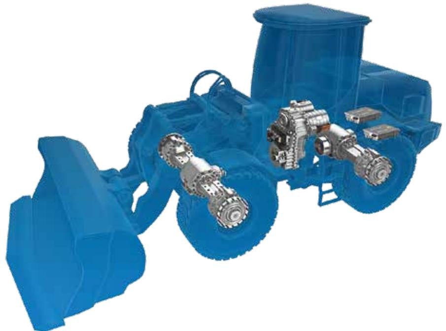
**Emissionsfreier Betrieb:** Mit dem eCD110-210 komplettiert ZF des eTRAC-Portfolio für Baumaschinen bis zu 20 t. (Foto: ZF)
