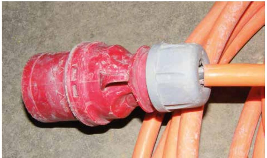
**Abb. 7:** Häufige Unfallursache: Die Zugentlastung hat sich gelöst. Zukünftig muss bei jeder Prüfung besonders darauf geachtet werden.
