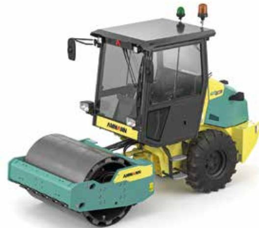
**Sparsam, aber stark:** Die kleinen, kompakten Walzen von Ammann aus der ARS-Baureihe eignen sich für den GaLaBau. Rad- und Gehwege oder Forstwege lassen sich auch in schwierigem Gelände optimal verdichten. (Foto: Ammann)
