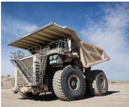
T 274 ist eine 305-t-Maschine, die mit schnellen Zykluszeiten, höheren Produktionsraten, niedrigem Kraftstoffverbrauch und geringen Kosten pro Tonne überzeugt.
