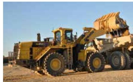
Der WA800-8 mit einem Betriebsgewicht von 115 t verfügt über eine 11,5 m<sup>3</sup> fassende Schaufel.
