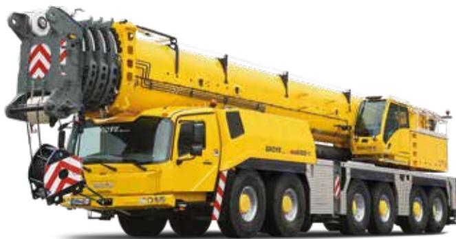
Der Grove-Kran GMK6400-1 AT verfügt über eine maximale Tragfähigkeit von 400 t und einen 60 m langen Hauptausleger. (Foto: Manitowoc)
