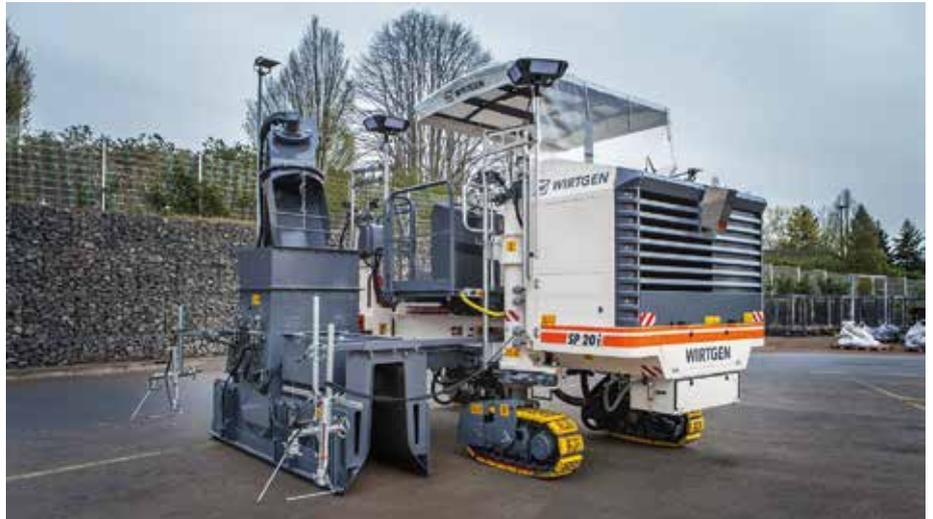
Der SP 20(i) mit direkt am Chassis angebrachten Hubsäulen ermöglicht den effizienten Einbau monolithischer Betonprofile bis 2 m Höhe oder von Betonflächen bis 2,5 m Breite. (Fotos: Wirtgen)
