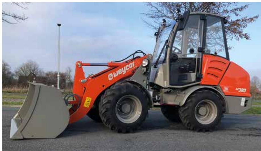
Der neue Weycor AR 380 hat eine seitlich klappbare Kabine, die den Service erleichtert. (Foto: Weycor)
