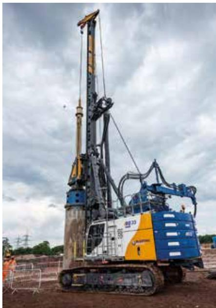
**Echte Alternative:** Das elektrische Bauer-Bohrgerät eBG 33 zeigt im Testeinsatz gleiche Leistungsdaten wie die konventionelle Maschine bei deutlich verringertem CO<sub>2</sub>-Ausstoß und reduzierten die Lärmemissionen. (Foto: HS2)
