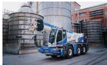
Die neue Variante des LTC 1050-3.1 ist mit einem zusätzlichen elektrischen Antrieb für die Kranfunktionen ausgestattet.
