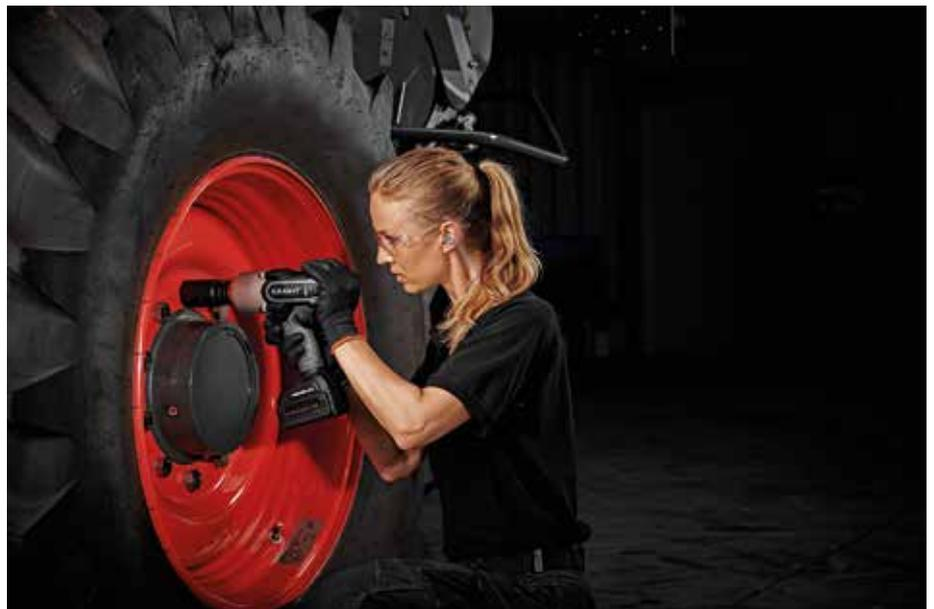
**Leistungsstark:** Die 18 V Akku-Schlagschrauber der Granit Black Edition sind mit Brushless Motoren ausgestattet, die mehr Ausdauer und eine längere Lebensdauer versprechen. (Foto: Granit Parts)
