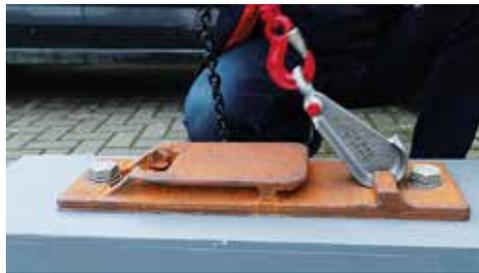
**Einfache Handhabung:** Einfädeln des Weichenschwellenhaken zur Verbesserung des Arbeitsschutzes bei Gleisbauarbeiten (l.) und Position der Vorrichtung beim Hebevorgang (r.) (Fotos: Georg Kappenberg)
