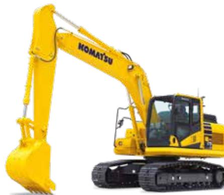
Der Hydraulikbagger PC170LC-11 erfüllt die Abgasnorm EU Stufe V und bietet den Kunden viele auf sie zugeschnittene Sonderausrüstungen. (Fotos: Komatsu)
