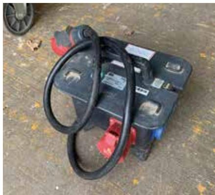
**Abb. 2:** Gummi-Verteiler ohne RCD sind nun definitiv zulässig. Diese dürfen dann an einer Baustromanlage nach einem RCD Typ B mit 30 mA betrieben werden – ein entsprechender Hinweis sollte dann auf dem Gummi-Verteiler angebracht sein.
