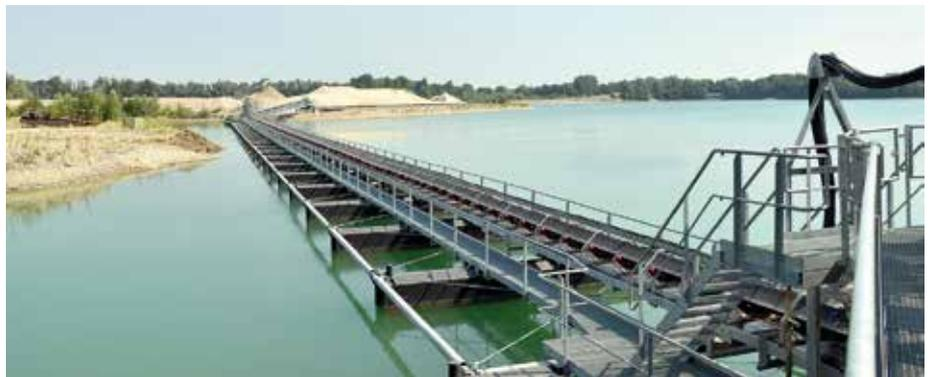
**Trotzt Wind und Wetter:** Die Modulbauweise des Schwimmbandes sorgt mit seiner flachen Bauweise für maximale Stabilität im Betrieb. (Foto: Moerschen)
