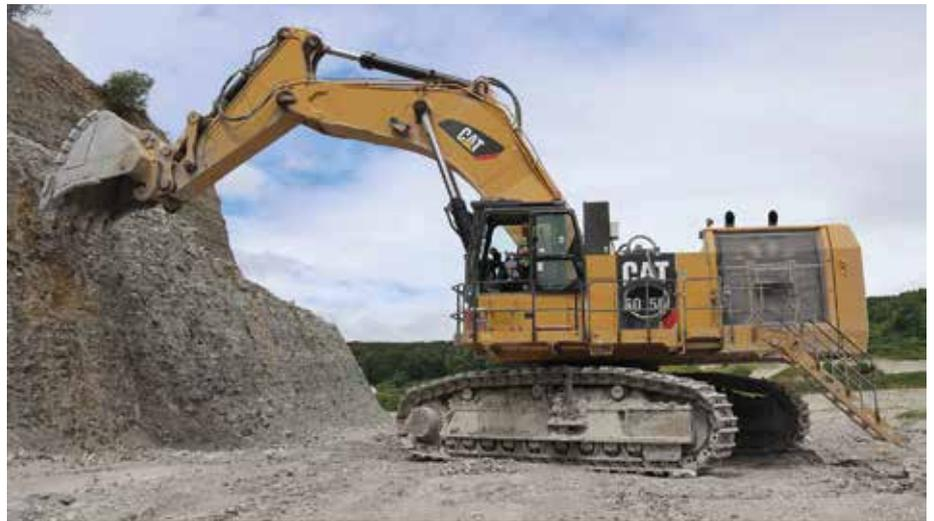
**Ausgelastet:** Der Cat 6015B im Steinbruch Hohne muss für genügend Nachschub an Rohmaterial für das angrenzende Zementwerk sorgen. Dort werden jährlich rund 1,8 Mio. t hergestellt. (Fotos: Caterpillar/Zeppelin)
