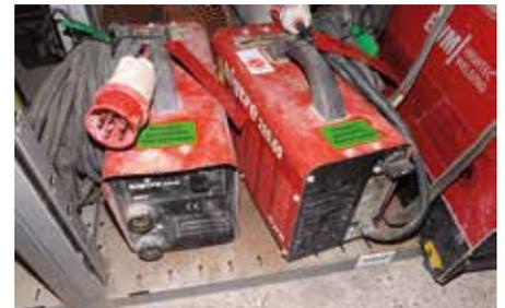
**Abb. 3:** Frequenzgeführte Betriebsmittel können auch Schweißgeräte sein. Diese Inverter-Schweißgeräte gehören dazu und sind entsprechend zu kennzeichnen.
