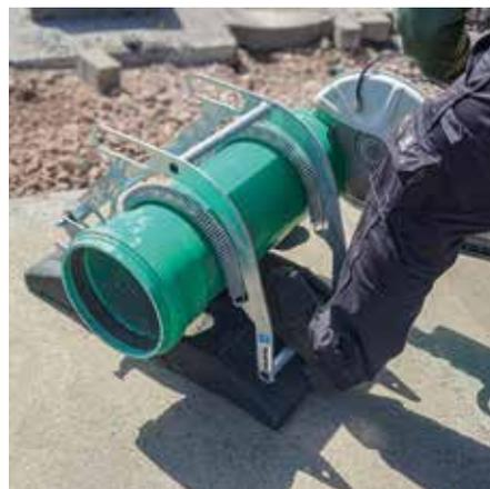
**Gesteigerte Sicherheit:** Dank der Klemmvorrichtung KV-250 von Tibatek soll die Verletzungsgefahr beim Schneiden von Rohren minimiert werden. (Foto: Tibatek)
