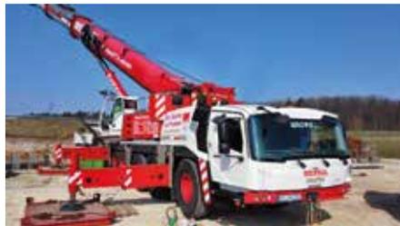
**Schnelle Arbeit:** Die beiden All-Terrain-Krane erledigten den Einbau sämtlicher Betonträger auch unter Einsatz von Tandemhüben während eines einzigen Tages.
