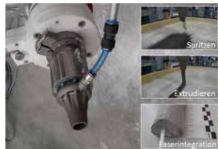
Dank der Spritz-Extrusion-Faserintegration-Multitooldüse können mehrere Prozessschritte ohne Werkzeugwechsel umgesetzt werden. (Foto: TU Chemnitz)
