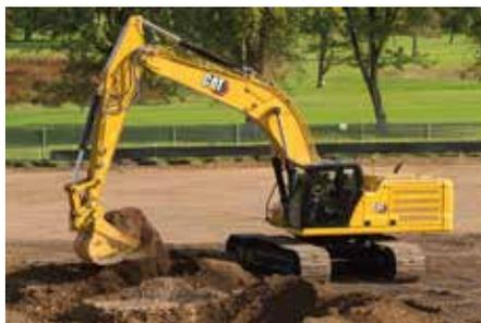
**Mächtige Werte:** Mit rund 40 t Einsatzgewicht und 258 kW Motorleistung erreicht der neue Cat 340 7,2 m Grabtiefe und 10,9 m Reichweite. (Foto: Caterpillar)
