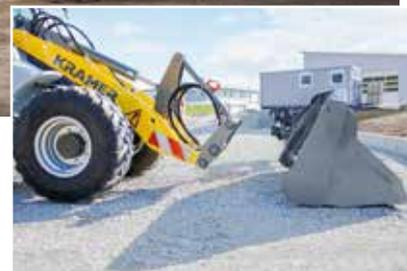
Kramer stellt das patentierte vollhydraulische Schnellwechselsystem „Smart Attach“ vor.
