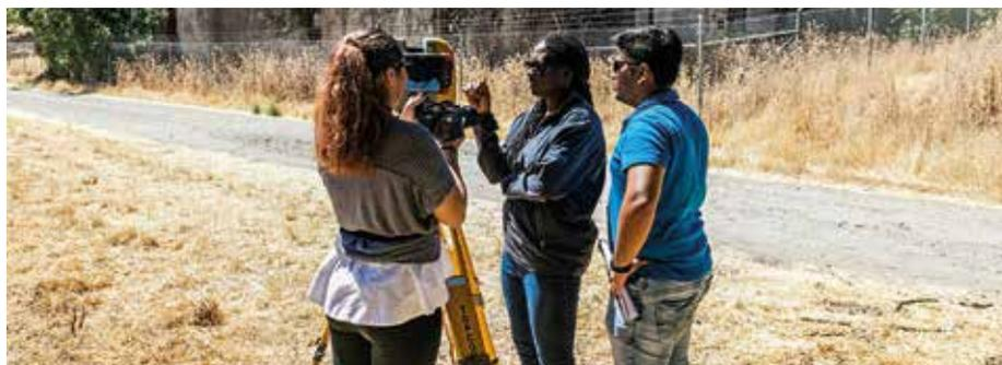
Der Topcon GLS-200 3D-Laserscanner wird genutzt, um ein digitales Abbild eines historischen Gebäudes zu erstellen. (Foto: Topcon)
