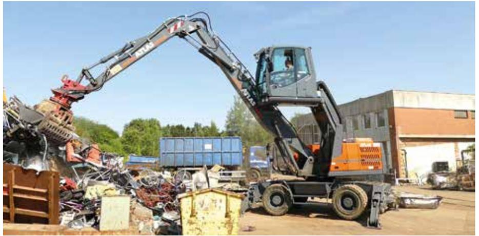
**Kraftvoll und präzise:** Die 19 t Umschlagmaschine Atlas 180 MH im Einsatz beim Recyclingspezialisten Trillhoff. (Foto: Atlas)
