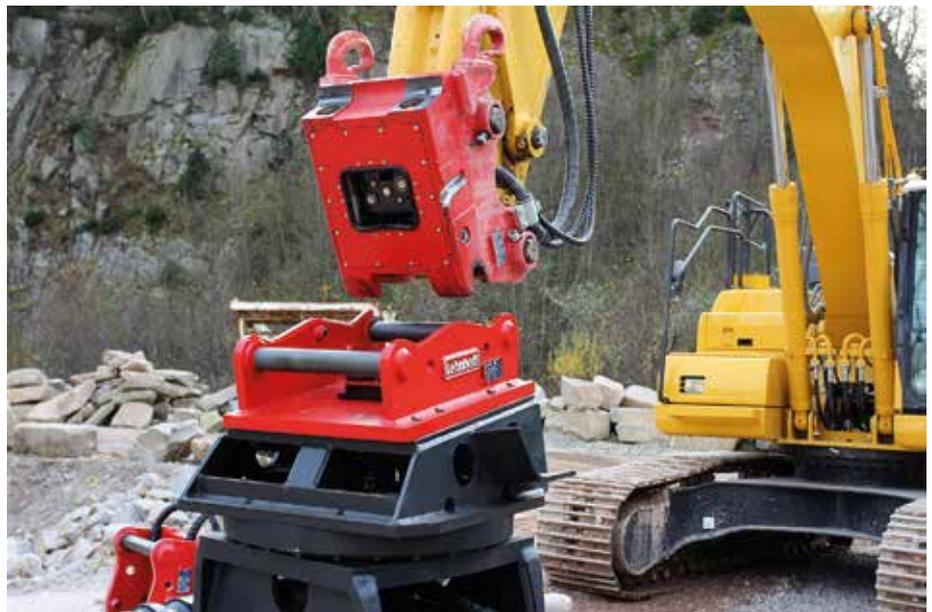
Lehnhoffs Vollhydraulischer SQ70 an einem 21 t-Bagger mit im Gehäuse integrierter Ventiltechnik.
