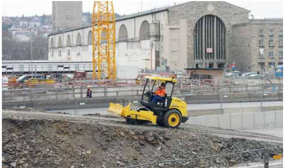
**Der kompakte Walzenzug** überzeugt durch Steigfähigkeit und Geländegängigkeit sowie die flexible Verdichtungsleistung mit zwei Amplituden. (Foto: Bomag)
