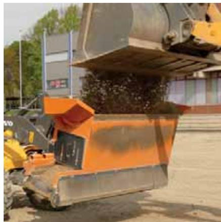
**Die Finliner** kann 1 m<sup>3</sup> Material selbst aufnehmen oder von einem anderen Radlader beladen werden.
