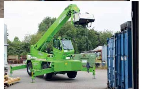
**Kranarbeiten** lassen sich wahlweise mit Diesel oder elektrisch ausführen.
