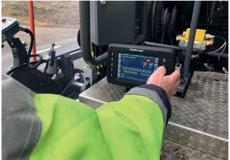
**Das System MatManagerTM** unterstützt Straßenbauunternehmen in der Optimierung ihres Einbauprozesses, der Prozesskontrolle und in der Prozessdokumentation. (Foto: Dynapac)
