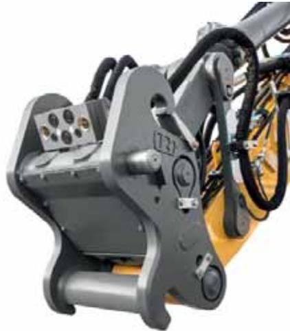
*Der zweite Näherungssensor erhöht die Sicherheit beim hydraulischen Schnellwechsler. (Fotos: Liebherr)*
