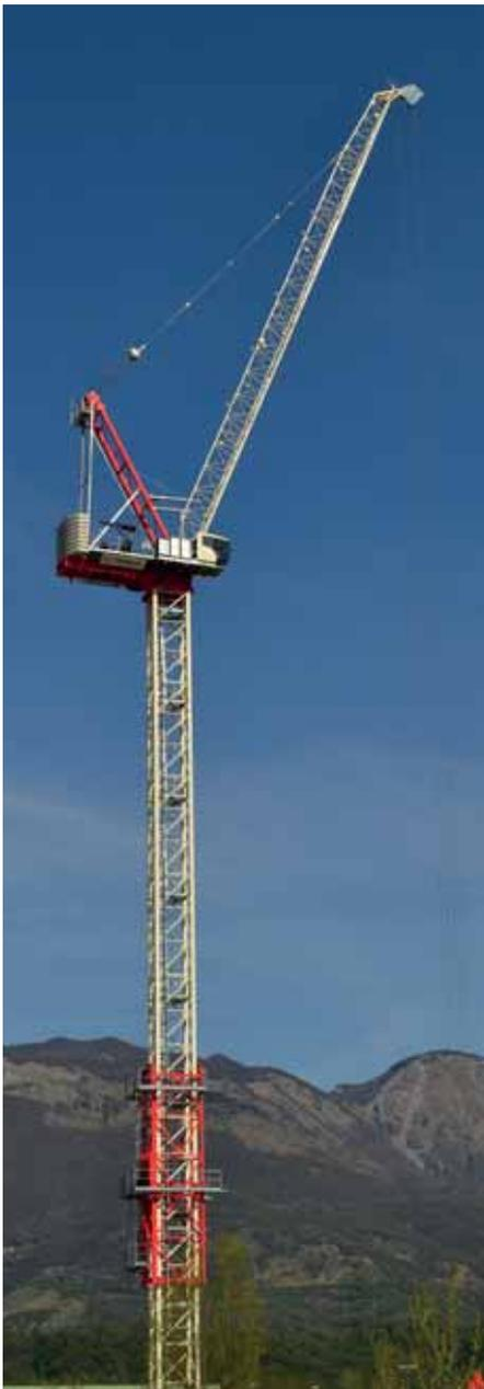
**Der neue Wippauslegerkran** bietet eine Auslegerlänge von 61 m, ein Lastmoment von 270 mt und auf voller Auslegerlänge eine Tragfähigkeit von 2,6 t. (Fotos: Terex)
