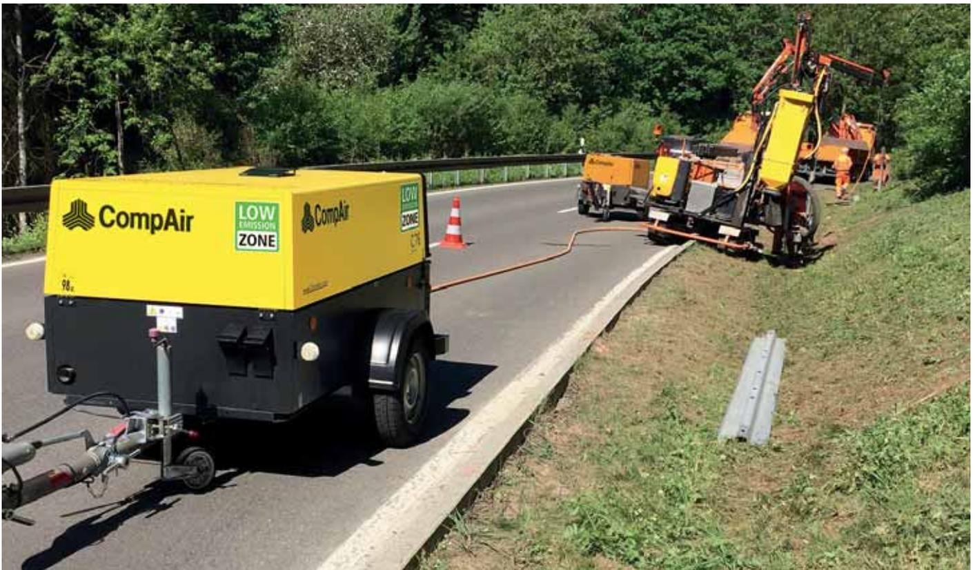
Der mobile Kompressor folgt dem Bohrgerät und gewährleistet eine kontinuierliche Druckluftversorgung. (Foto: CompAir)
