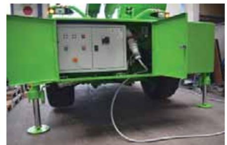
**Front des Roto** mit zusätzlichem E-Antrieb.
