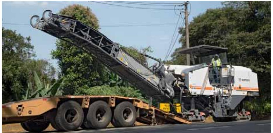
*Das anwendungsgerechte Eigengewicht und nach Bedarf einsetzbare Zusatzgewichte erlauben die Beförderung der W 200 auch auf Fahrzeugen mit geringem maximal zulässigem Beladungsgewicht.*
