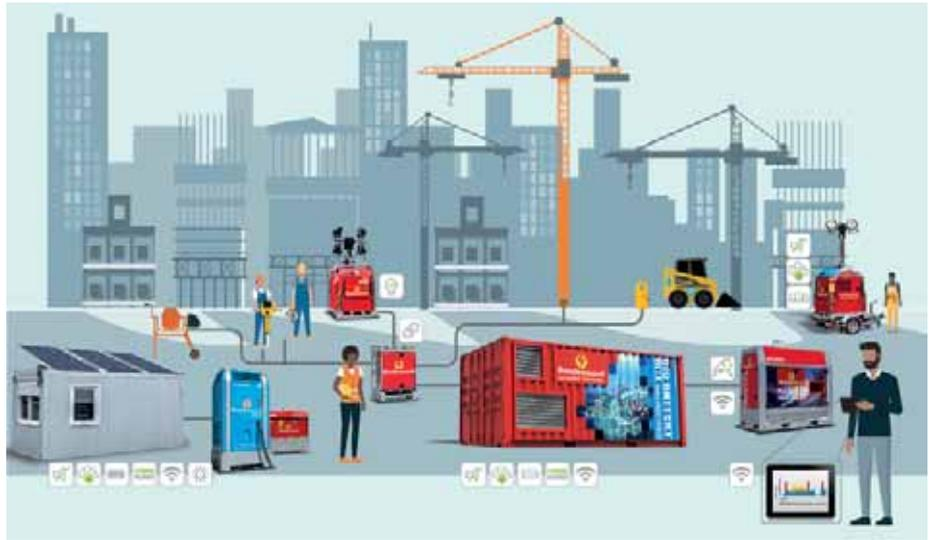
**Die hybride Baustelle der Zukunft** kann dank fortschrittlicher Stromspeichertechnik bei Tag und Nacht überwiegend geräusch- und abgasarm betrieben werden. Bei Versorgungsengpässen werden kraftstoffbetriebene Aggregate hinzugeschaltet. (Infografiken: Bredenoord)
