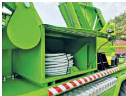
**Hinter der Kabine:** Box für 50 m Anschlusskabel.
