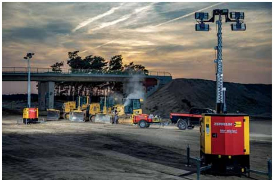
**Bei den neuen Hybrid-Lichtmasten** ist ein geräuschloser zehnstündiger Akku-Betrieb möglich. Der Verbrennungsmotor springt nur an, wenn der Akku nachgeladen werden muss. (Foto: Zeppelin Rental)
