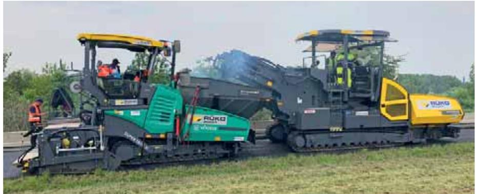
Ein Beschicker von Dynapac und ein werksneuer Vögele-Fertiger, beide aus dem Rüko-Mietpark, sorgten für einen schnellen und reibungslosen Asphaltbau. (Foto: Rüko)
