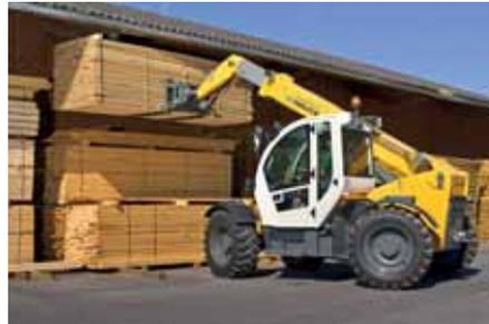
**Zwei auf einen hybriden** und einen vollelektrischen Antrieb umgerüstete Teleskoplader demonstrieren die Leistungsfähigkeit der E-Antriebe live im Einsatz.
