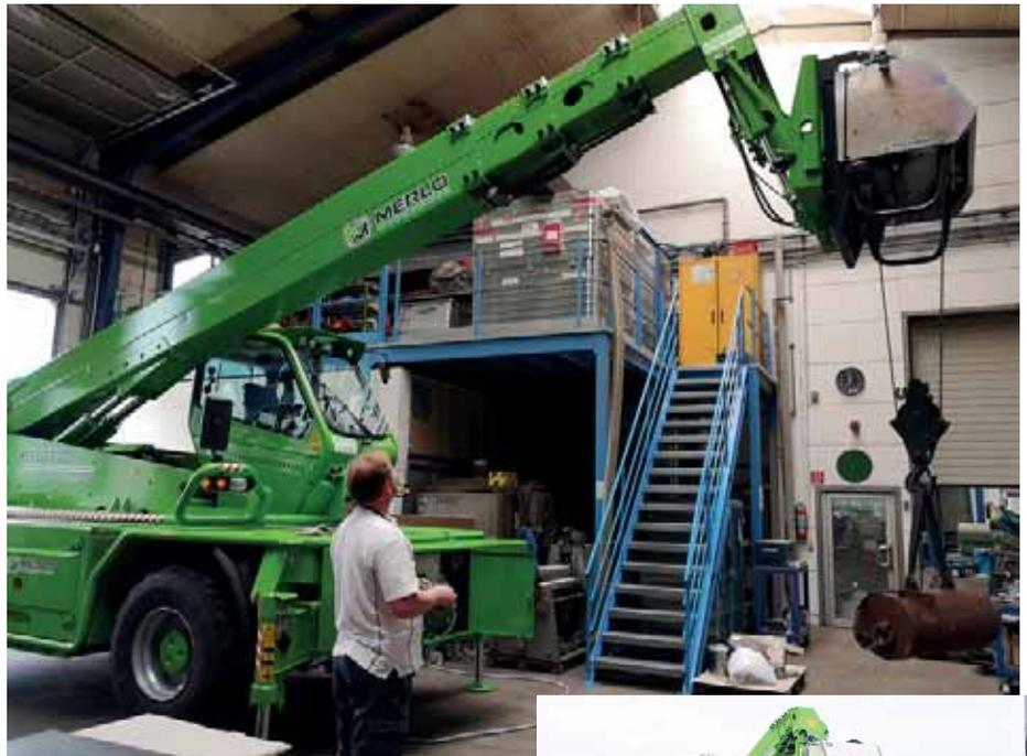
**Halleneinsatz:** Merlo Roto mit Plug-In E-Antrieb. (Fotos: Merlo)
