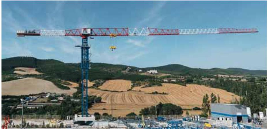
**Der 21LC1050** verfügt über eine maximale Ausladung von 80 m und ein neues Design des Gegenauslegers mit sechs verschiedenen Konfigurationsmöglichkeiten. (Fotos: Comansa)
