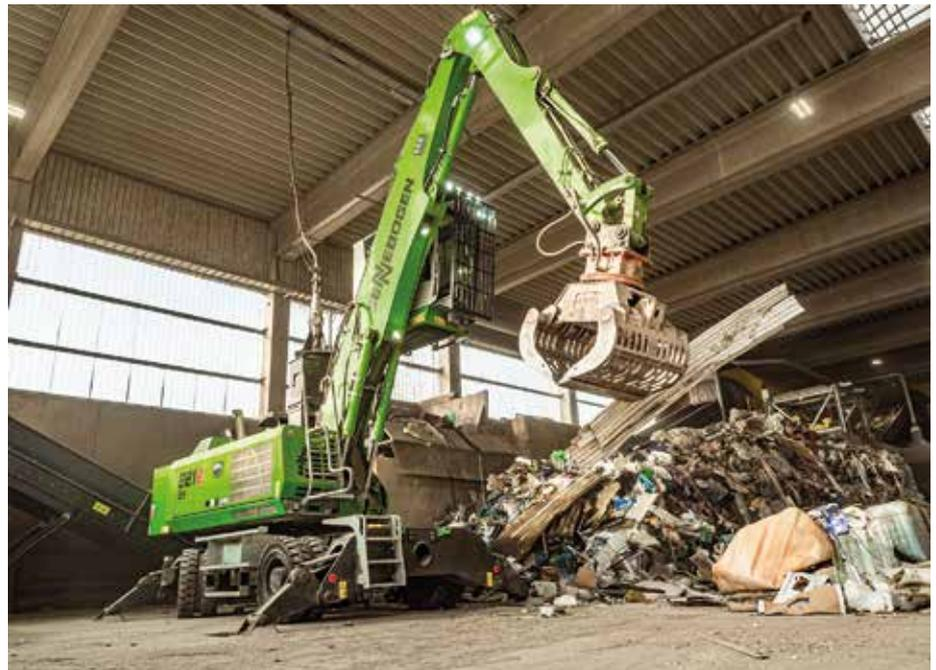
**Umschlagbagger in der Elektroversion:** Der Sennebogen 821 E erhält Deckenstromversorgung. Ein 19 kW Diesel Powerpack, das den Heckballast ersetzt, ermöglicht Kurzstreckenmobilität. (Foto: Wolfgang Kröll)
