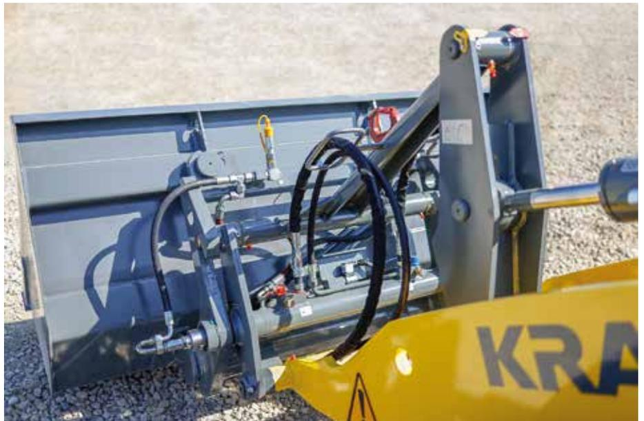
**Einfache Handhabung:** Mit dem vollhydraulischen Schnellwechselsystem „Smart Attach“ lassen sich hydraulisch angetriebene Anbaugeräte ohne Aus- und Einsteigen koppeln. (Foto: Kramer)
