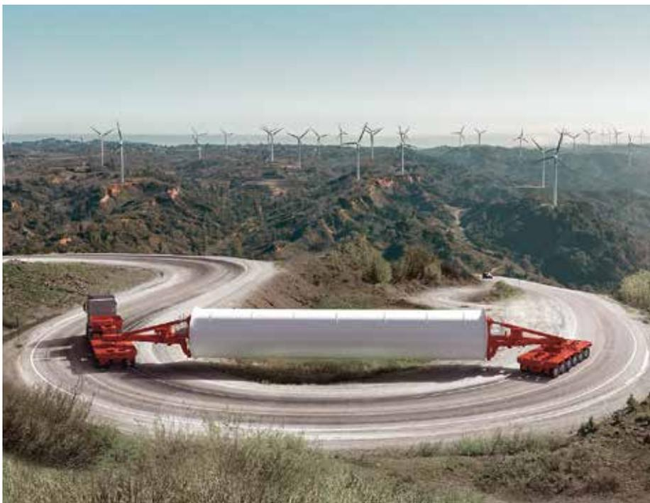
**Kriegt die Kurve:** Der modulare Plattformwagen K25 L von Scheuerle wurde für die Transportanforderungen der Windkraftindustrie optimiert. (Foto: Scheuerle)
