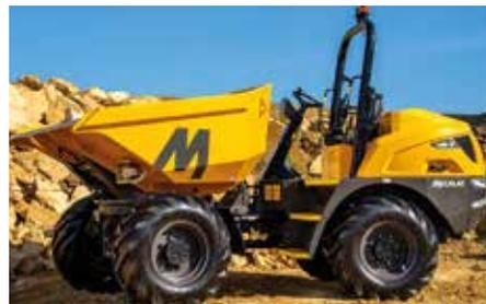
**Weiterentwicklung:** Mecalac hat angekündigt, seine Kippermodelle 6MDX und 9MDX optional mit einem hydrostatischen Antrieb und einem klappbaren ROPS-Überrollbügel auszustatten. (Foto: Mecalac)
