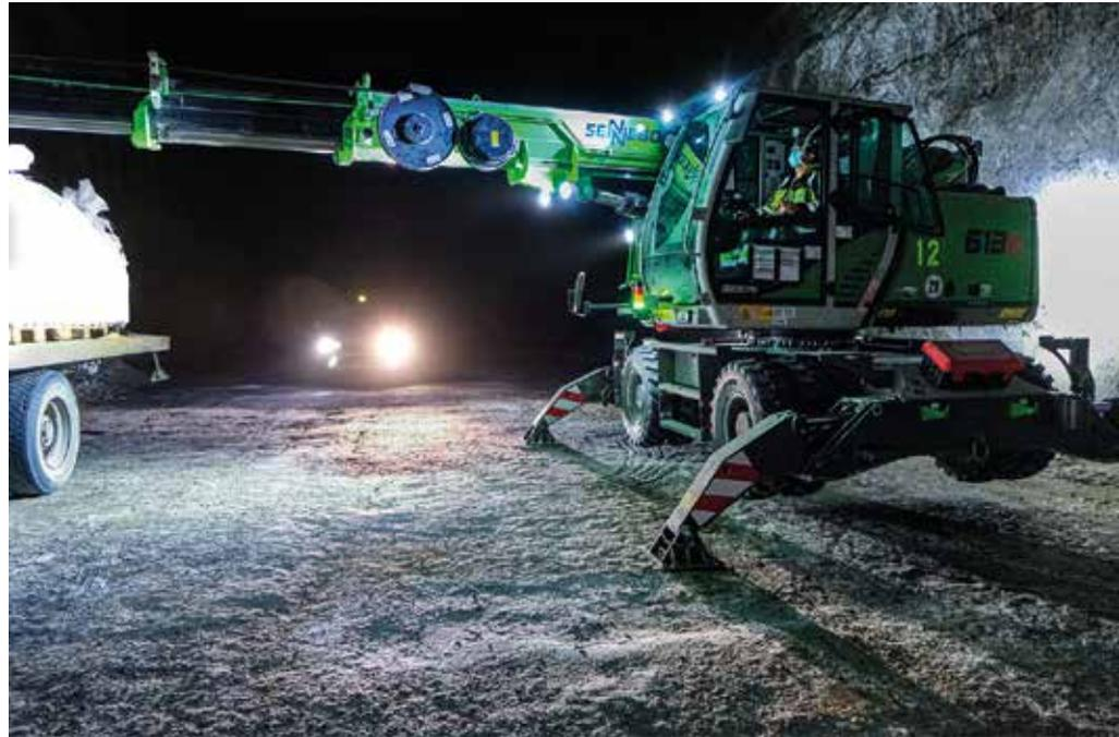
**Wenig Platzbedarf:** Der 613 Mobil Teleskopkran ist der Enge im Steinsalzbergwerk Heilbronn angepasst. (Foto: Südwestdeutsche Salzwerke AG)
