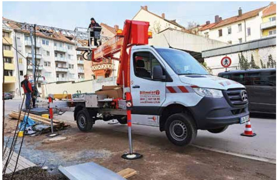
**Schnell verfügbar:** Die Lkw-Hubarbeitsbühne P 280 B von Palfinger bietet eine Arbeitshöhe von bis zu 27,6 m und ist im Handumdrehen einsatzbereit. (Foto: Palfinger GmbH)
