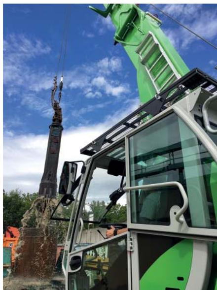
**Brunnenbohrung in einem Kieswerk** südlich von Straßburg (Bas-Rhin). Mit einer Verrohrungsmaschine ausgestattet, ist der 624 E eine kompakte und leistungsstarke Maschine.
