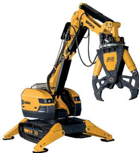
**Flaggschiff:** Der Brokk 520D – hier mit CC700 Betonzange – setzt einen neuen Standard für dieselbetriebene Abbruchroboter. Die 5-Tonnen-Maschine erfüllt mit Euro 4-Dieselmotor (Fabrikat Kohler) die neuen EU-Abgasnormen.
