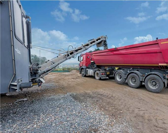
**Das schwenkbare Abwurfband** der Kaltrecycling-Mischanlage ermöglicht die vollständige Befüllung der Lkw und einen reibungslosen Abtransport – selbst unter Vollast.
