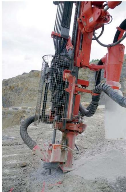
**Durchdacht bis in Detail:** Der Schutzkäfig um die Bohrlafette bringt ein hohes Maß an passiver Sicherheit, die heute unerlässliches Merkmal einer modernen Maschine ist.
