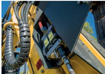
**Die abschließbare Abdeckung** bietet Schutz vor Schmutz und Schäden.
