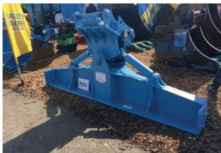
Der Abziehbalken ist ein Anbaugerät für Bagger jeder Gewichtsklasse. Seinen Einsatz findet er beim Abziehen und Planieren von kleineren bis mittelgroßen Flächen. (Foto: HS-Schoch)
