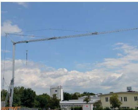
Der stationäre 41-m-Schnellmontagekran CM 90S4 aus dem BKL-System Cattaneo hebt bis zu 4 t und punktet mit besonders hoher Umschlagleistung. (Foto: BKL)
