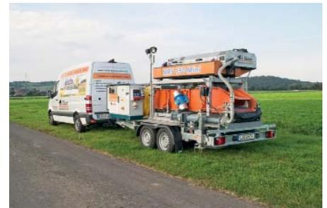
*Sehr flexibel und handlich: die kleinste und kompakteste Lösung des Modulare Recycling Systems, das „MRS 150 Mini Trailer“, auf einem Autoanhänger in Kombination mit einem Sprinter und einem darin eingebauten Stromaggregat. (Foto: L-Team)*
