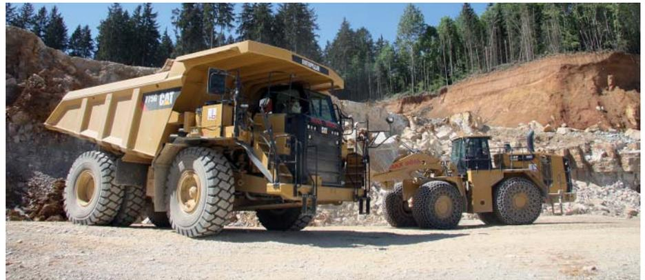
**Die Beladung erfolgt mit einem Radlader 988K.** Vier Ladespiele sind nötig, um die knapp 42 m<sup>3</sup> Muldenvolumen der 775G auszuschöpfen und deren 65 t Nutzlast zu erreichen.
