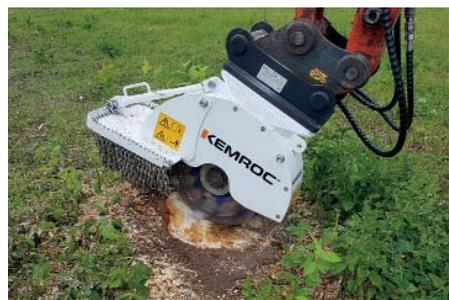
Baumstüben fräsen mit dem KST 20 – Anbaufräsen von Kemroc erhöhen die Einsatzvielfalt und Auslastung von Baggern. (Foto: Kemroc)
