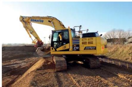
Der intelligente Bagger PC210LCi hat eine ab Werk integrierte Maschinensteuerung. Er führt grobe Aushübe und präzise Feinarbeiten automatisch in nur einem Durchgang aus. (Foto: GP Günter Papenburg)
