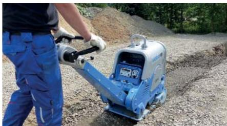
Mit WEtrac bietet Weber MT ein Telematik-System für Bodenverdichter zwischen 400 und 750 kg Betriebsgewicht an. (Foto: Weber MT)
