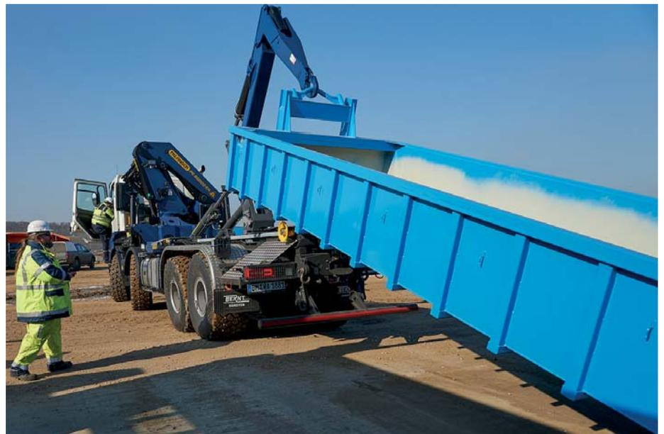
**Mit der Funkfernsteuerung** wird der Abrollbehälter flach auf das Fahrzeug aufgezogen. (Foto: Palfinger)
