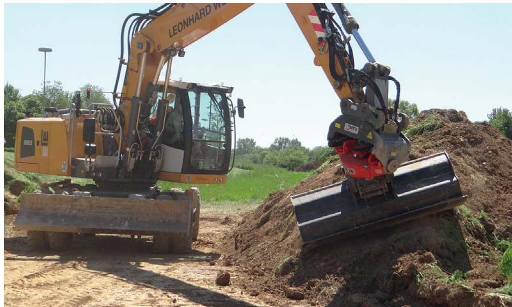
**Flexibles Handgelenk am Baggerarm:** Der MTS-Tiltrotator punktet als robuste Sandwich-Lösung mit niedriger Bauhöhe und innenliegenden Zylindern. Und jetzt auch mit einer Schnittstelle zur Liebherr-Steuerung. (Foto: MTS)
