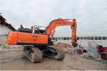
**Schneller Anbaugerätewechsel** zwischen Schrottschere und Sortiergreifer dank OilQuick. Fotos: Kiesel)
