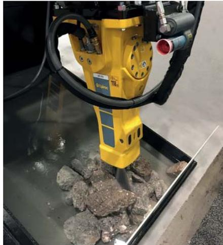
**Hydraulikhämmer der SB-Serie** verfügen branchenweit als einzige standardmäßig über eine integrierte Wasserbedüsung. (Foto: Epiroc)
