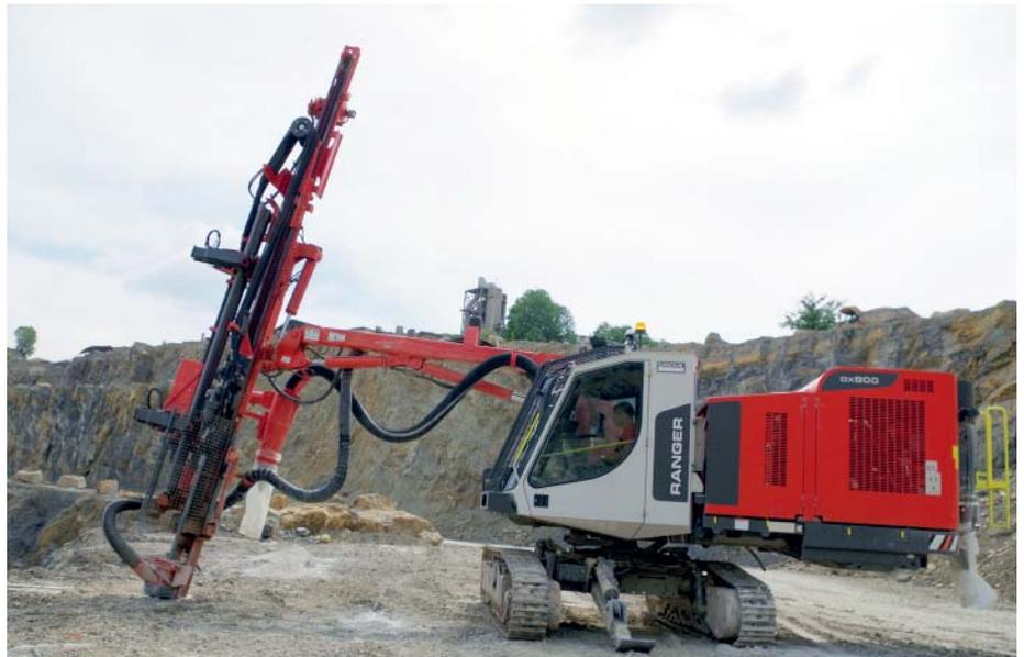
**Das wichtigste auf einen Blick:** Neben dem drehbaren Oberwagen zeichnet sich der Ranger DX800 mit Stahllafette und Knickbohrarm unter anderem durch die optionale Stütze sowie die Sichtverhältnisse aus der großzügigen Kabine aus. (Fotos: Sandvik)
