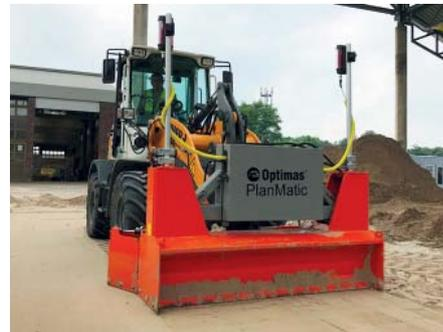
Das vollautomatische Planiergerät PlanMatic ist lieferbar in den Grundbreiten 1,40 m und 2 m. Optional lassen sich die Arbeitsbereiche um bis zu 1,20 m vergrößern. (Foto: Optimas)
