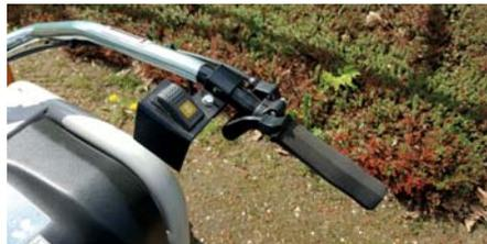
*Da die Anwenderin in ihrer Handmotorik eingeschränkt ist, hat man die Lenkung des Minidumpers 1005 E modifiziert: Geschwindigkeitsregulierung mittels Daumengas und Fahrtrichtungswahl per Schalter.*
