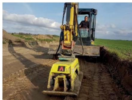
**Durch seine universelle Adapterplatte** kann man den APA 5546 leicht an alle marktüblichen Schnellwechselsysteme montieren.
