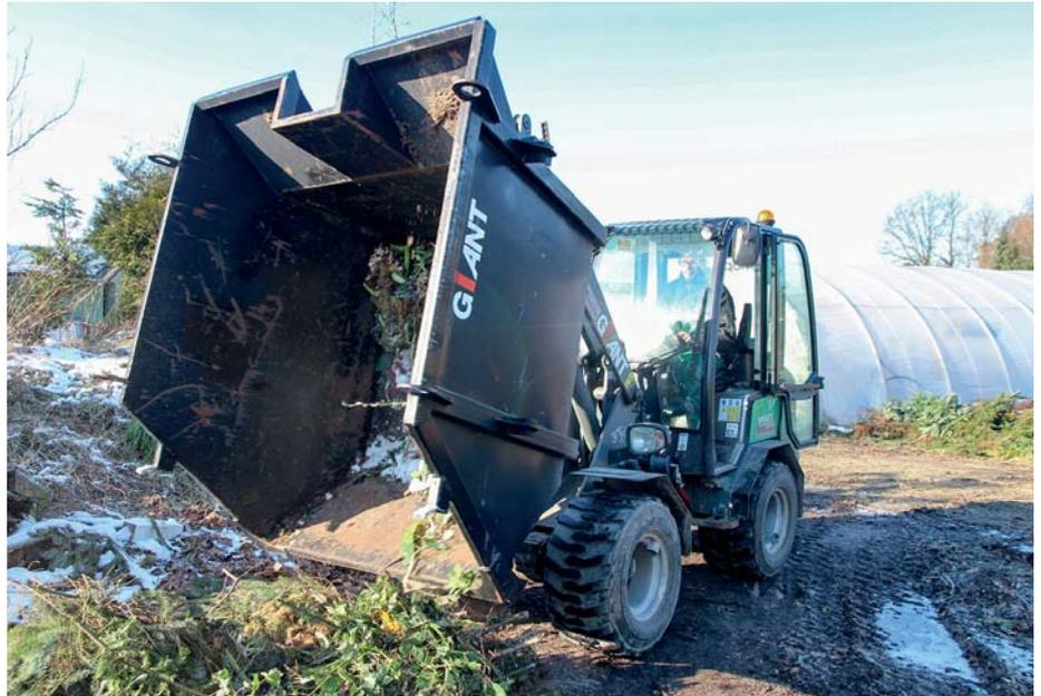
*Der Giant in der Firmenfarbe von Westermann: Das Besondere ist der Spezial-Container, in dem Gartenabfälle gesammelt und transportiert werden können. (Fotos: Kiesel)*
