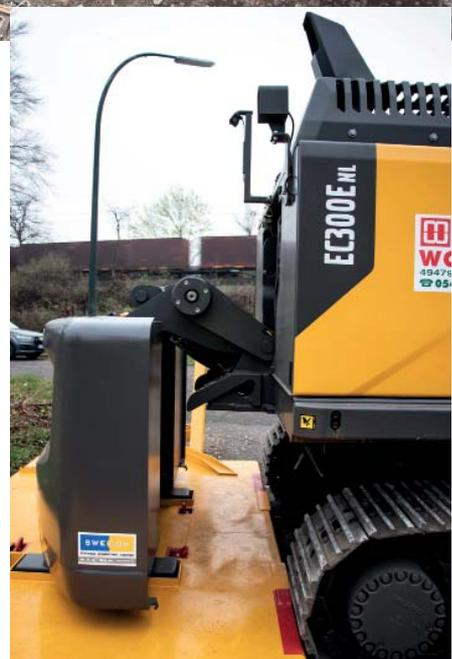
**Durch das hydraulisch absetzbare** Kontergewicht hält der Abbruchbagger das geforderte maximale Transportgewicht ein.
