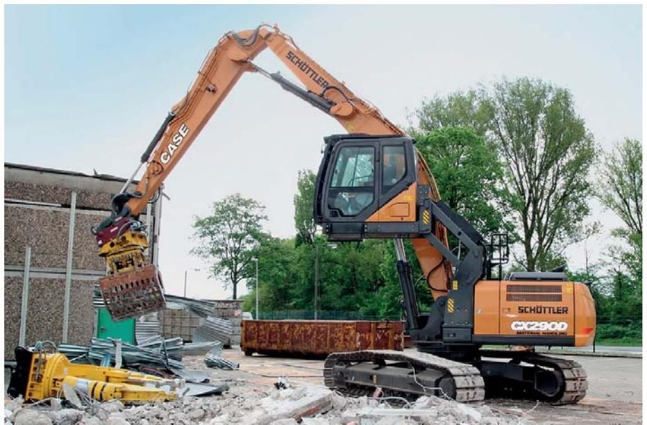
**Überragende Arbeitsgeschwindigkeit:** Der neue CX290D MH überzeugt im Rückbau. Dank Oil-quick-Wechsler lässt sich eine Vielzahl verschiedener Anbaugeräte einsetzen. (Fotos: Case CE)
