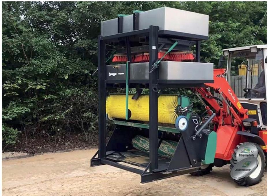
Die Füllstation dient gleichzeitig als Transportregal für das Einkehrgerät. (Fotos Raquatec)
