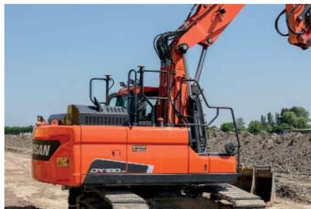
Zwei Antennen kann man von der Topcon-Technologie am Bagger auf den ersten Blick erkennen. Eine Steuerbox ist unsichtbar verbaut und auch die Sensoren zur Niveaumessung sind kaum erkennbar.
