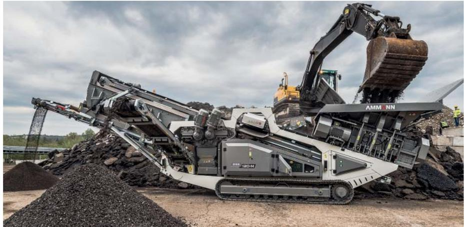
**In 30 Minuten einsatzbereit:** Mit ihrem Raupenfahrwerk meistert die neue Recyclinganlage auch schwieriges Terrain. (Foto: Ammann)
