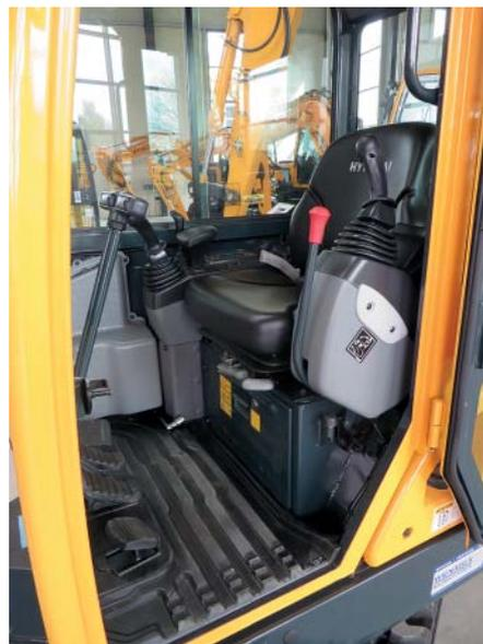
**Neue Proportionalsteuerung:** Mit zwei Joysticks ist die Maschine wesentlich präziser und einfacher zu handhaben.
