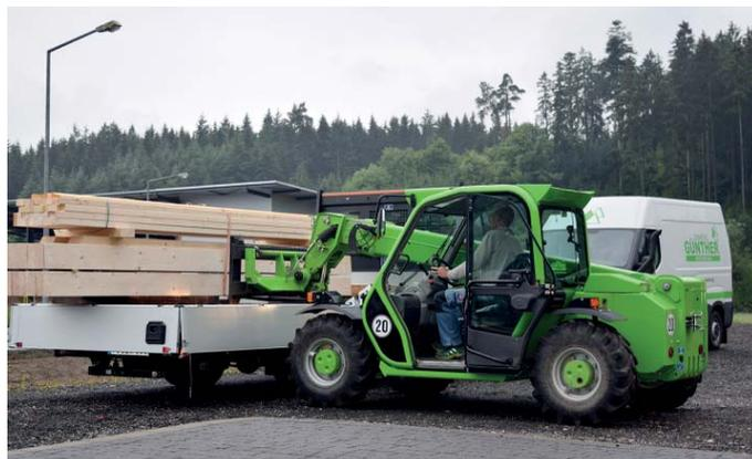
Der kompakte Teleskop 25.6 mit 1.920 mm Bauhöhe, 2,5 t Hubkraft und 6 m Hubhöhe bewährt sich als wendiger Stapler und Lader. (Foto: Merlo Deutschland)
