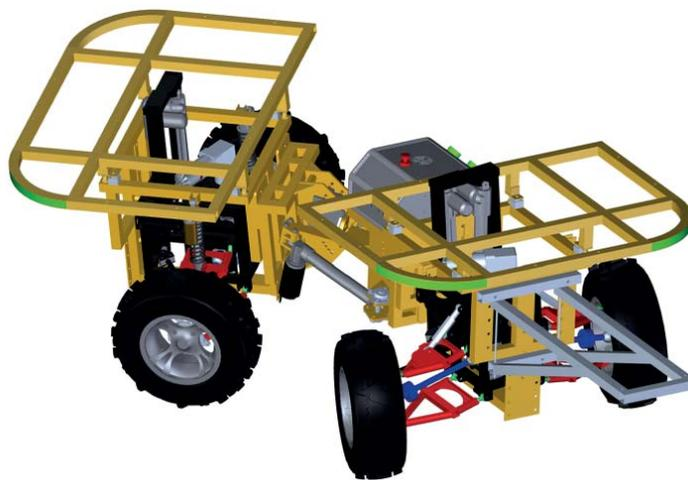
3D Modell des universellen elektrogetriebenen Radfahrzeugs (Bild: TU Wroclaw)
