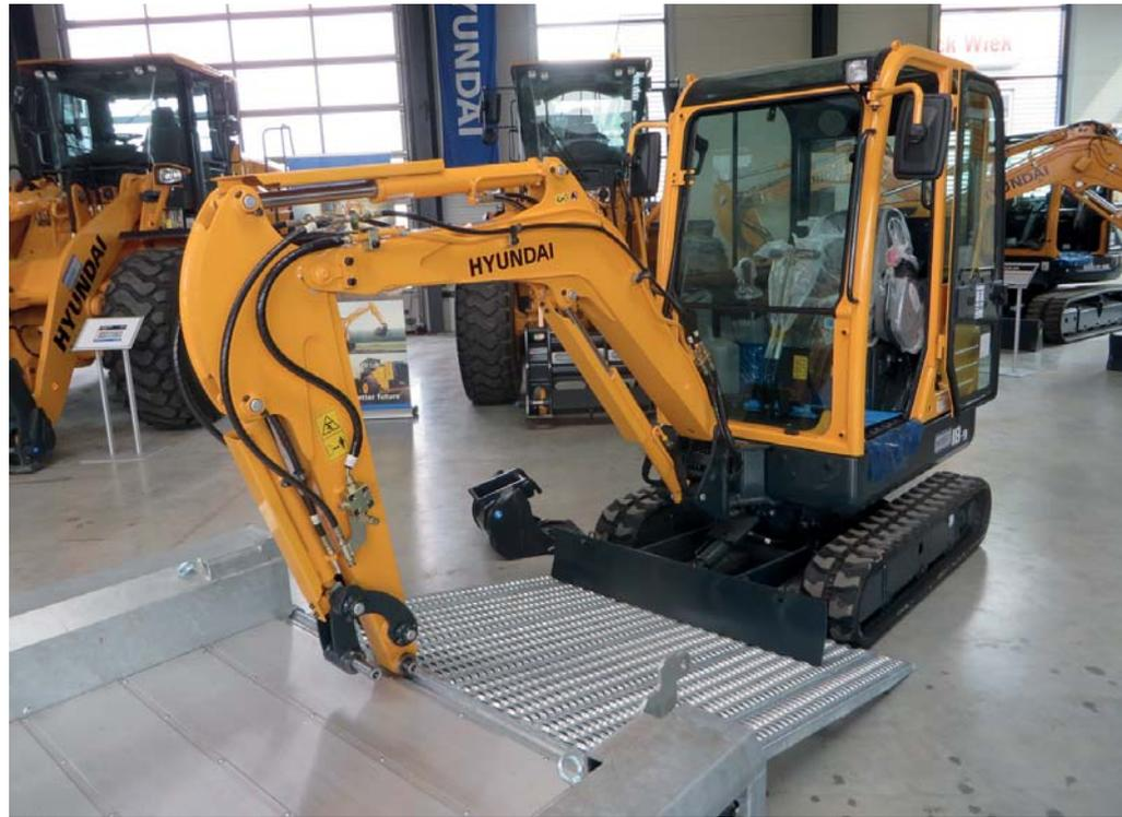
**Teleskopierbares Fahrwerk:** Die Gesamtbreite variiert zwischen 980 mm und 1250 mm. Das höhere Betriebsgewicht von 1995 kg sorgt für noch mehr Standfestigkeit. (Fotos: Wienäber Baumaschinen)
