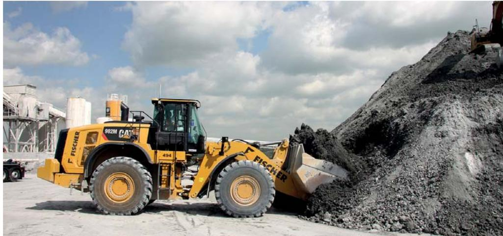
Das Material nehmen die Radlader mit einer speziell entwickelten Schaufel auf. (Fotos: Zeppelin)
