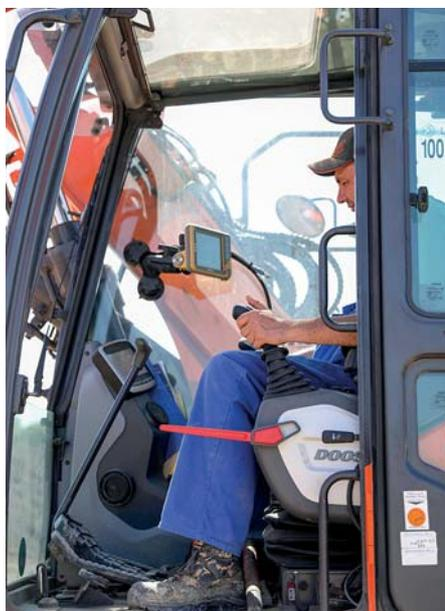
Über den LED-Bildschirm erkennt der Maschinenführer, an welcher Stelle er in welchem Niveau und in welcher Geschwindigkeit ausschachten muss.
