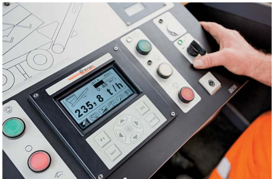
Auf dem übersichtlichen Bedienpanel in der Kabine sieht der Bediener Volkmar Gogol die aktuelle Mischleistung – hier waren es 235 t/h. Damit sind typische Tagesleistungen von 2.000 t in 10 Stunden kein Problem.
