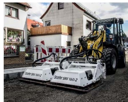
Die Vibrationsplatten lassen sich innerhalb weniger Minuten mit geringstem Arbeits- und Kraftaufwand an das Trägergerät an- und abbauen. (Foto: Stehr)
