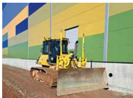
Alternative: Der Trimble MS976 bietet GNSS-Empfang, wo sonst nur mit Laser oder Totalstation gearbeitet werden kann. (Foto: Sitech)
