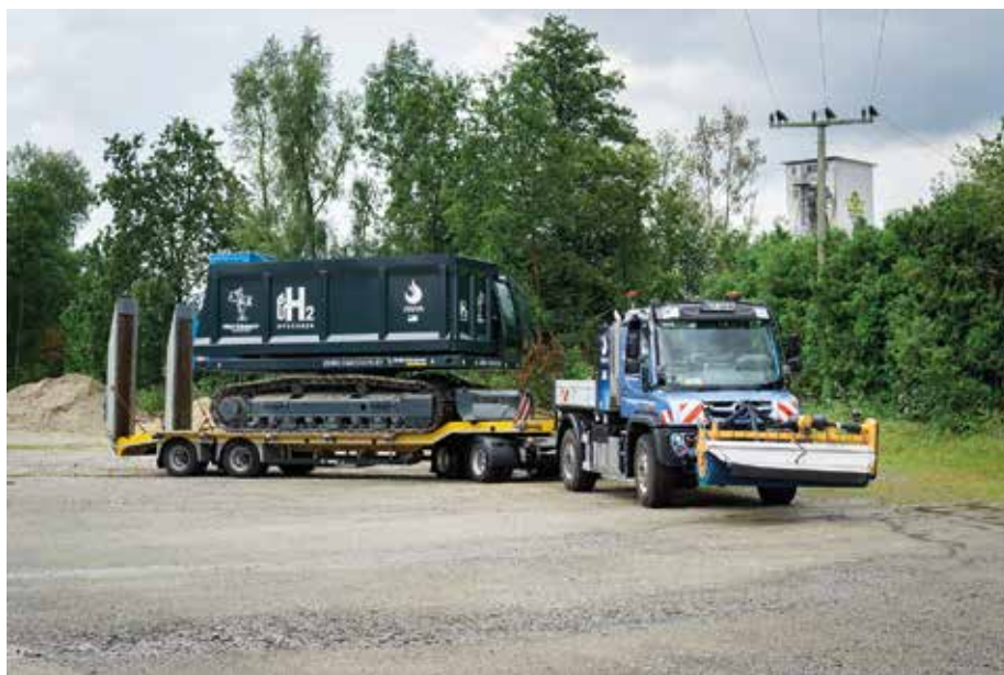
Starkes Gespann: Die Raupe und der Unimog, die Mörtlbauer und Daimler präsentiert haben, werden von Wasserstoffmotoren angetrieben. (Foto: Daimler)
