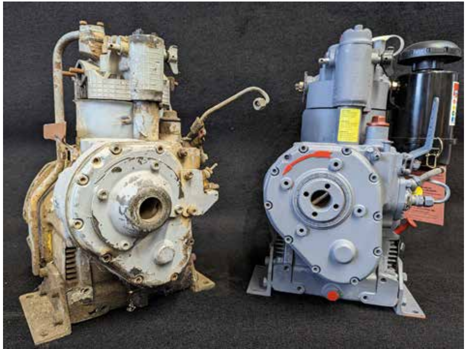
Aus alt mach neu: Hatz-Motor vor und nach der Instandsetzung durch die Friedrich Dicke GmbH & Co. KG. (Fotos: Friedrich Dicke GmbH)
