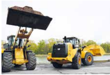
Viele Aufgaben: Radlader übernehmen bei AHV das Vormischen von Materialien, das Beschicken der Anlagen, das Abziehen von Böden und das Beladen von Lkw.
