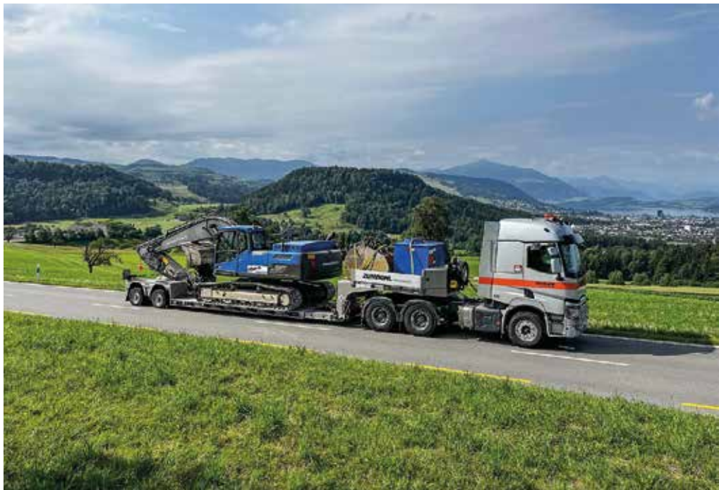
Gute Reise: Die Doll tera-Pendelachse ist mit einem Ladegewicht von 12 t pro Achse zugelassen, was grenzüberschreitende Transporte erleichtert. (Foto: Doll)
