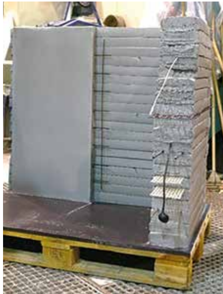
Kenner der Materie: Bereits seit zehn Jahren entwickelt die TU Dresden ein eigenes Beton-3D-Druckverfahren. Hier eine 3D-bedruckte Wandecke mit verschiedenen Bewehrungskonzepten. (Foto: TU Dresden)
