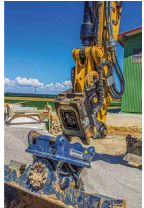
Temporeich: Der symmetrische Aufbau des Ventilblocks und der S-Standard der Doppelwellenaufnahme ermöglichen schnelle Anbaugerätewechsel
