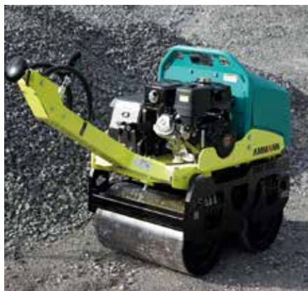
Effiziente Verdichtung: Das neue, überarbeitete Modell der handgeführten Walze von Ammann ARW 65-S ist lenkbar und lässt sich ohne Kraftaufwand führen. (Foto: Ammann)
