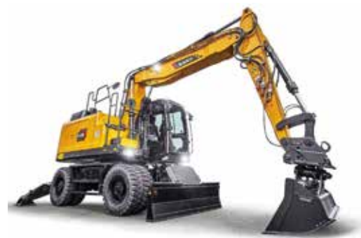
Vielseitige Maschine: Der Mobilbagger SY175W eignet sich für Erdarbeiten, Materialtransport oder präzise Ausgrabungsarbeiten. (Foto: Sany)
