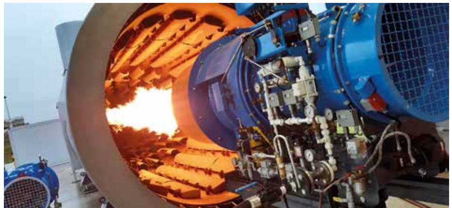
Hohe Uptime: Der Wechsel zwischen Brennstoffen oder Kombinationen mehrerer Brennstoffe erfolgt bei der neuen Brenner-Generation von Benninghoven fliegend. (Foto: Benninghoven)
