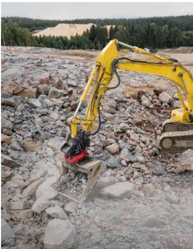
Rototilt präsentiert mit dem RC9 einen souveränen Schwenkrotator für Bagger zwischen 32 und 43 t. Mit dem bislang größten Modell des schwedischen Herstellers profitieren Bediener großer Maschinen von den Vorteilen der Schwenkrotator-Technik. Sie erhalten die Möglichkeit, einfach zwischen Aushub- und Präzisionsarbeiten zu wechseln und gleichzeitig die Anzahl der für einen Auftrag erforderlichen Maschinen und Zusatzgeräte zu verringern.
