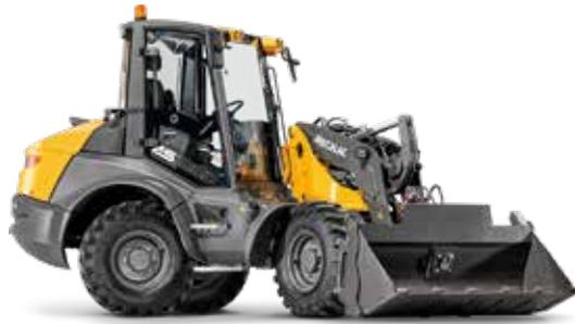
**Mit drei serienmäßigen Lenkmodi – Zweiradlenkung, Vierradlenkung, Hundegang – ist die Mobilität der Maschine optimal gewährleistet. (Foto: Mecalac)**
