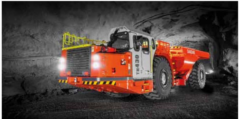
**Effizient:** Der Toro TH430 Muldenkipper ist mit dem Integrated Weighing System (IWS) für Trucks von Sandvik ausgestattet worden. IWS gewährleistet die volle Ausnutzung der Nutzlastkapazität des Trucks bei jedem Zyklus. (Foto: Sandvik)
