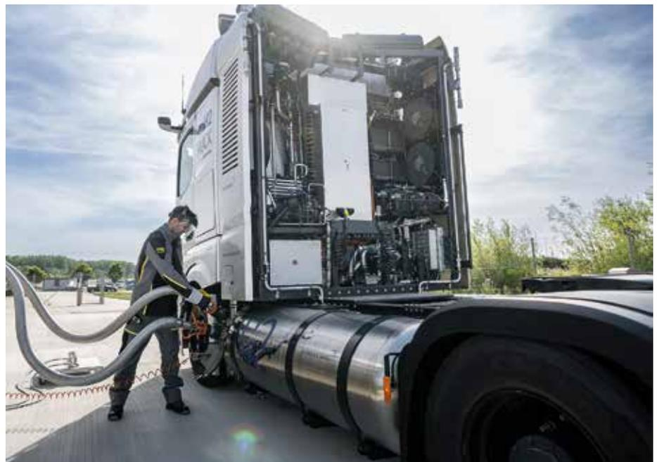
Daimler Truck testet Brennstoffzellen-Lkw mit Flüssigwasserstoff. (Foto: Daimler)
