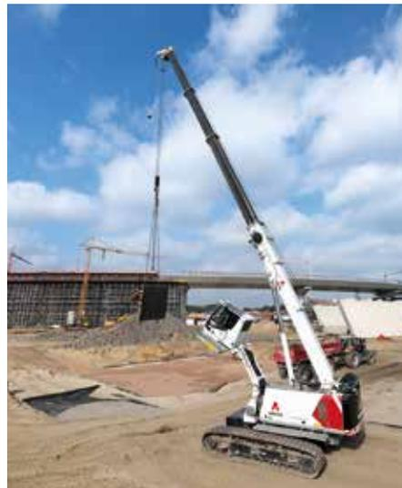
**Optimale Ergonomie:** Die hydraulisch um 2,70 m hochfahrbare und um 30° neigbare Komfortkabine ermöglicht maximal produktives und sicheres Arbeiten auf der Baustelle. (Foto: Sennebogen/Stefan Hanke)
