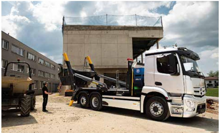
**Mercedes-Benz Trucks** hat die von ZF entwickelte All-in-One-Lösung eWorX zusammen mit einem Absetzkipper von Palfinger in einem eActros aufgebaut. (Foto: Daimler Trucks)
