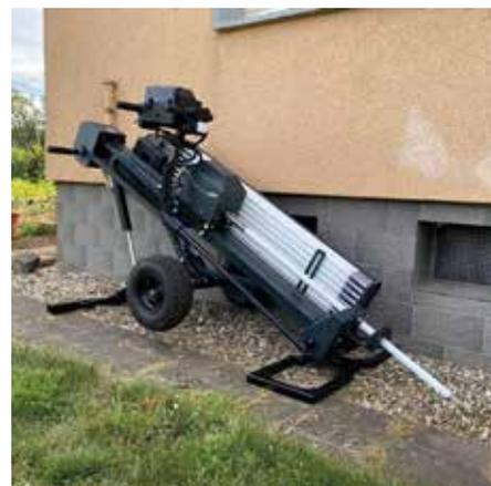
*Emissionsfrei: Drill-Vole ist die erste akkubetriebene Horizontalbohranlage für Bohrungen im Hausanschlussbereich.
