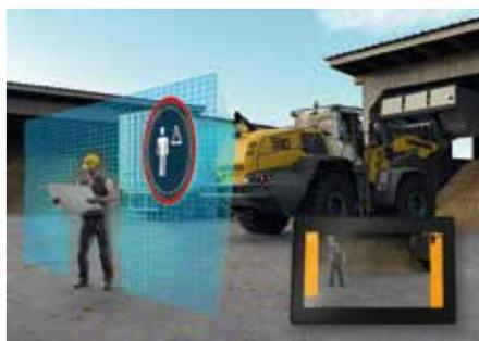
*Sicherheit gesteigert: Der Bremsassistent von Liebherr verzögert automatisch die Geschwindigkeit des Radladers, sobald die aktive Personenerkennung eine Gefahrenquelle im Heckbereich identifiziert.
