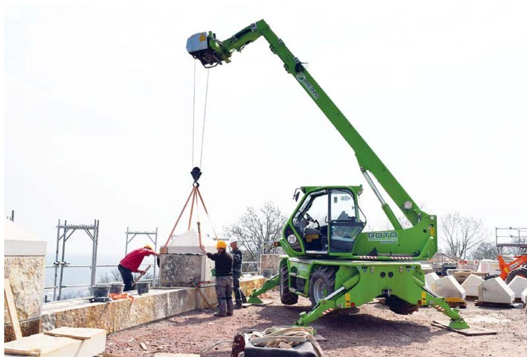
**Im Kraneinsatz beim Kaiser-Wilhelm-Denkmal:** der Roto 38.16 mit 415° drehbarem Oberwagen und Winde. Dank der serienmäßigen Funkfernsteuerung kann er nahe an die Brüstung heran und die Stücke millimetergenau absetzen.
