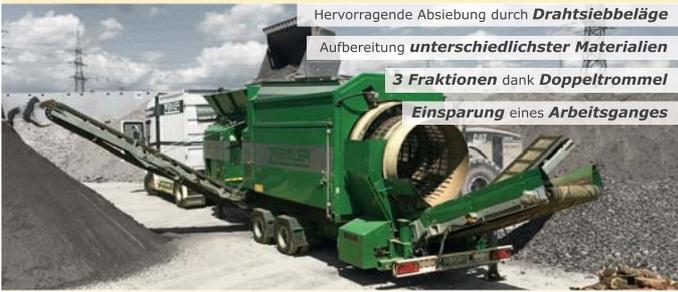
Hervorragende Absiebung durch **Drahtsiebeläge**
