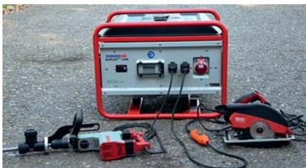
**Anschlussbeispiel von zwei Betriebsmitteln** an einen Stromerzeuger, Abbruchhammer direkt angeschlossen, Handkreissäge über einen PRCD betrieben.
