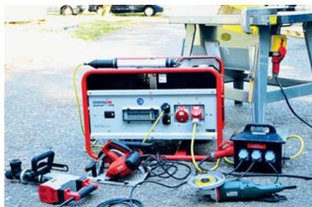
**Anschlussbeispiel von fünf Betriebsmitteln** an einen Stromerzeuger, Handleuchte direkt angeschlossen, alle anderen Betriebsmittel über Verteilerbox mit RCDs betrieben.
