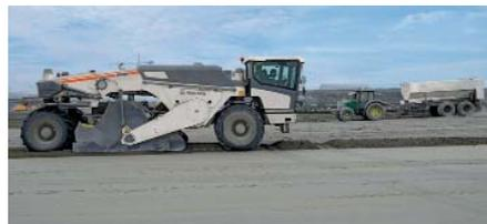
**Hochtragfähige Grundlage:** Der Bodenstabilisierer WR 200 durchmischt mit seinem Fräs- und Mischrotor das Bindemittel homogen mit dem Boden. Mit drei Maschinen hatten die Arbeiten begonnen, inzwischen wurden zwei weitere Geräte für die Baustelle angefordert.
