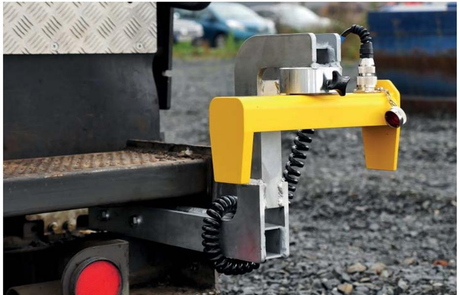
**Bei *Pave-TM*** findet die zweite Messung zur Ermittlung der Schichtdicke mit fünf Ultraschall-Sensoren je *Sonic Ski Plus* direkt hinter der Bohle statt. (Fotos: Moba)
