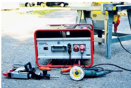
**Anschlussbeispiel von drei Betriebsmitteln** an einen Stromerzeuger, Baustellenkreissäge direkt angeschlossen, Abbruchhammer und Trennschleifmaschine über je einen PRCD betrieben.
