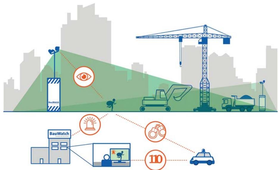
**Dank der intelligenten Video-Analyse-Software** werden unerwünschte Personen und Fahrzeuge auf dem überwachten Gelände detektiert und unmittelbar an die Sicherheitszentrale gemeldet. (Bilder: BauWatch)
