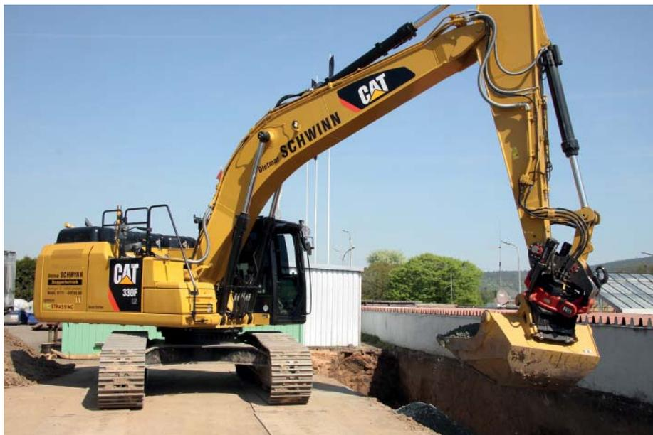
**Unikat:** der Cat 330F LN mit Grade Control und Grade mit Assist in Verbindung mit einem Tiltrotator. (Fotos: Zeppelin)
