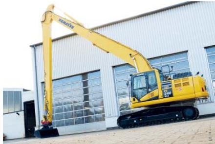
**Für Spezialaufgabe:n** Der PC240NLC-11 SLF mit hydraulischem Schnellwechsler, LED-Scheinwerfern und Topcon 3D-GPS-Maschinensteuerung ist startklar für seinen ersten Einsatz. (Foto: Schlüter Baumaschinen)
