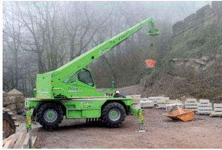
**Errichten der Böschung:** Der drehbare Teleskoplader Roto 45.21 hebt 4,5 t Material ferngesteuert bis zu 21 m hoch.
