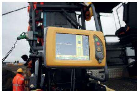
Exakte Daten aus dem Referenzmodell auf der Steuereinheit der Asphaltfräse.
