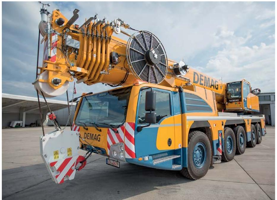
**Der Fünffachs-Kran AC 250-5** bietet mit 250 t Tragkraft, 70-m-Hauptausleger und serienmäßiger Allradlenkung eine beeindruckende Palette an Möglichkeiten und Vorteilen. (Foto: Terex)
