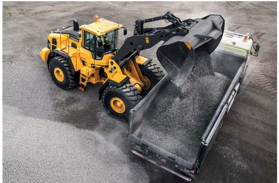
**Sicherer beladen:** Das Wiegesystem Load Assist schützt vor Über- und Unterlasten, vor einer Überbeanspruchung der Maschine und nicht zuletzt auch vor möglichen Bußgeldern. (Fotos: Volvo CE)
