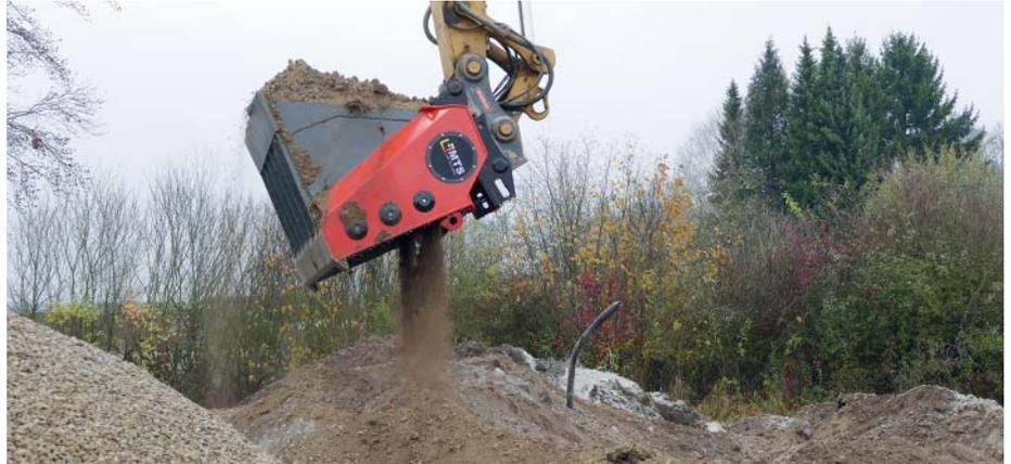
**Der Bodenrecycler punktet** beim Homogenisieren von Boden und als Problemlöser für kleinere Arbeiten. (Foto: MTS)
