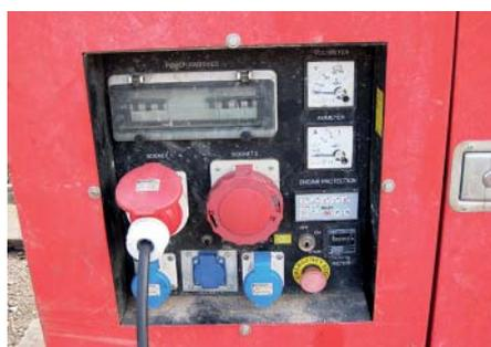
*Stromerzeuger im Baustelleneinsatz mit „eingebauter Baustromverteilung“*
