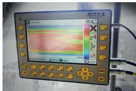
**Das *Display*** zeigt das detaillierte Temperaturprofil der gerade eingebauten Schicht direkt hinter der Bohle an.
