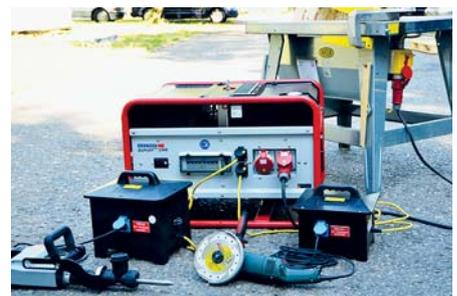
**Anschlussbeispiel von drei Betriebsmitteln an einen Stromerzeuger, Säge direkt angeschlossen, Abbruchhammer und Trennschleifmaschine werden bei „erhöhter elektrischer Gefährdung“ jeweils über einen Trenntransformator betrieben**
