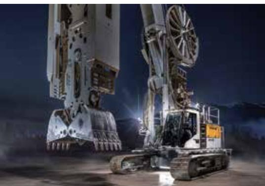
**Perfektes Team:** Das Trägergerät LBX 600 und der hydraulische Schlitzwandgreifer HSG 5-18 für Schlitzwandarbeiten. (Foto: Liebherr)
