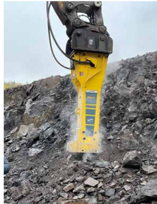
**Überlegen:** Der Hydraulikhammer HB 7000 von Epiroc bietet der Mendiger Basalt Schmitz Naturstein GmbH & Co. KG eine Reihe von Vorteilen gegenüber der üblichen Bohr- und Sprengmethode. (Foto: Epiroc)
