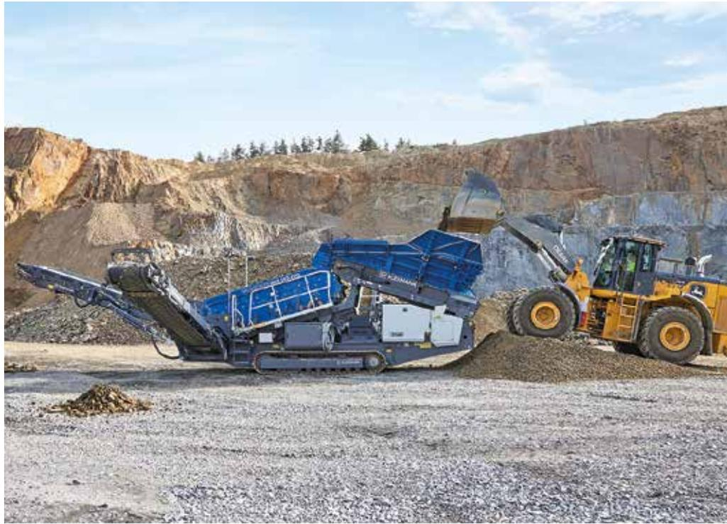
**Durchdachte Lösung:** Die MSS 502(i) EVO überzeugt mit einer Aufgabelleistung von bis zu 350 t/h im Naturstein und im Recycling. Dabei kann die Anlage rein elektrisch betrieben werden. Eine Wasserbedüsung reduziert die Staubemissionen. (Foto: Kleemann)
