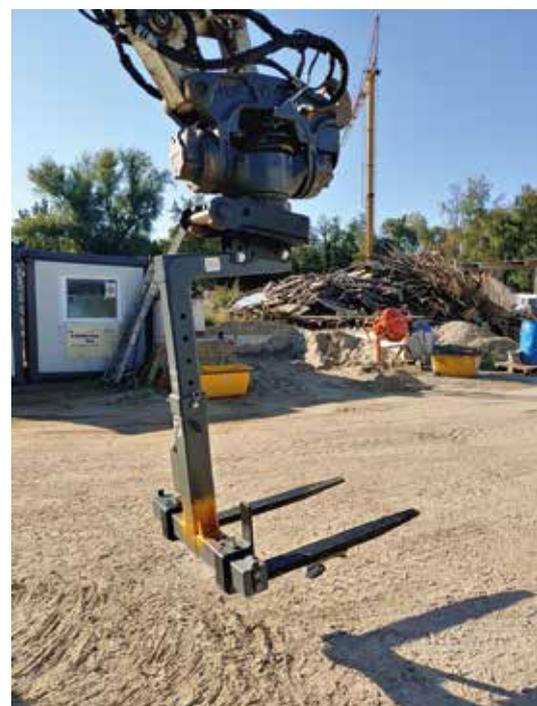
**Freie Sicht:** Die Pister Power Fork ermöglicht den Blick auf die Gabelzinken. (Foto: Hain GmbH)
