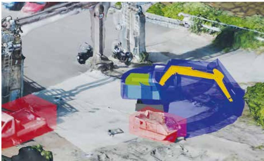
**Mehr Sicherheit:** Mit SafeCon3D werden Kollisionen im digitalen Raum in Echtzeit geprüft und Stopp-Funktionen initiiert. (Foto: TU Dresden)
