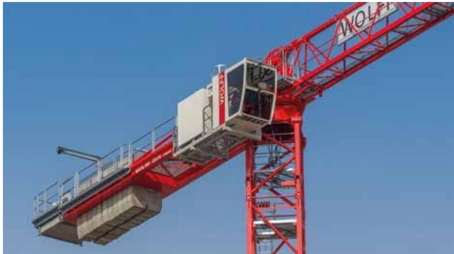
**Flexibilität erhöht:** Der Wolff 7021 Clear kann je nach Kundenbedürfnis und Budget individuell ausgestattet werden. Bei der Variante mit teilbarem Spitzenunterteil lässt sich das Montagegewicht der Turmspitze auf bis zu 6,4 t reduzieren. (Fotos: Wolffkran)
