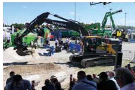
**Leise Baggerarbeiten:** Der Elektro-Bagger EC 230 von Volvo CD ist bestens für innerstädtische Kanalbaustellen geeignet. (Foto: VDBUM/Spoo)
