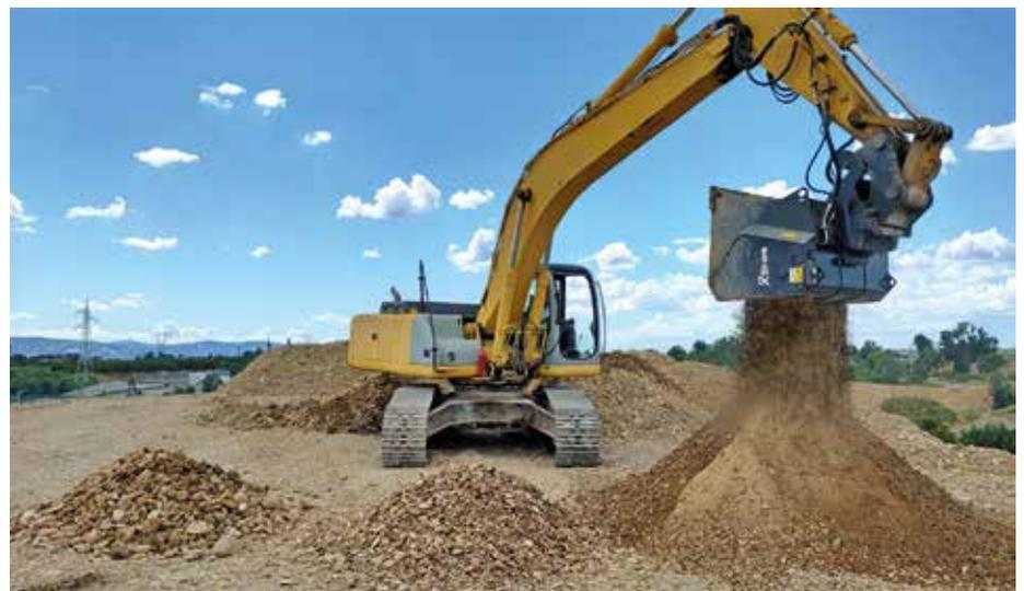
**Beschleunigtes Arbeiten:** Mit dem Separator-Sieblöffel VSE von Simex lassen sich drei oder mehrere Materialkörnungen nebeneinander anhäufen. (Foto: Simex)
