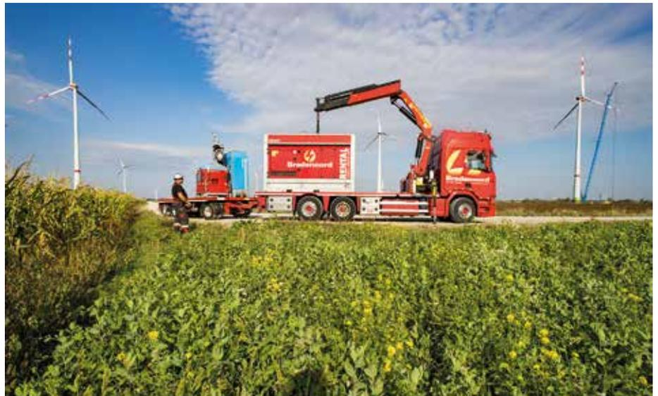
**Ohne Unterstützung:** Ein Bredenoord-Fahrer lädt ein Stromaggregat mit dem Palfinger-Ladekran ab. Hilfsmittel wie Gabelstapler werden nicht benötigt, die Ladevorgänge erfolgen schnell und unkompliziert. (Foto: Bredenoord)
