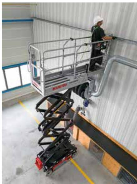
**Sicheres Arbeiten:** Die neuen Scherenbühnen von Manitou ermöglichen Einsätze in bis zu 10 m Höhe. (Foto: Manitou Group)
