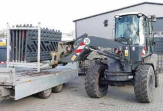
**Laden „um die Ecke“:** Der weycor Schwenklader 480 S kann den Schwenkarm um jeweils 90° nach links oder rechts drehen. (Foto: Weycor)
