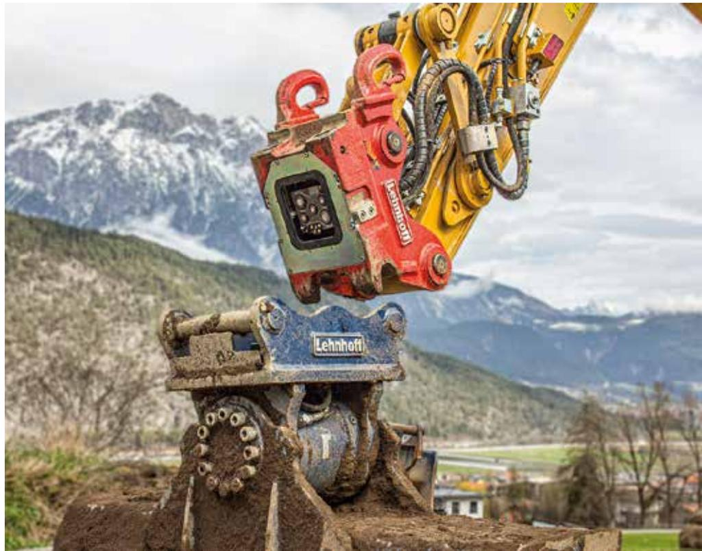
**Im Handumdrehen:** Mit dem Lehnhoff SQ 60V lassen sich dank des symmetrischen Aufbaus des Ventilblocks selbst vollhydraulische Anbaugeräte um 180° gedreht aufnehmen. (Foto: Lehnhoff)
