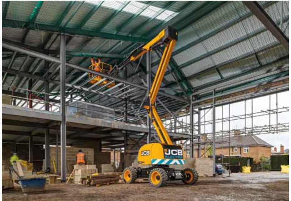
**Flexibel:** Die Gelenk-Teleskop-Arbeitsbühnen A45E und die A45EH bieten eine maximale Plattformhöhe von 13,84 m mit 7,47 m maximaler seitlicher Reichweite. (Foto: JCB)
