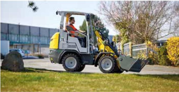
**Neue Generation:** Der E-Radlader WL20e ist nun mit einem leistungsstarken Lithium-Ionen-Akku ausgestattet. (Foto: Wacker Neuson)
