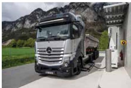
**Auf Alpentour:** Prototyp-Varianten des Mercedes-Benz GenH2 Truck mit wasserstoffbasiertem Brennstoffzellenantrieb bewiesen auf dem Brenner ihre Fähigkeiten. (Foto: Daimler Truck)
