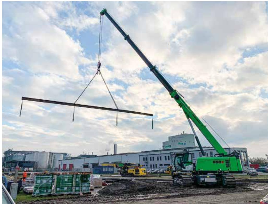
**Keine Beschädigungen:** Der 50 t Raupen-Teleskopkran wurde für die Arbeiten am Kai in Straubing mit bodenschonenden Gummipads ausgerüstet. (Foto: Franziska Limbrunner)
