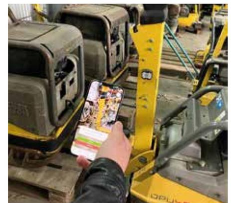
**Automatisiertes Equipment-Tracking:** Nach der Befestigung der Bluetooth Tracker durch Schrauben oder Kleben wird die Hardware einmalig via QR-Code-Scan mit dem Gerät verknüpft. (Foto: OneStop Pro)
