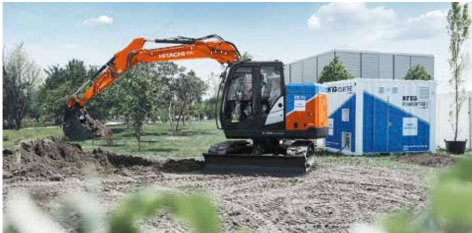
**Kraftvolles Duo:** Powertree und der vollelektrische Bagger ZE85 von KTEG arbeiten emissionsfrei. (Foto: Kiesel)
