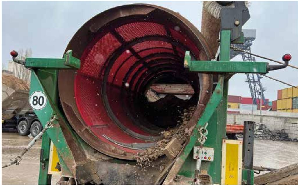
**Leiseres Arbeiten:** Eine Siebtrommel aus Metall wurde mit Pucest-Trommelbelägen ausgestattet, was zu einer erheblichen Reduzierung des Lärms führte. (Foto: Pucest)
