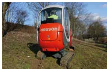
1988: Das Vertical Digging System (VDS) erlaubt exaktes vertikales Graben auch auf unebenem Untergrund, an Bordsteinkanten und am Hang.
