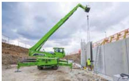
**Leistungsstark:** Die Teleskoplader von Merlo verfügen über Hubkräfte von bis zu 5 t und eine Hubhöhe bis zu 18 m.
