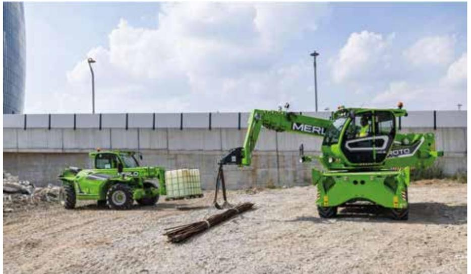
**Vielfältig:** Merlo bietet Modelle mit Starr-Rahmen und drehbarem Oberwagen. Es gibt Varianten mit Klappstützen sowie einzeln vertikal und horizontal teleskopierbaren Stabilisatoren. (Fotos: Merlo)
