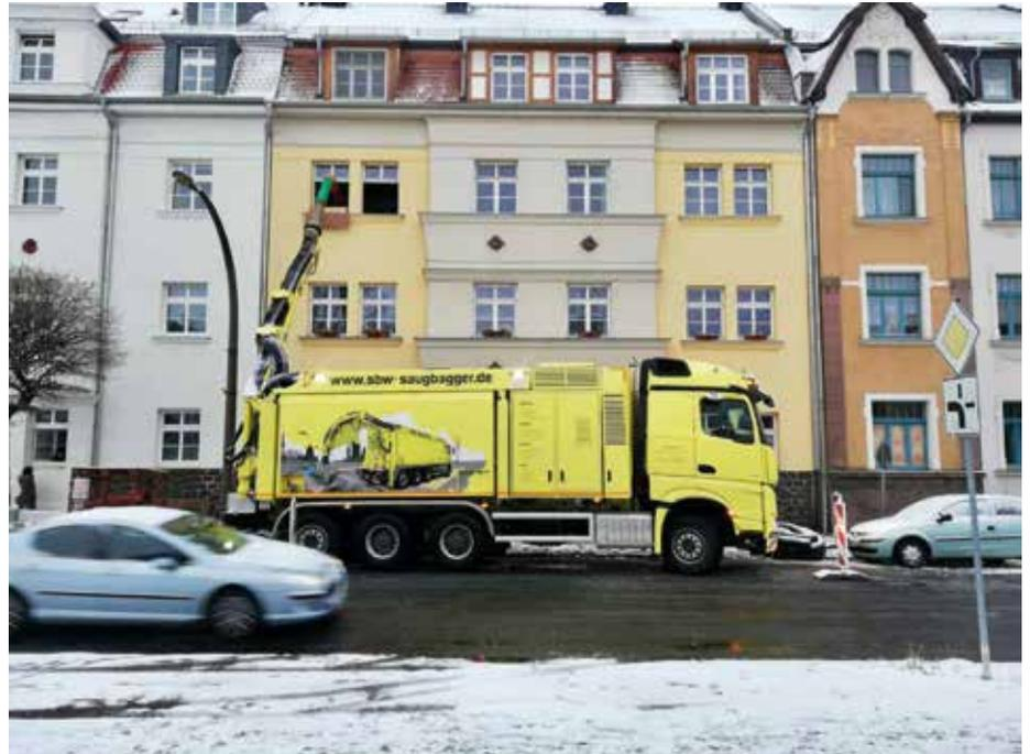
**Vielfältige Einsatzbereiche:** Die SBW GmbH nutzt ihren Saugbagger zum Entfernen von Schuttgut und Bauschutt aus den oberen Etagen eines Wohnhauses in Wurzen. (Foto: SBW GmbH)
