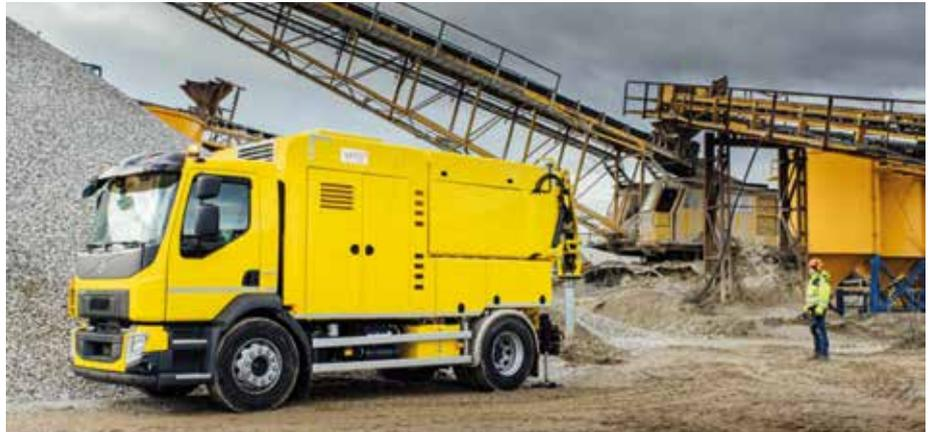
**Kompakt:** Der Dinocity ist 7 m lang und 3,3 m hoch und wurde speziell für enge, innerstädtische Tiefbauarbeiten entwickelt. (Fotos: MTS)
