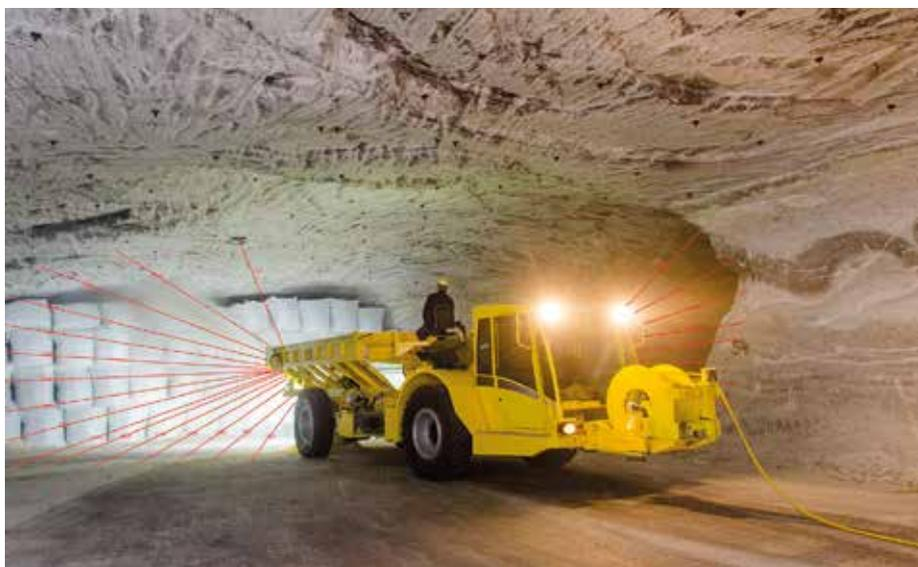
Das SaFe-System von Bergmann zur Absicherung von Gefahrenzonen an mobilen Baumaschinen benötigt keine mechanische Vorbereitung. (Foto: Bergmann)
