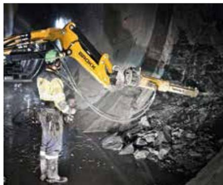
**Vielseitig:** C20 Steinspaltzylinder, hier an einem Trägergerät von Brokk, steigern die Produktivität in Branchen wie Bergbau, Steinbruch, Tunnelbau, Bauwirtschaft und Abbruch. (Foto: Brokk)
