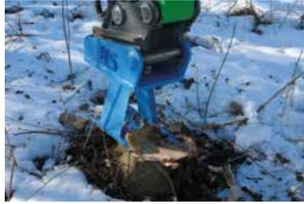
**Raus damit:** Der HS-Wurzelkönig entfernt Baumstümpfe und Wurzelstöcke samt Seitenwurzeln. (Foto: HS Schoch)
