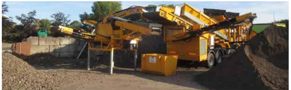
**Mobile Einheit:** Das Sternsieb 3-mta mit Windsichtung der Backers Maschinenbau GmbH. (Foto: Backers)
