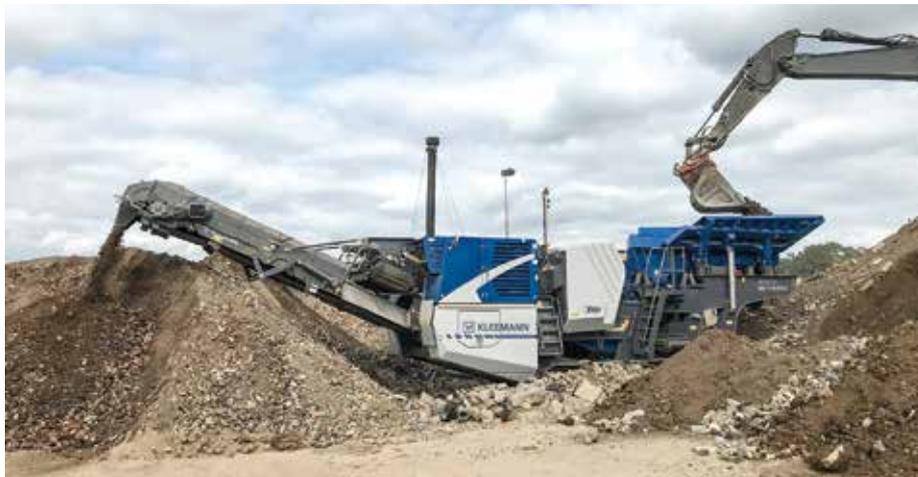
**Effektive Grobzerkleinerung:** Die Mobicat MC 110(i) EVO2 ist für die erste Brechstufe konzipiert und wird im mittelharten bis hartem Naturstein und im Recycling eingesetzt. (Foto: Kleemann)
