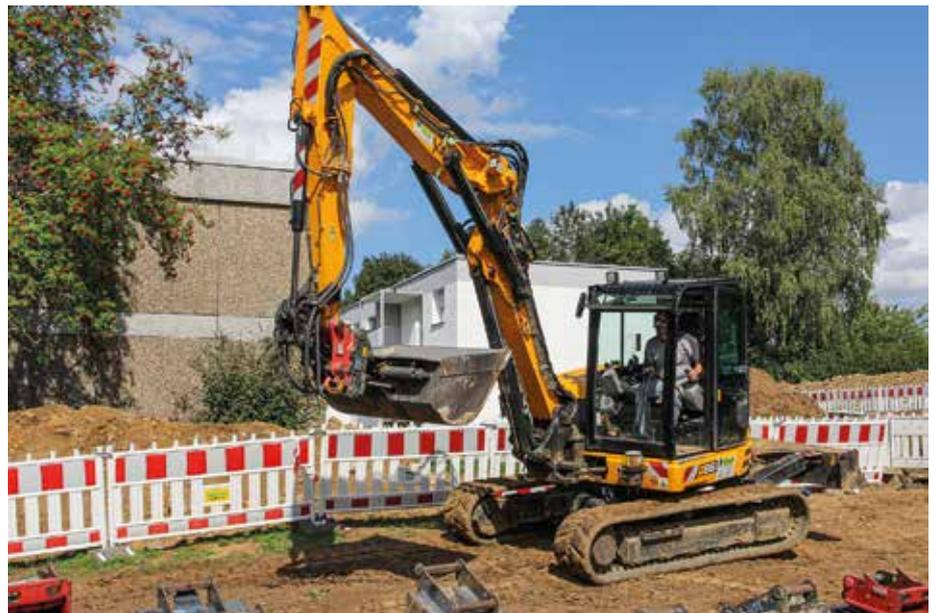
**Kein Ausstieg nötig:** Der Werkzeugwechsel wird von der Kabine aus gesteuert. Daher muss sich kein Mitarbeiter im Gefahrenbereich aufhalten. (Foto: Lehnhoff Hartstahl GmbH)
