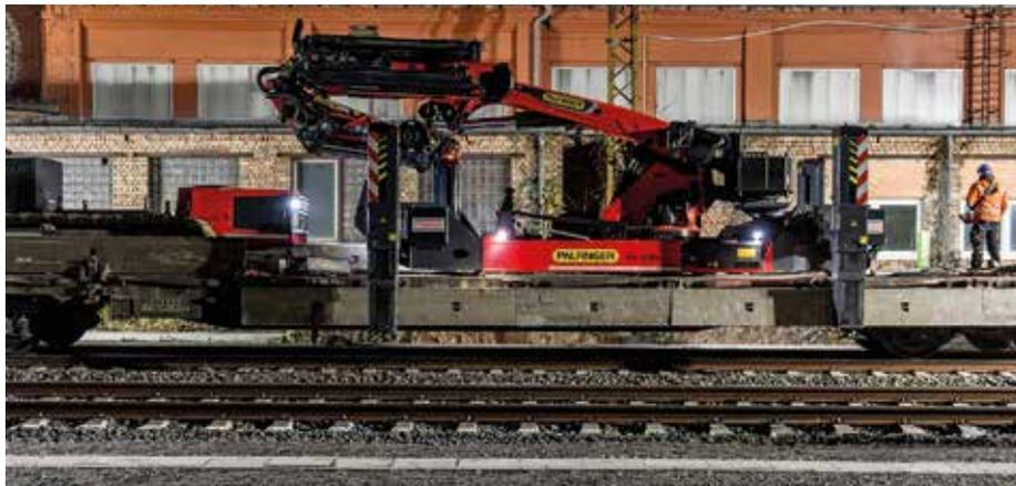
**Barriere- und Hindernisfrei:** Der Palfinger-Raupenkran PCC 71.002 wurde für einen Einsatz am Leipziger Hauptbahnhof zum Eisenbahnkran umfunktioniert. (Foto: Palfinger)
