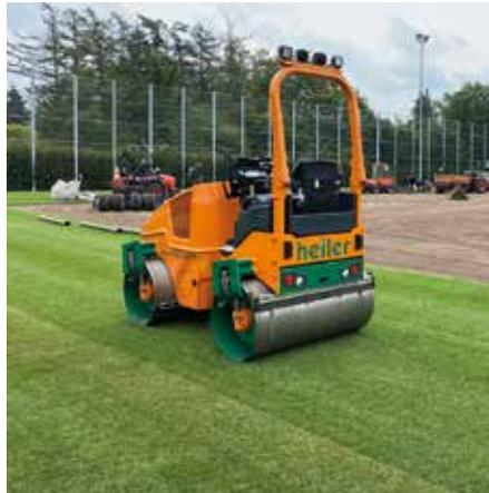
**Sonderanfertigung:** Eine kundenspezifisch umgebaute Tandemwalze BW 120 AD-5 von Bomag wurde eingesetzt, um den neu verlegten Rollrasen auf den Trainingsplätzen des VfL Osnabrück optimal anzudrücken. (Foto: Bomag)
