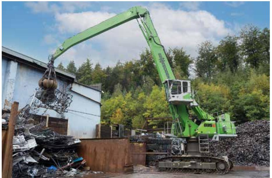
**Intelligent:** Durch die Kopplung des Elektrobaggers 835 E an die hauseigene Photovoltaikanlage ergibt sich bei Klichta Rohstoffe & Recycling eine Betriebskosteneinsparung von satten 60 %. (Fotos: Stefan Hanke)
