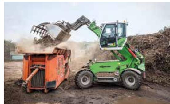
**Auf Augenhöhe:** Der Teleskopklader 355 E bietet durch die hochfahrbare Kabine einen hervorragenden Blick in die Ladeöffnung des Schredders.
