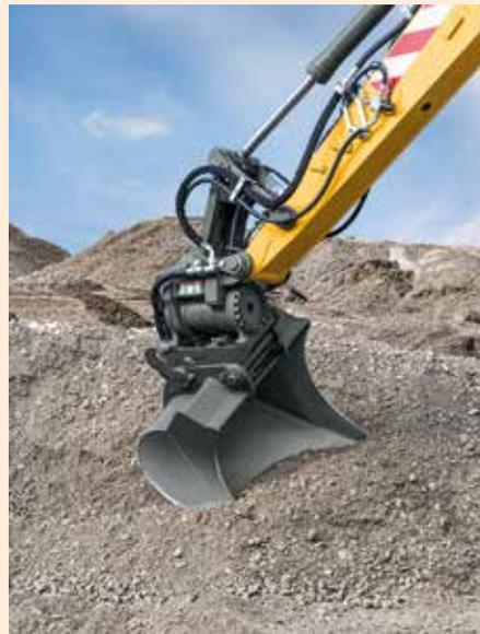
**Mehr Flexibilität:** Mit der neuen LiTiU-Einheit wird jedes starre Anbauwerkzeug zu einer schwenkbaren Einheit, ohne dass ein Anbauwerkzeugwechsel vorgenommen werden muss. (Foto: Liebherr)
