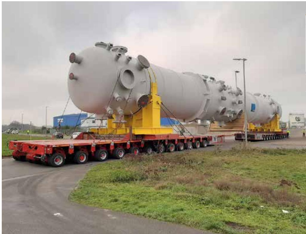
**Im Schnecken tempo:** Der 658 t schwere Cooler wird auf zwei eineinhalbfachen Selbstfahrern zum Transportschiff in Haren an der Ems verbracht.
