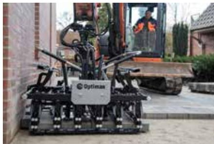
**Der Optimas Pflastergreifer Multi6 M** kann direkt an die Wand verlegen. (Foto: Optimas)
