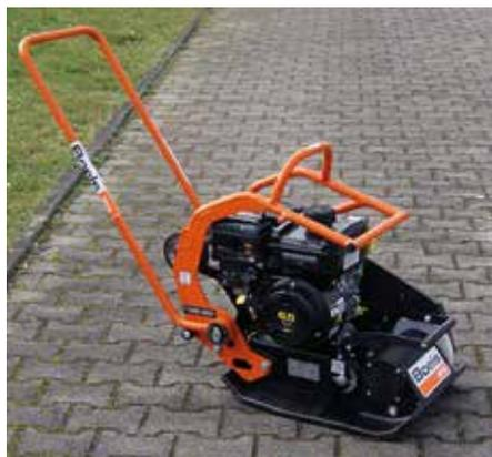
**Boels Rental** hat die ersten Rüttelplatten APF 15/40 von Ammann erhalten, die mit Vanguard 200 Einzylinder-Motoren ausgestattet sind. (Foto: Boels)
