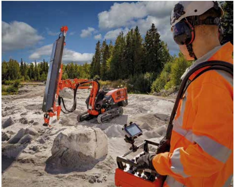
**Gute Sicht:** Über Smartphone oder Tablet kann der Arbeitsfortschritt des überarbeiteten Übertage-Außenhammerbohrgeräts Dino DC400Ri kontrolliert werden. (Foto: Sandvik)
