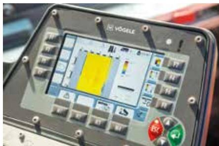
**Das Modul JobSite** liefert Daten wie die aktuelle Einbautemperatur auf das Display der ErgoPlus 3 Bedienkonsole.
