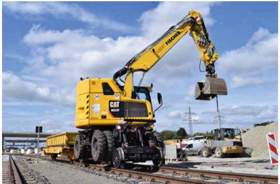
Die Schienenführungsräder treiben den Zweiwegebagger dank hydrostatischen Schienenradantriebs an. Daraus resultiert eine hohe Bodenfreiheit. (Fotos: Caterpillar/Zeppelin)
