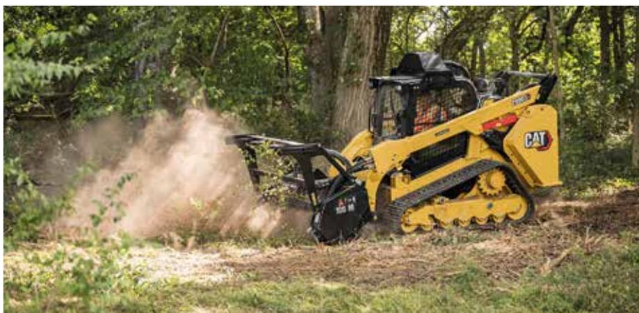
**Spitzenmodell der neuen Deltalader:** Der 299D3 XE eignet sich für vor allem für Anbaugeräte mit sehr hohem Leistungsbedarf. (Foto: Caterpillar/Zeppelin)
