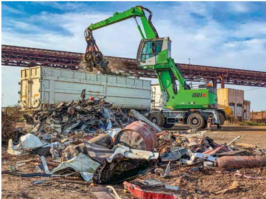
**Gute Sicht:** Der 821 Mobil ist mit der hochfahrbaren Kabine Maxcab ausgestattet. (Foto: Sennebogen)
