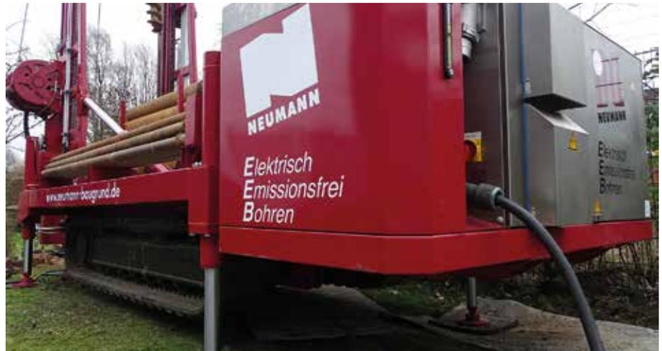
Das arbeitsbereite Kompakt-Trockenbohrgerät F80C mit Stromaggregat im Betrieb bei der Messstellenherstellung. (Foto: Foratron)
