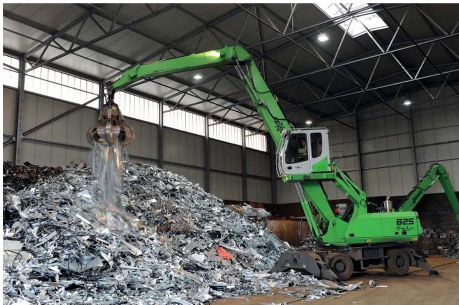
**Mit modularen Unterwagen**, hochfahrbarem Fahrerhaus und Ausrüstungslängen bis 30 m sind die Umschlagbagger für vielfältige Einsätze konzipiert.
