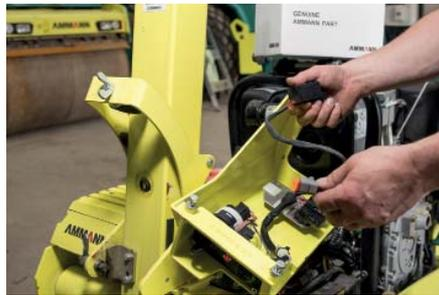
Das ServiceLink-Relais ist ab 2018 Standard bei Verdichtern der Reihe APR, APH und ARW, kann aber auch nachgerüstet werden. (Foto: Ammann)
