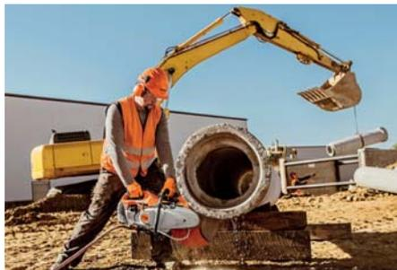
**Ran ans Rohr:** Der neue Trennschleifer TS 440 ermöglicht eine erweiterte Verstellung des Scheibenschutzes. So lassen sich Schneidarbeiten an der Rohrunterseite besonders einfach erledigen. (Foto: Stihl)
