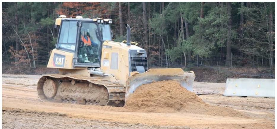
**Der Dozer nutzt eine ab Werk vollintegrierte 3D-Steuerung**, mit der der Fahrer sowohl bei schweren Abschiebearbeiten als auch beim Feinplanieren die Genauigkeit und Produktivität verbessern kann. (Fotos: Zeppelin)
