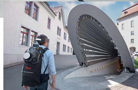
**Mobile Mapping Systeme** erlauben es, ein digitales Abbild (Reality Capture) der Umgebung zu erfassen.
