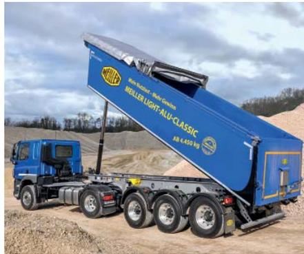
**Ob Halfpipe oder – wie hier – Kastenmulde:** Wer die elektrische Schiebeplane konsequent nutzt, verbessert die Aerodynamik des Fahrzeugs und reduziert den Kraftstoffverbrauch. Sie empfiehlt sich besonders für das heiße Transportgut Asphalt.
