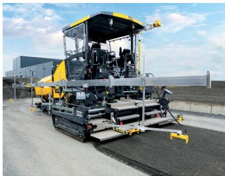
*PAVE-TM ist weltweit das erste und einzige System zur automatischen und berührungslosen Schichtdickenmessung während des Asphalt einbaus. (Foto: Moba)*
