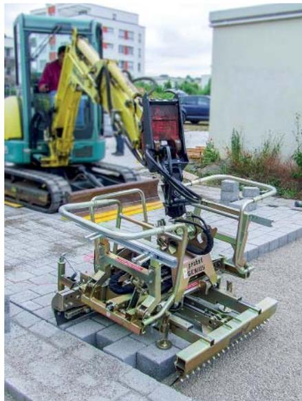
**Mit der hydraulischen Verlegzange HVZ-Genius** von Probst wird der Minibagger zur Pflasterverlegemaschine
