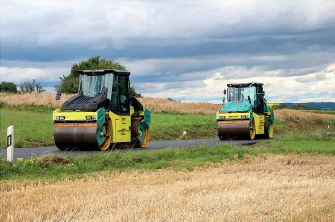
**Mit automatisierten Tools** wie ACEpro von Ammann wird die Qualität der Verdichtung automatisiert gesteuert, überwacht und dokumentiert. (Foto: Ammann)
