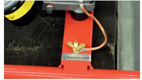
**Vorhandene Anschlussschraube** für den Potentialausgleich eines Stromerzeugers der Bauart A, welcher gar nicht geerdet werden muss
