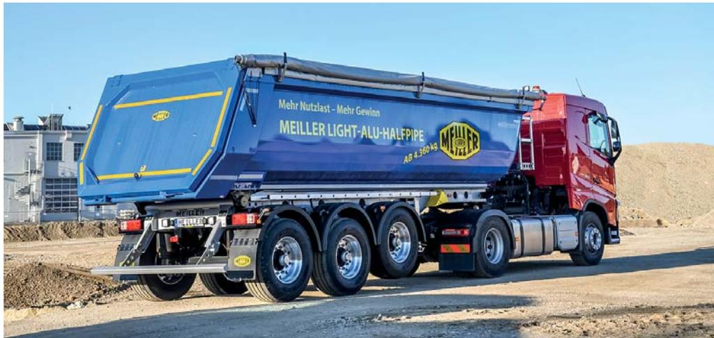
**Die Halfpipe-Mulden** erhalten durch horizontale Bordwandsicken trotz reduzierter Wandstärken mehr Steifigkeit und Formbeständigkeit. (Fotos: Meiller)
