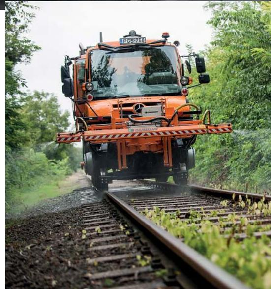
**Die Unimogs** sind mit verschiedensten Geräten kombinierbar, wie beispielsweise einer Dammann-Gleissprühanlage.
