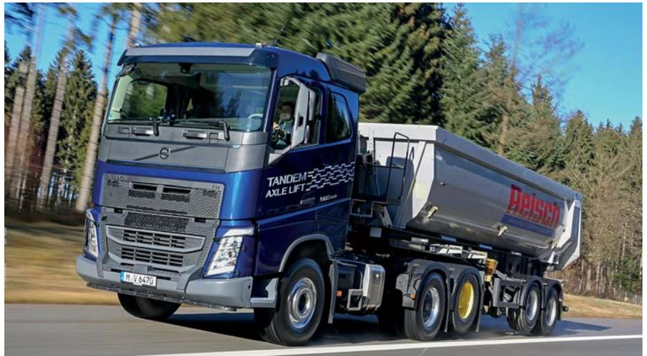
Beim FH 500 spart das Entkoppeln und Anheben der letzten Antriebsachse bei Leerfahrten bis zu zehn Prozent Diesel. (Foto: Volvo Trucks)
