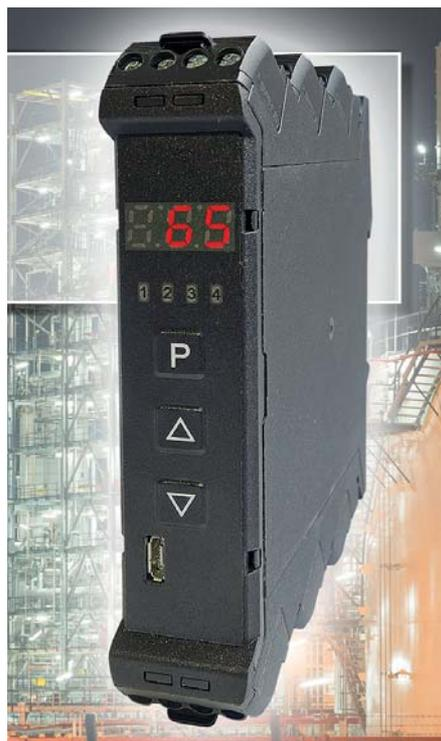
Der Universal-Messumformer mit integrierter Digitalanzeige ist mit einem Universalmesseingang versehen. (Foto: Müller Industrie-Elektronik)
