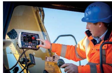
**Mit 3D-Maschinensteuerungen** auf Bagger, Raupe und Grader baut man mit gleichbleibend hoher Qualität schnell und effektiv.
