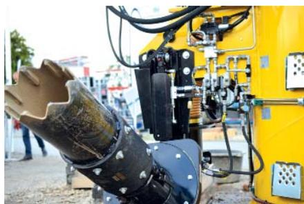
**Der Saugstrom** kann Erdstoffe bis zur Größe des Schlauchdurchmessers aufnehmen. Somit lassen sich selbst Klinker und Granitpflastersteine aufsaugen.
