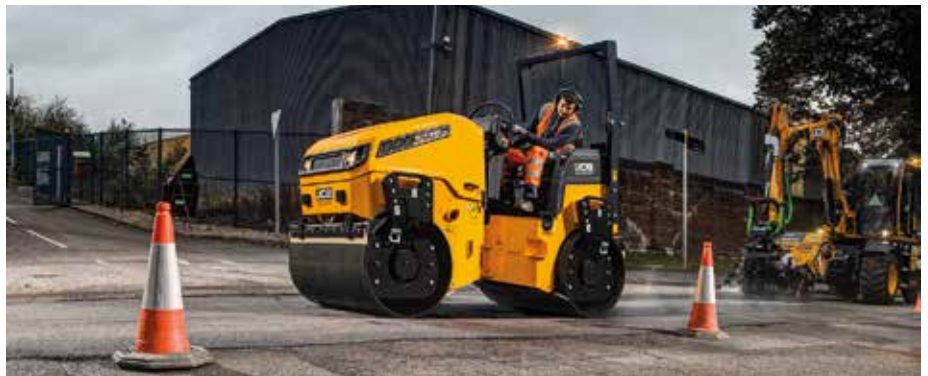
Optimales Ergebnis: Eine automatische Vibrationssteuerung der neuen Tandem-Vibrationswalze CT380-130 vermeidet eine zu starke Verdichtung. (Foto: JCB)
