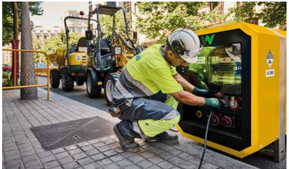
Mobile Ladeinfrastruktur: Die Charging Box CB250 ermöglicht eine kontinuierliche Energieversorgung auf der Baustelle. (Foto: Wacker Neuson)
