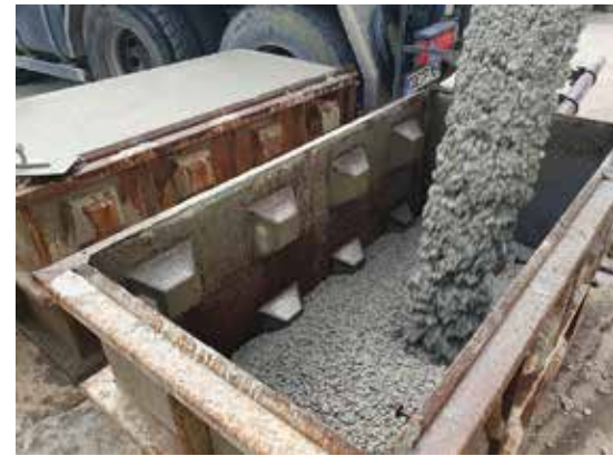
Technisch geeignet: Herstellung von Beton-„Legosteinen“ im Transportbetonwerk unter Verwendung von SWS. (Foto: FEhS-Institut)
