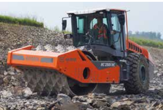
Kräftig: Hamm bietet neue Walzenzüge für das Brechen und Verdichten von Gestein an. (Foto: Wirtgen Group)
