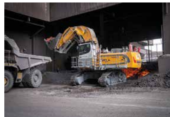
Maßanfertigung: Der Raupenbagger R 980 SME entspricht den Anforderungen des Schlackenspezialisten Backes. Die Kippschaufel kann ein großes Volumen an Schlacke aufnehmen. (Foto: Liebherr)
