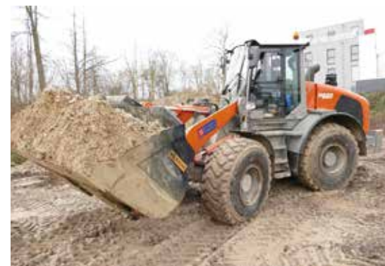
Schlank und wendig: Der 14 t Radlader weycor AR 660 verfügt über ein ausgezeichnetes Leistungsgewicht. (Foto: weycor)
