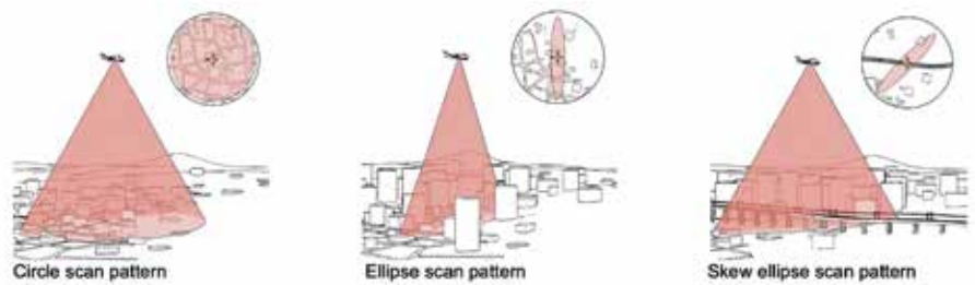
Drei Scanmuster: Mit dem kreisförmigen Scanmuster, dem elliptischen Scanmuster und dem schräg-elliptischen Scanmuster (v.l.n.r.) wird die Sensorleistung an die spezifische Anwendung angepasst.
