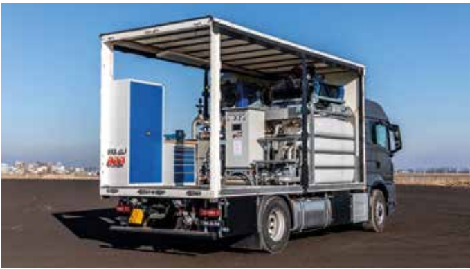
Hohes Einsparpotential: Mit dem Mudcleaner-Truck von Max Wild lassen sich bei der Aufbereitung von Bohrschlamm aus dem HDD-Verfahren Ressourcen sparen. (Foto: Max Wild)
