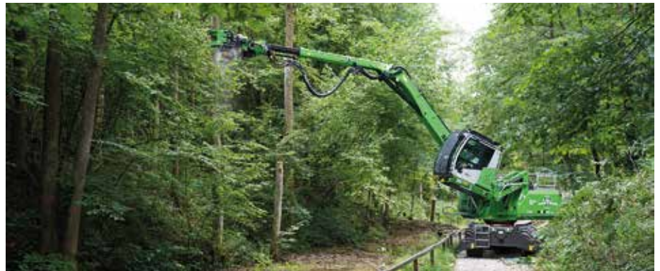
Beste Sicht: Der Fällbagger 718 E punktet mit herausragenden Sicherheitsmerkmalen, einer Reichweite von 13 m und hoher Standfestigkeit. (Foto: Sennebogen)
