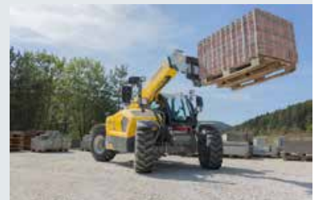
Niedrige Bauhöhe: Der Teleskopler 2706 von Kramer bewältigt geringe Durchfahrthöhen bei hoher Nutzlast. (Foto: Kramer)
