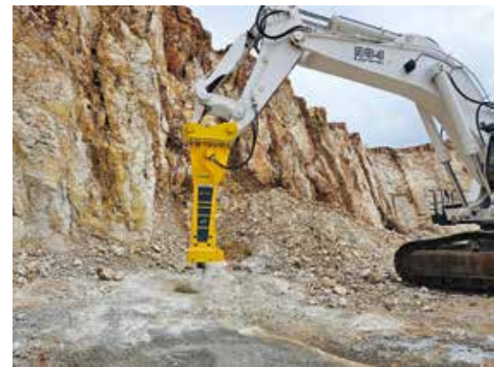
Starke Leistung: Der HB 10000 von Epiroc hat ein Dienstgewicht von 10 t und liefert eine Einzelschlagenergie von 16.000 J. (Foto: Epiroc)
