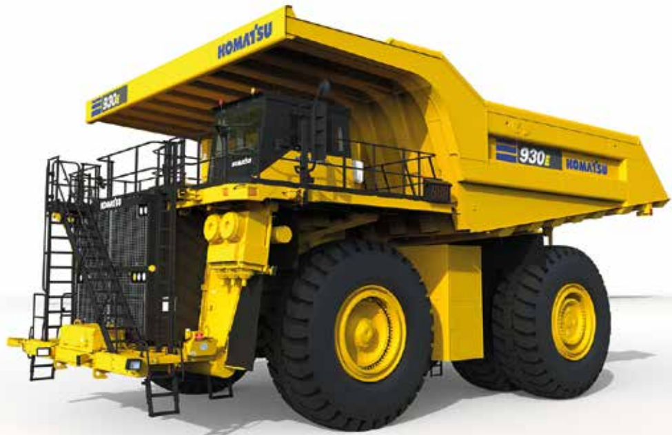
Umweltfreundliches Großgerät: Der Komatsu 930E Muldenkipper, der zukünftig von Hydrotec-Brennstoffzellen angetrieben wird. (Grafik: Komatsu)
