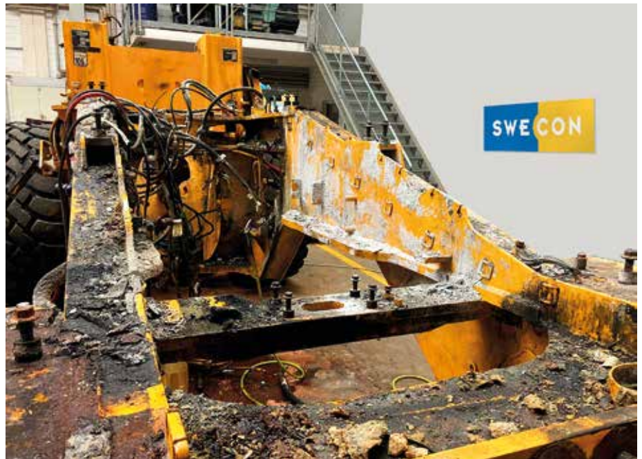
Herausforderndes Projekt: Maschinenarbeiten im Salz haben starken Rost und Korrosion verursacht. Nachdem der Rahmen freigelegt ist, ist das Ausmaß der Schäden gut sichtbar. (Fotos: Swecon)
