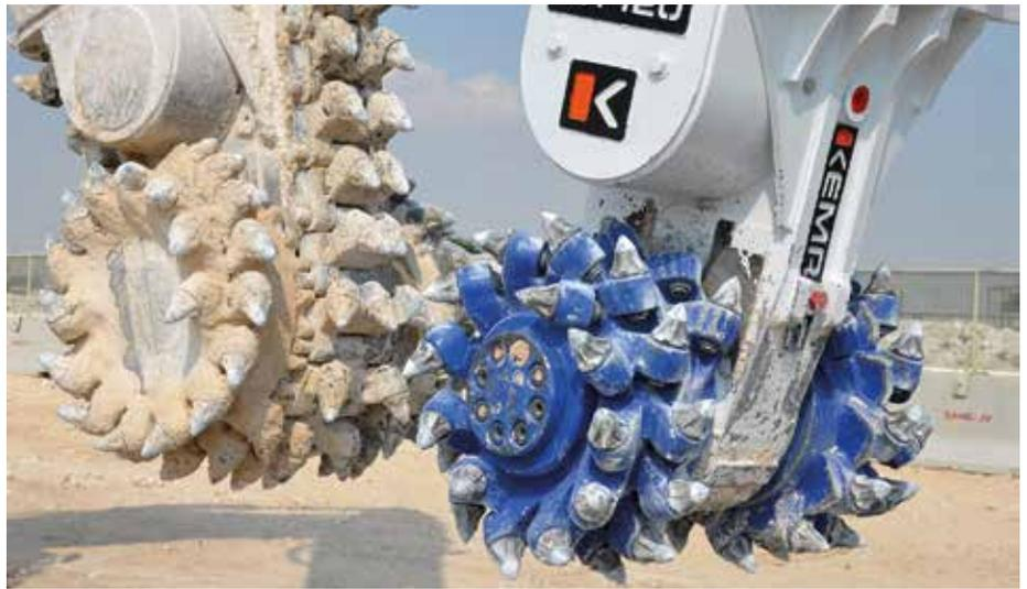
**Mit oder ohne Kette:** Zusätzlich zu den Kettenfräsen der Baureihe EK (l.) mit der mittig umlaufenden Fräskette bietet Kemroc nun auch Querschneidkopffräsen der Baureihe KR (r.) ohne Fräskette an. (Fotos: Kemroc)
