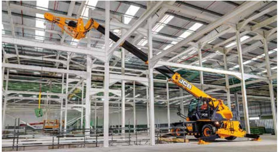
**Der Hydraload** kann Lasten auf eine Höhe von bis zu 20,5 m heben.
