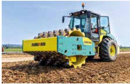
**Das hydrostatische HX-Antriebsystem** sorgt – unabhängig von der Beschaffenheit des Baustellengeländes – stets für volle Leistung. (Fotos: Ammann)
