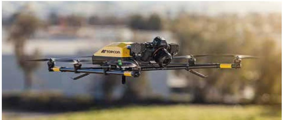
**Sicher:** Selbst bei einem Ausfall von drei der acht Rotoren, stürzt der Falcon8+ nicht ab. (Foto: Topcon)
