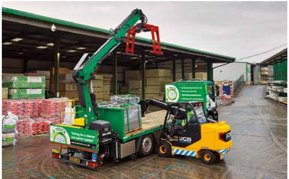
**Der Teletruk** kann eine Ladung von 1.600 kg bis zu 3 m tief in einen Transporter absetzen.
