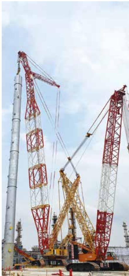
**Verstärkung:** Erst eine Konfiguration mit Boom Booster ermöglichte dem CC 8800-1 den Tandem-Hub eines 510 t schweren Splitter-Turms zusammen mit einem CC 2800-1 durchzuführen. (Foto: Demag)
