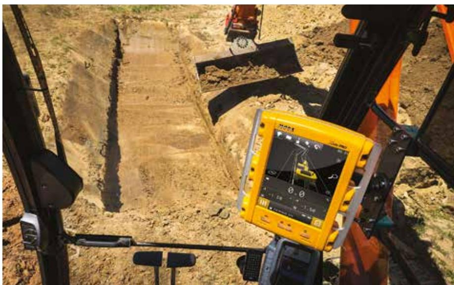
**Bedieneinheit** der X-Site-Steuerung im Jahr 2017
