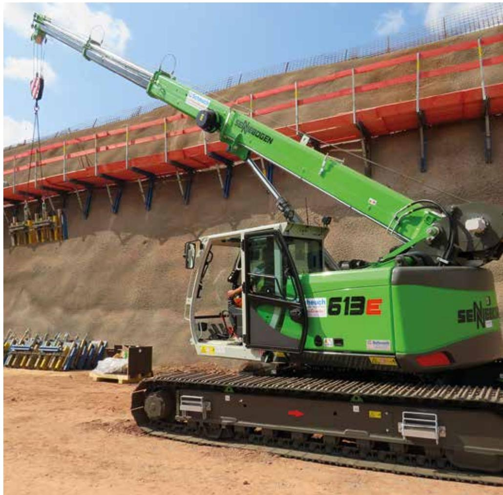
**Der Raupentelekrane 613 E** kann bis zu 16 t heben und steht auch auf unbefestigtem Gelände sicher und stabil. (Foto: Sennebogen)
