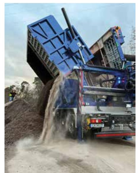
**Gut gelöst:** Das Hochkippsystem ermöglicht das Entleeren des Saugguts in Kipperfahrzeuge und vermeidet so ein Zuschütten der Räder.
