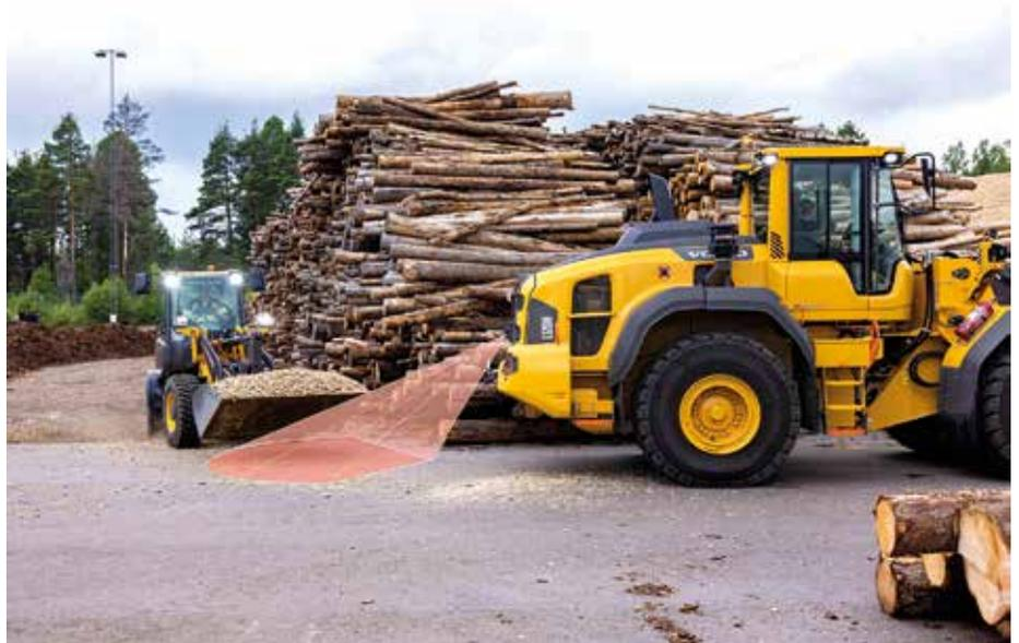
**Gefahr erkannt:** Das Collision Mitigation System erfasst, ob beim Rückwärtsfahren eine Kollision droht und aktiviert die Bremsen, um einen Aufprall zu vermeiden. (Fotos: Volvo CE)
