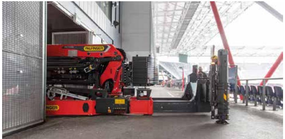
**Millimeterarbeit ohne Einschränkungen:** Der PCC 57.002 Raupenkran von Palfinger bewältigt den schmale Eingang der Red Bull Arena Salzburg mit lediglich 2,83 m Höhe und 2,87 m Breite. (Foto: Palfinger)
