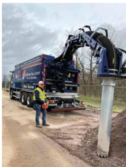
**Komplett verschiebbar:** Der neu entwickelte und patentierte 4-gelenkige Kraftarm sorgt für mehr Flexibilität.
