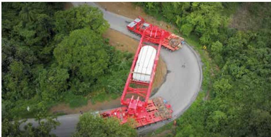
**Flexibel:** Dank verschiedener Fahrmodi kann der Addrive von Goldhofer gezogen werden, die Zugmaschine unterstützen und unabhängig als hydrostatisch angetriebener Selbstfahrer eingesetzt werden. (Foto: Goldhofer)
