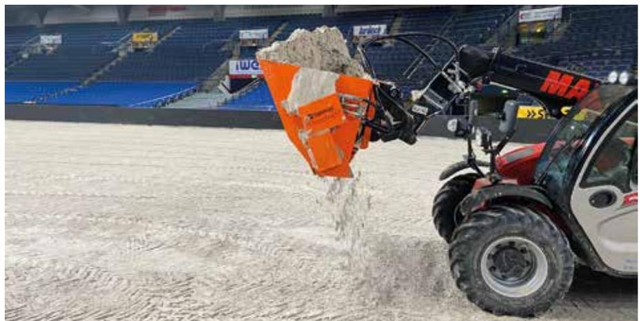
**Problemlos eingestreut:** Bei der Vorbereitung der Stuttgarter Hans-Martin-Schleyer-Halle für das German-Master Reitturnier hat die Optimas Streuschaufel ein Sand-Kunststofflocken-Gemisch auf dem Reitboden aufgetragen. (Foto: Optimas)
