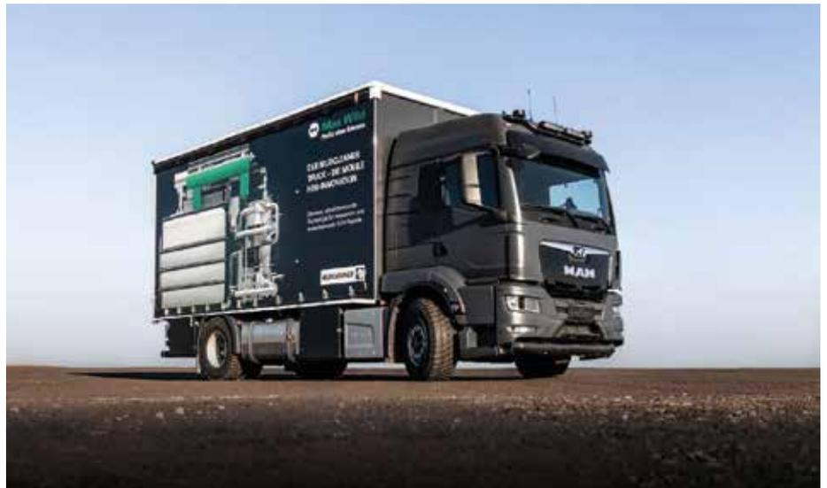
Der Mudcleaner-Truck der Max Wild GmbH ermöglicht ressourcenschonendes mobiles Bohrschlammrecycling. (Foto: Max Wild GmbH)
