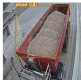
a. Automatisch erkanntes Sand-Kies Gemisch in Detektionsboxen durch Bilderkennung
