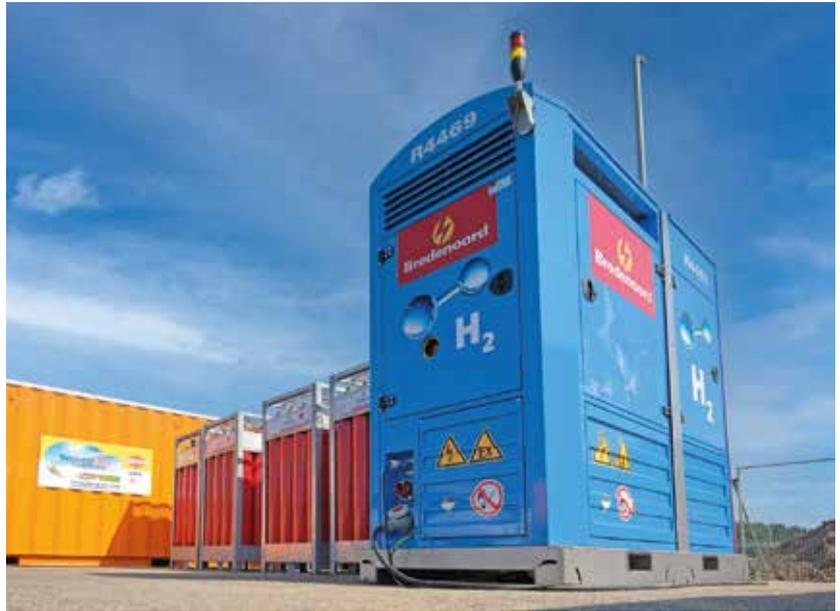
**Zuverlässig:** Der Bredenoord Hydrogen Power verwendet aus Wasserstoff gewonnene Energie zum Laden der Batterie und versorgt Baucontainer und verschiedene Elektroautos und -Baumaschinen mit Strom. (Foto: Bredenoord)
