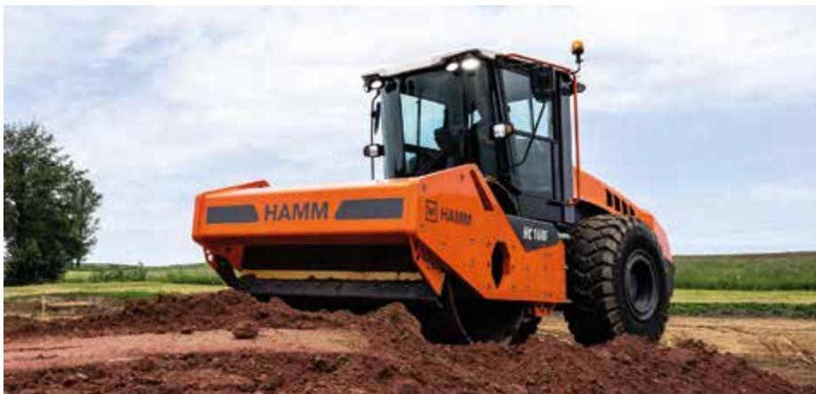
**Gipfelstürmer:** Die Walzenzüge der Serie HC sind prädestiniert für einfaches Verdichten auch in unebenem oder steilem Gelände – sogar bei Steigungen über 60 %. (Foto: Wirtgen Group)
