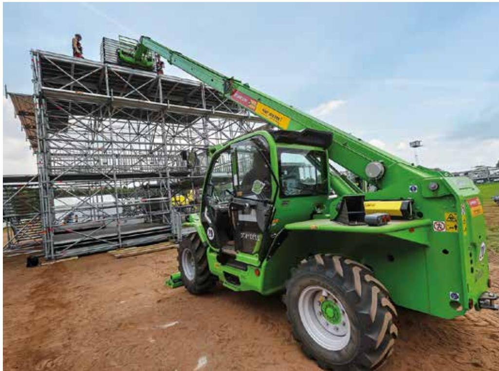
**Hoch hinaus:** Der Merlo 40.13 überzeugt mit einer Reichweite von 13 Metern und geringen Emissionswerten. (Foto: action press / Ibo Ot)
