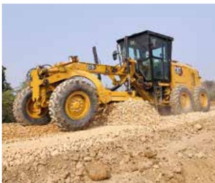
**Beweglich und kraftvoll:** Der neue Motorgrader Cat 120 GC mit 128 kW Motorleistung und einem Einsatzgewicht von rund 16 t. (Foto: Caterpillar/Zeppelin)
