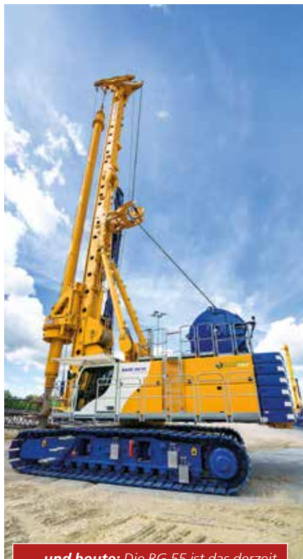
...und heute: Die BG 55 ist das derzeit größte Drehbohrgerät im Portfolio des Herstellers.
