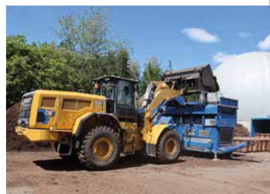
Eigener Stromspeicher: Vier bis sechs Stunden täglich ist der batterieelektrische Radlader bei BioIN im Einsatz.
