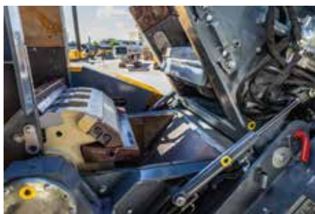
Neuer HD-Rotor: Durch die deutlich erhöhte Eigenmasse (hier beim RM 90X) steht mehr kinetische Energie im Brechprozess zur Verfügung.
