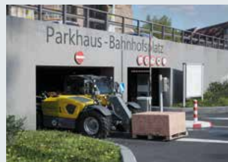
Überladung vermeiden: Das integrierte dynamische Wiegesystem des Teleskopladers 3106 unterstützt Anwender dabei, Transportfahrzeuge optimal auszulasten. (Foto: Kramer)
