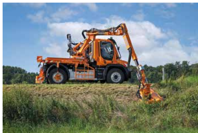
Hohe Reichweite: Der Unimog U 535 hat einen Aktionsradius von bis zu 7 m. (Foto: Daimler Truck)
