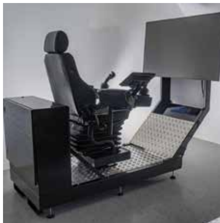
Veränderter Arbeitsplatz: Auf dem Steuerstand bleibt der Bediener im Mittelpunkt, er verlässt aber den Gefahrenbereich. (Foto: VDBUM)
