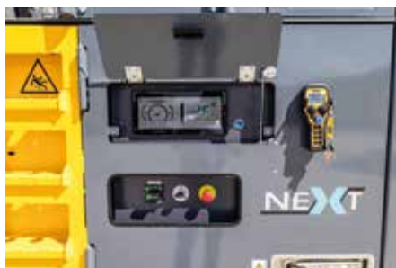
Verbesserte Interaktion: Der integrierte Performance-Indikator macht die aktuelle Auslastung sichtbar, während die Kommunikationsbeleuchtung den Maschinenzustand eindeutig signalisiert.
