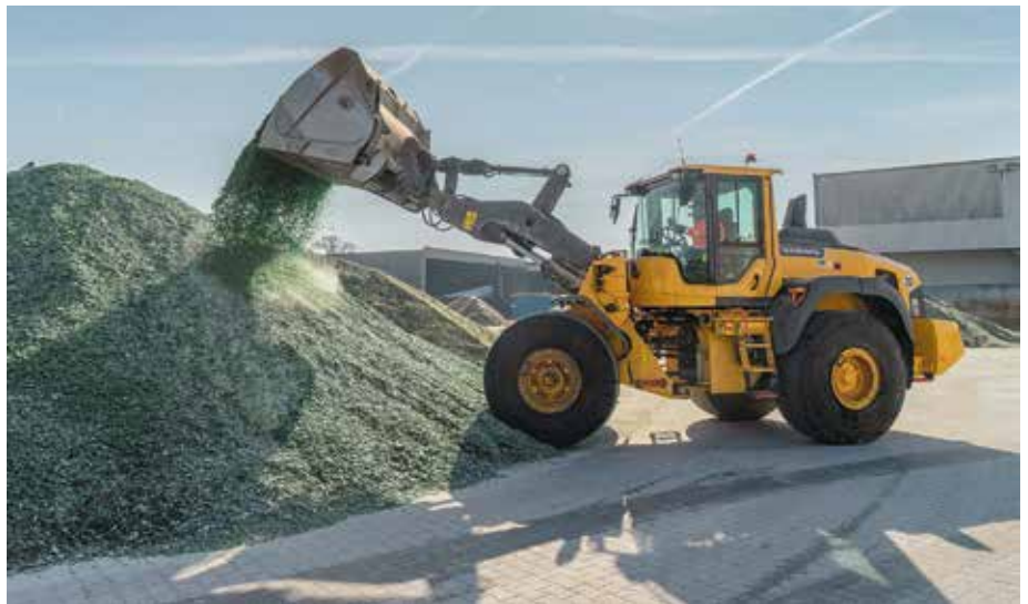
Schwerstarbeit im Recycling: Abrasive Materialien des Glasbruchs setzen dem Volvo L120H stark zu. Dank Volvo Rebuild kann dem Verschleiß aktiv entgegengewirkt und die Lebenszeit des Radladers deutlich verlängert werden. (Fotos: Swecon)
