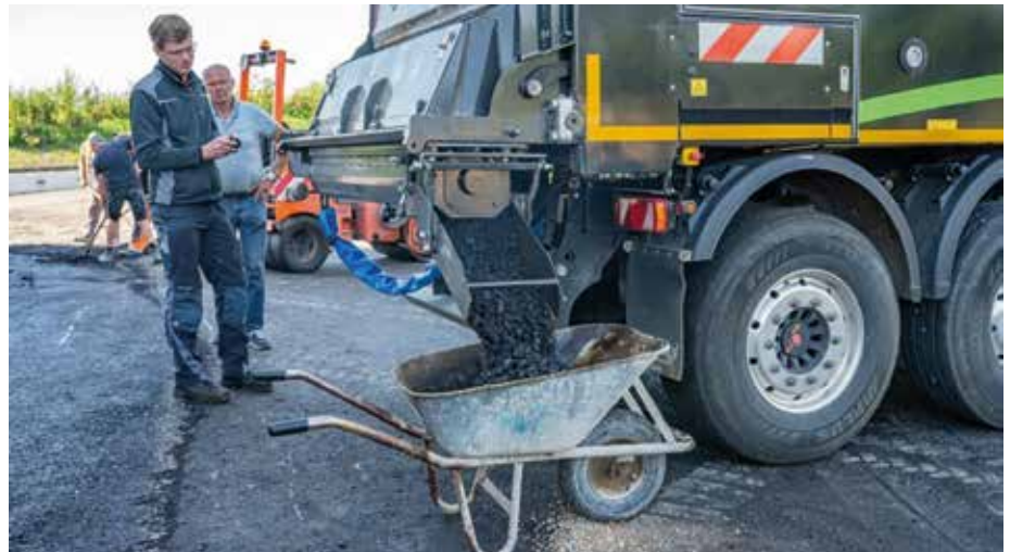
Weltpremiere: Fliegl hat das Anbaugerät „Wiesel Compact“ vorgestellt. Die um 180 Grad schwenkbare Rutsche sorgt für präzise Materialdosierung und hohe Arbeitssicherheit, insbesondere beim Umgang mit heißem Asphalt. (Foto: Fliegl Bau & Kommunaltechnik)
