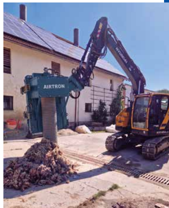
Allrounder: Der Airtron saugt leichte Materialien mühelos ein, während Schutt, Steine und Erdreich liegen bleiben. Zudem ist er kompatibel mit allen gängigen Schnellwechselsystemen. (Foto: Armin Mörtlbauer GmbH)
