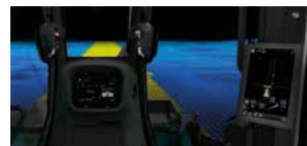
Innovative 3D-Modellierung: 3D-Geländemodelle entstehen mit Free Modelling direkt in der Fahrkabine. (Foto: Liebherr)
