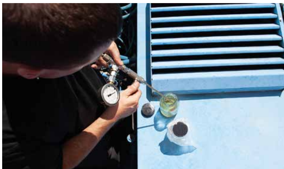
Sicherheit für den Bediener: Die Kombination aus Druckreduzierventil und Manometer stellt sicher, den Druck an der Entnahmestelle genau zu dosieren.
