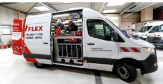
Bestens ausgestattet: Die Hansa-Flex-Fahrzeuge verfügen über die notwendige Ausrüstung, um Hydraulik-Schlauchleitungen direkt vor Ort zu fertigen und einzubauen.
