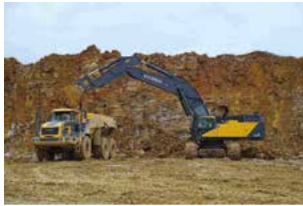
Effizientes Duo: Der Dumper HA45 und Hydraulikbagger HX1000A beim Abbau von Abraum vor der Kalksteinbruchwand in Walzbachtal. (Foto: Hyundai)
