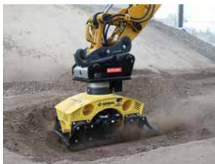
Leistungsstarke Lösung: Die Bomag-Modelle BPA 100 und BPA 300 machen den Bagger zum Verdichtungswerkzeug. (Foto: Bomag)
