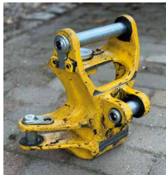
So gut wie Neu: Schwenkbock mit Buchsen und Bolzen aufgearbeitet und wiederverwendet. (Fotos: Arman)
