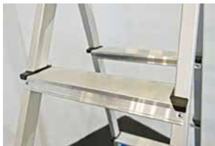
Sichere Leiternutzung: Beim Einsatz von Leitern gilt: Stufe statt Sprosse. (Foto: BG Bau/ Michael Gottschalk)
