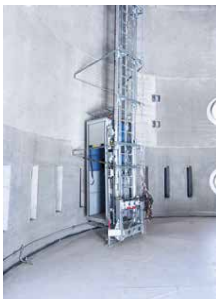
Zuverlässig: Der akkubetriebene Lift Geda SH 250 W ist ab dem ersten Meter nutzbar und bietet Transportmöglichkeit für bis zwei Personen und Material. (Foto: Geda)
