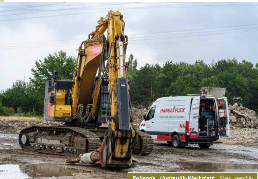
Rollende Hydraulik-Werkstatt: Statt beschädigte Komponenten auszubauen und in eine Werkstatt zu transportieren, werden die Arbeiten vor Ort ausgeführt. (Foto: Hansa-Flex)
