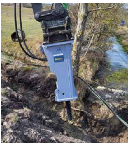
Gewicht gespart: Der EC 122 bringt 1.120 kg auf die Waage, 80 kg weniger als sein Vorgänger. (Foto: Epiroc)
