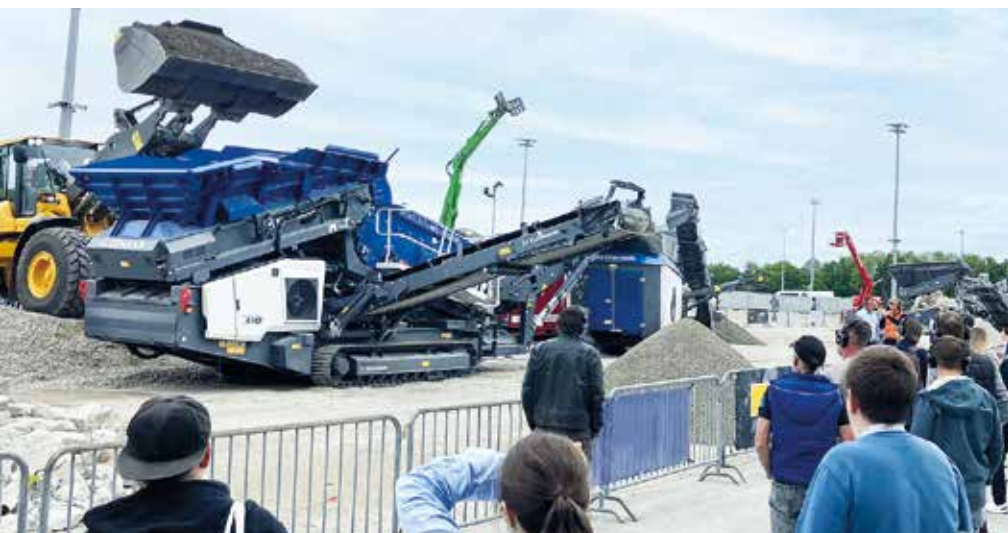
Premiere: Kleemann nahm erstmals als Aussteller an der IFAT teil. Der Spezialist für mobile Brech- und Siebanlagen zeigte praxisnahe Lösungen für die Asphaltaufbereitung. (Foto: Wirtgen)
