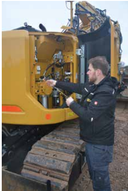
Gut erreichbar: Mühelos lässt sich der Ölfüllstand vom Boden aus kontrollieren, wie Zeppelin Serviceberater Matthias Hilger demonstriert.
