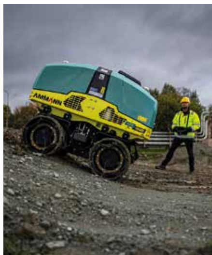
Leistungsstarker Kletterer: Die ARR 1585-2 erreicht mit Allrad mühelos eine Steigfähigkeit von 30 % und hält dabei eine seitliche Stabilität von 25 %. (Foto: Ammann Group)
