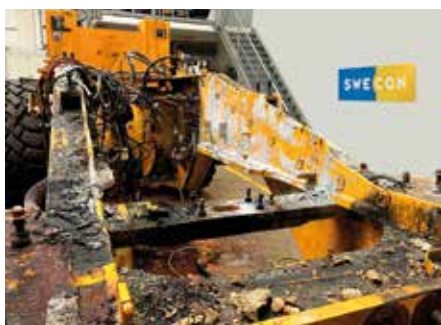
Viel zu tun: In der Swecon Service-Werkstatt zeigt sich das Ausmaß der Korrosion.
