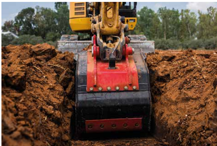
Neuer Sicherheitsstandard: Der Löffelradar reduziert Risiken bei Baggerarbeiten und verhindert kostspielige Verzögerungen. (Foto: Sitech)
