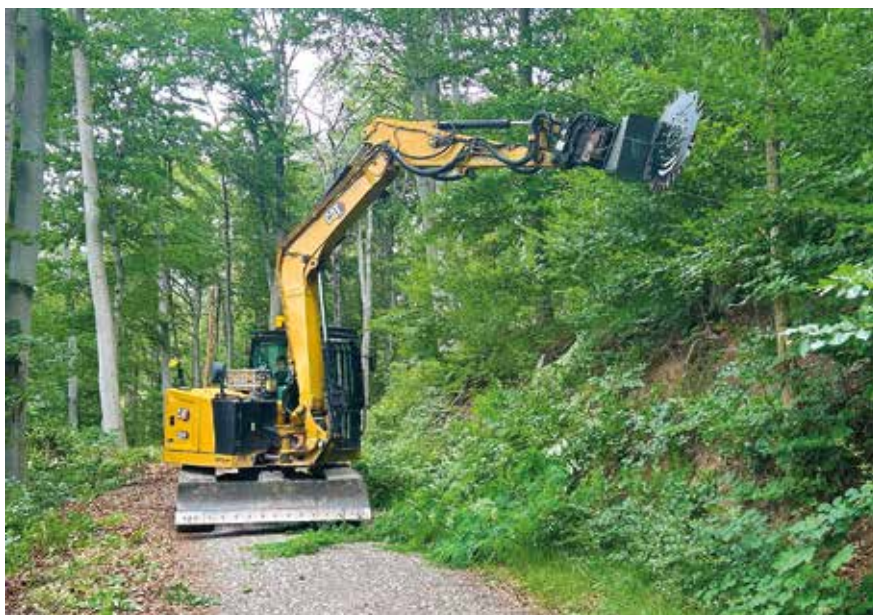
Ohne kostspielige Hubarbeitsbühne: Für Schnitt- und Sägearbeiten bis zu einem Durchmesser von 20 cm auch in großer Höhe reicht ein mit RotoTop und CutWheel ausgestatteter Bagger völlig aus. (Foto: Holp)
