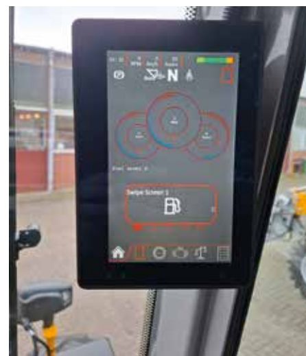
Sicherer und effizienter: Die Lastmomentüberwachung auch in Querrichtung für Teleskopschwenklader von Paus. (Foto: Paus)
