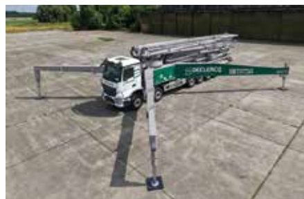
Einzigartige Kombination: Die Bonneux Xanjer Betonpumpe 6RZ73 auf einem siebenachsigen Mercedes-Benz Arocs 4553K. (Foto: Daimler Truck)
