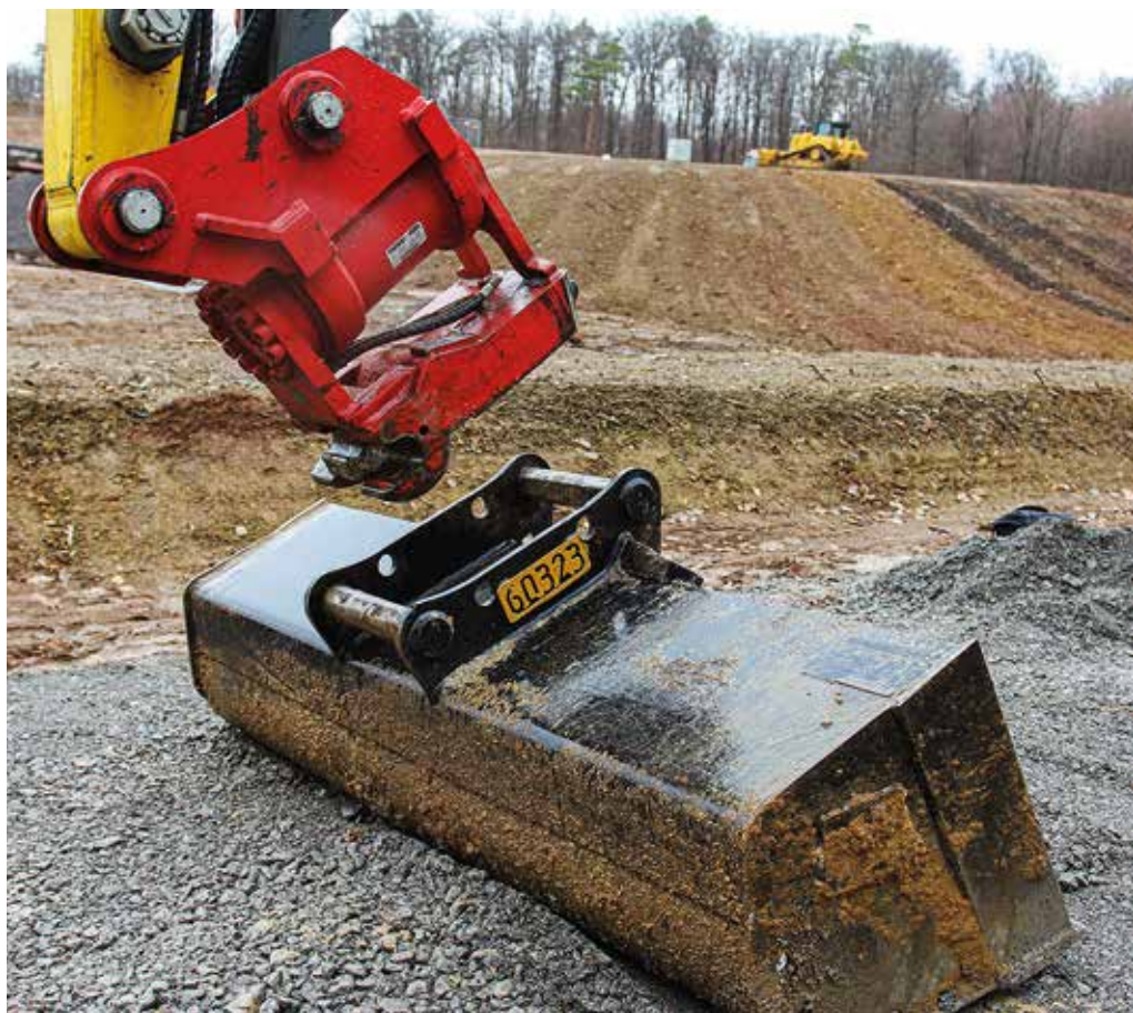
Sicherheit auf der Baustelle: Das Doublelock-System von Lehnhoff verhindert ein unbeabsichtigtes Lösen des Schnellwechslers. (Foto: Lehnhoff Hartstahl)
