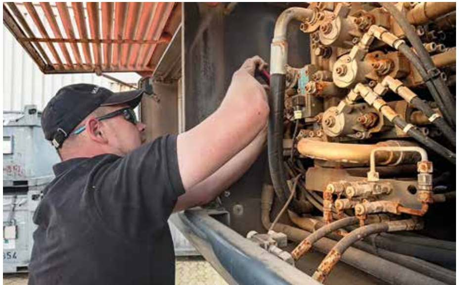
Kontrolle statt Vertrauen: Dichtungen, Hydraulikschlauchleitungen und Rohrleitungen sollten regelmäßig auf Risse, Korrosion oder Verschleiß geprüft werden. (Foto: Hansa-Flex)
