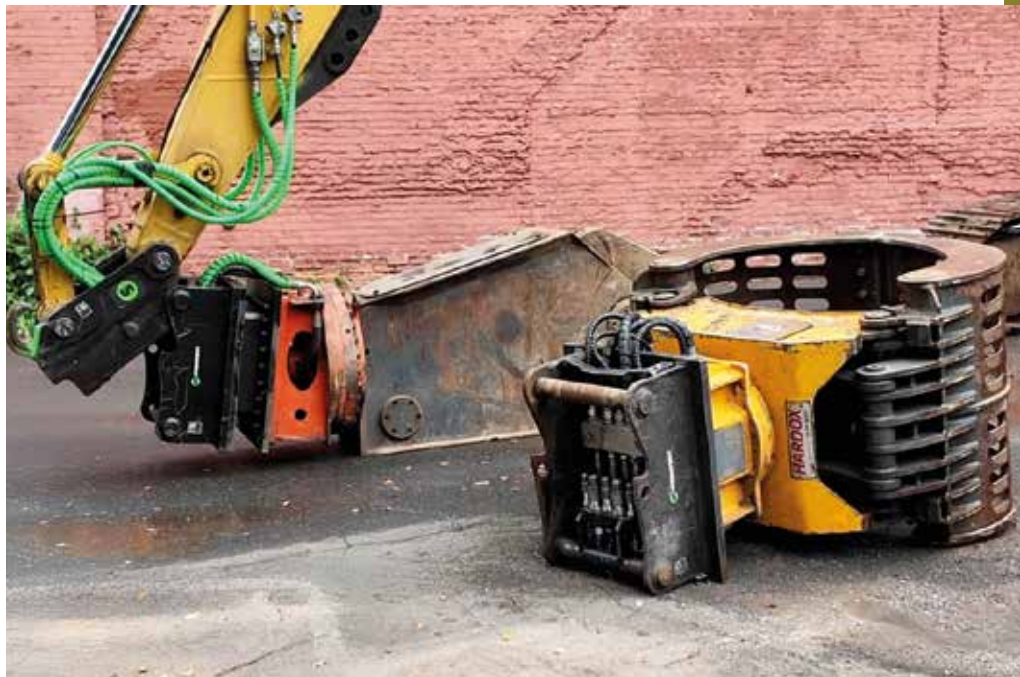
Hocheffizient: Der neue SQ40-Automatik-Schnellwechsler stellt die Durchflussleistung für anspruchsvolle hydraulische Werkzeuge sicher. (Foto: Steelwrist)
