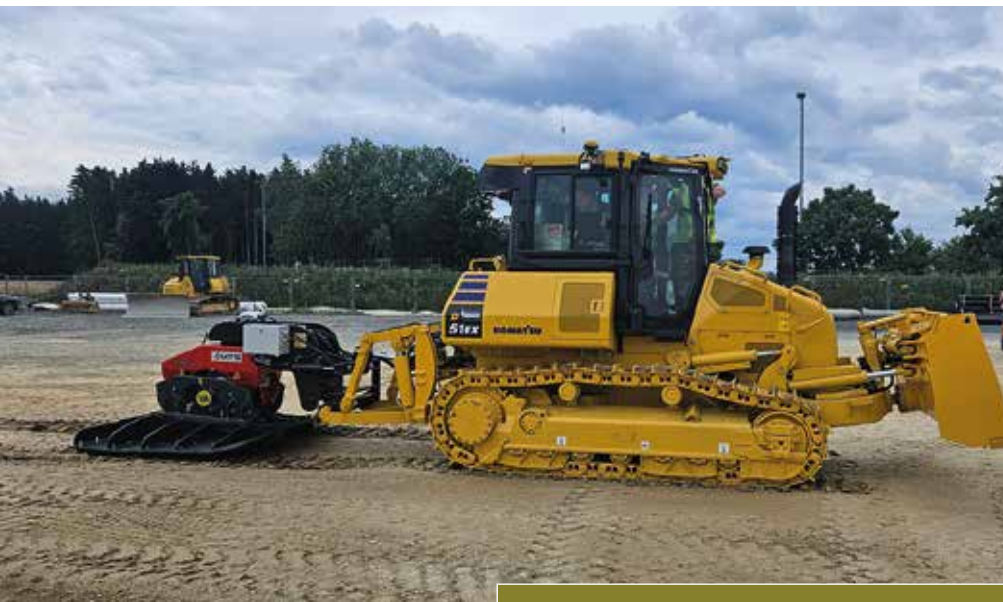
Außergewöhnliche Lösung: Mit der Sonderanfertigung von Schlüter für Baumaschinen können Stromtrassen auf 3 cm genau positioniert und verlegt werden. (Foto: Schlüter)
