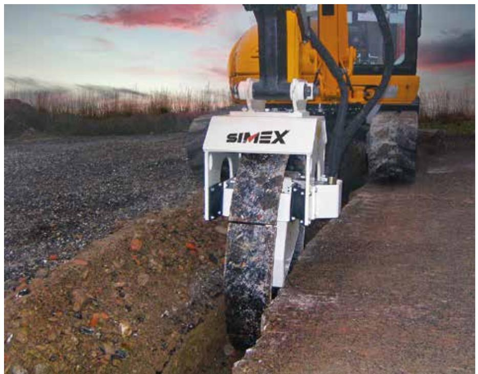
**Perfektes Ergebnis:** Die Verdichterräder CT 2.8 und CT 3.8 an von Simex sorgen für einen festen und homogen verdichteten Untergrund. (Foto: Simex)
