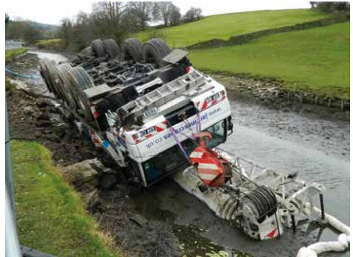
**Zweifach gesichert:** Die Gefahr eines Kranumsturzes wird durch die Abstützung des Fahrzeugkranes verhindert, zusätzlich muss aber auch der Untergrund geprüft werden. (Foto: pixabay/dagrimshaw)
