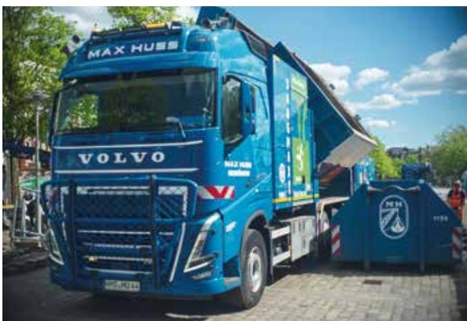
**Abkippen vor Ort:** Die vier eingesetzten Saugbagger haben an nur einem Tag 165 m<sup>3</sup> Boden gesaugt. Die vollen Container wurden in Abrollkipper entleert und diese dann abtransportiert.
