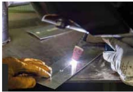
**Porenfreie Schweißnähte:** Der Alu Wizard ist ein patentiertes Verfahren, das Aluminium mit oder ohne Zusatzwerkstoff schweißt. (Foto: Gys)
