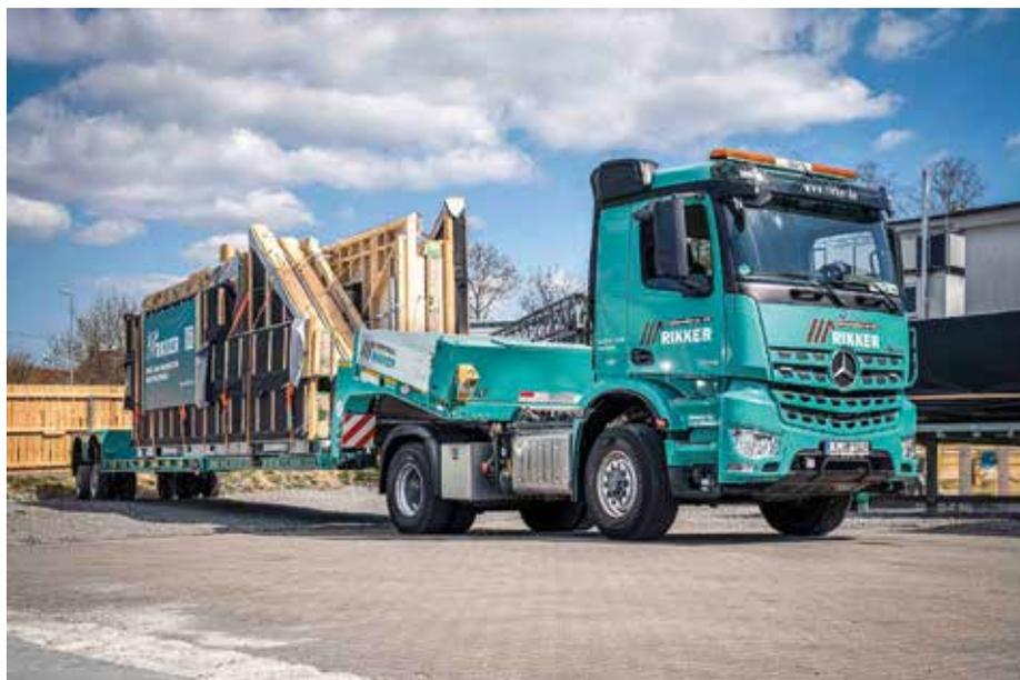
**Vereinfachter Transport:** Mit dem Doll Tiefbett können die Holzelemente von Holzbau Rikker unter einer Höhe von 4,25 m ausgeliefert werden. (Foto: Doll)
