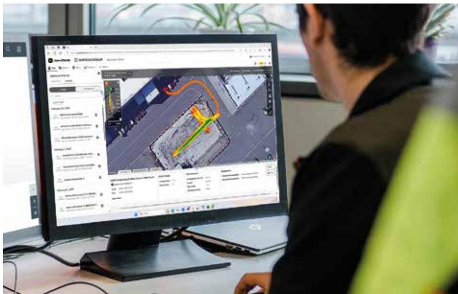
**Transparenz für die Bauleitung:** WPT Compacting liefert im John Deere Operations Center alle Daten für das Monitoring, die Dokumentation, Analyse und das Reporting einer Baustelle. (Foto: Wirtgen Group)
