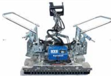
Mit der HVZ-Pavertron können bis zu 700 m<sup>2</sup> Pflasterfläche pro Tag verlegt werden. (Foto: Probst)
