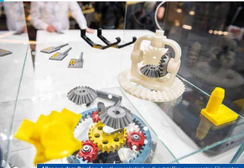
**Alles aus dem Drucker:** Aus thermoplastischen Kunststoffen, sogenannten Filamenten, wurden bei Zeppelin bereits Werkzeugschlüssel oder Planetengetriebe gedruckt. (Foto: Zeppelin/Michael Namberger)
