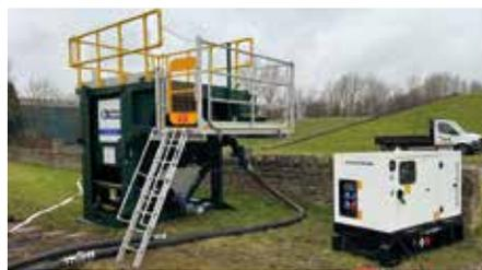
United Rentals stellt einen Batteriespeicher mit einer Ausgangsleistung von 360 kVA und einer Nennkapazität von 610 kWh und einen Filter-Tank mit einer Kapazität von 50 m<sup>3</sup>/h vor. (Foto: United Rentals)
