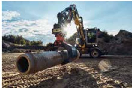
Der EW100 ist mit der MiC 4.0 Schnittstelle ausgestattet. Er erkennt so MiC 4.0-kompatible Anbaugeräte automatisch und nimmt notwendige Einstellungen vor. (Foto: Wacker Neuson)
