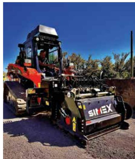
**Kosten sparend:** Die Spezialfräse ART 1000 ermöglicht eine direkte Wiederverwendung des gefrästen Asphalts. (Foto: Simex)
