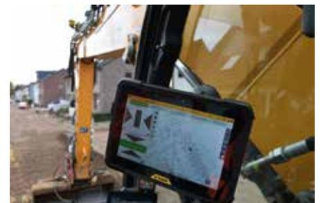
**Im Bilde:** Der Maschinist kann mit Hilfe der Informationen auf dem Feldrechner sehr exakt arbeiten und sieht, welche Einbauten sich unterhalb der Oberfläche befinden.
