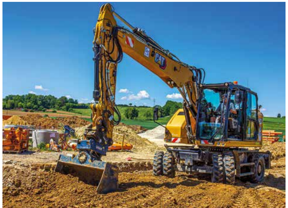
Neue Flexibilität: Der Lehnhoff SQ60 mit symmetrischen Ventilblock ermöglicht, einen Schwenklöffel auch im Hochlöffelbetrieb zu betreiben. (Foto: Lehnhoff)
