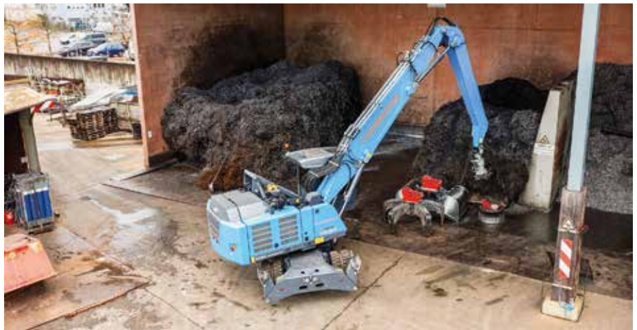
Multifunktionaler Geräteträger: Der TQC-Schnellwechsler ermöglicht auch der Umschlagbranche eine Effizienzsteigerung, die man von Baggern auf Baustellen schon lange kennt. Die Anbaugeräte lassen sich innerhalb von Sekunden wechseln. (Foto: Kiesel)
