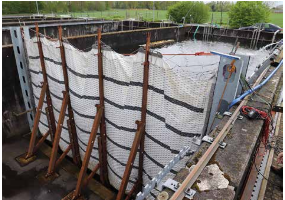
Innovatives System: Leicht aufbaubar, umweltschonend, geprüft und mittlerweile bis zu 4 m hoch sind die mobilen Hochwasserschutzwände. (Foto: Aquaburg)
