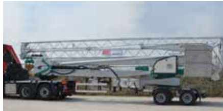
Schnell einsatzbereit: Die 2-Strang-Technik des Schnellmontagekrans CM 271S1 von BKL ermöglicht ein hohes Umschlagtempo. (Foto: BKL)
