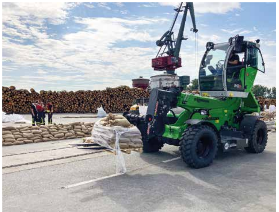
Schadensvermeidung: Ein Sennebogen Teleskopplader transportiert Sandsäcke auf dem Hafengelände. (Foto: Feuerwehr Deggendorf)
