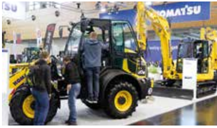
Kompakter Allrounder: Der WA80M-8EO von Komatsu mit einem Schaufelvolumen von 0,8 bis 1,25 m 3 wurde genauestens unter die Lupe genommen. (Foto: NuernbergMesse/ Frank Boxler)
