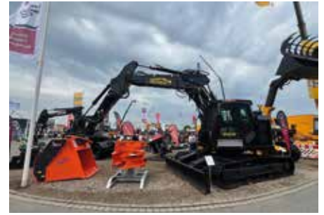
Ganz in schwarz: JCB-Kettenbagger 245 XR mit Sonderlackierung und ausgestattet mit Terra-Star-Schaufelseparator von Wolf. (Foto: VDBUM/Spoo)
