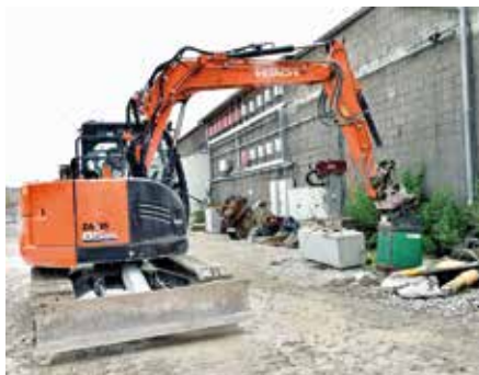
In Sekundenschnelle: Dank Holp Rotator und OilQuick System kann der Hitachi-Kompaktbagger Anbaugeräte im Handumdrehen schnell und sicher wechseln. (Foto: Kiesel GmbH, Dieter Göllner)
