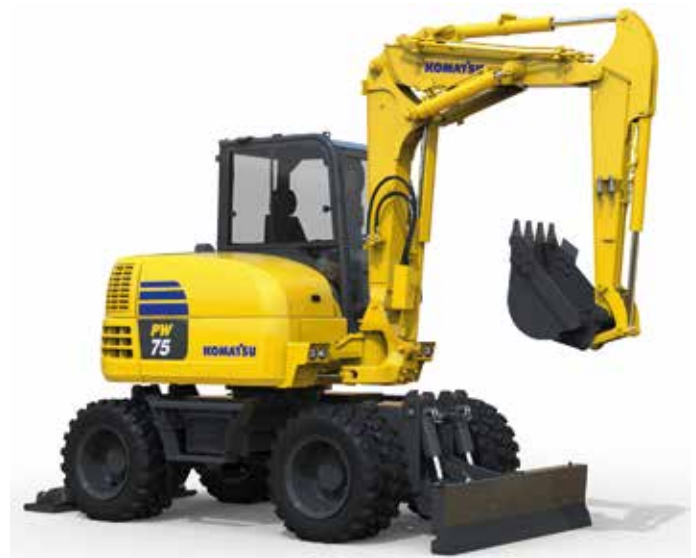
Der Prototyp eines völlig neuen Mobilbaggers mit einem Betriebsgewicht von 7,5 t.
