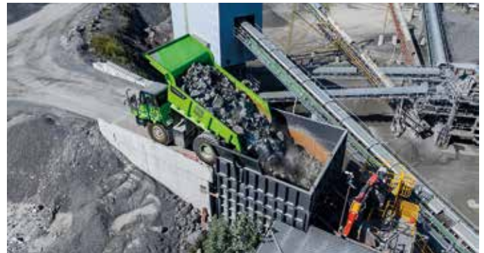
Der vollelektrische Muldenkipper DR50CE hat sich bereits im anspruchsvollen Tunnelbau bewährt. (Foto: Liugong)
