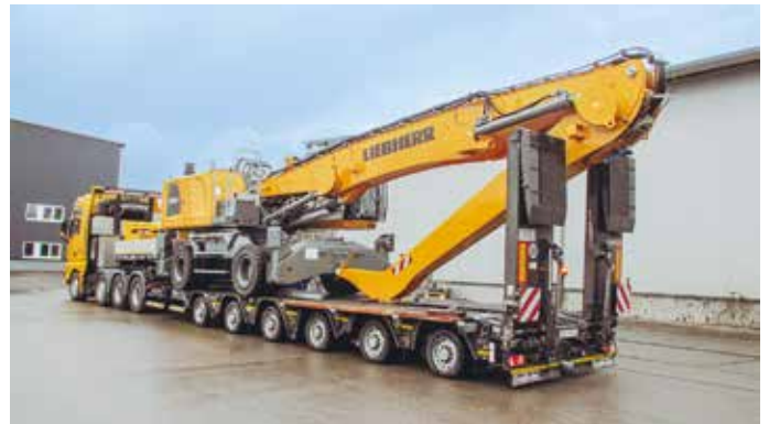
Goldhofers Arcus P mit Cargo-Plus-Bereifung erreicht eine Ladehöhe von nur 735 mm. (Foto: Goldhofer)
