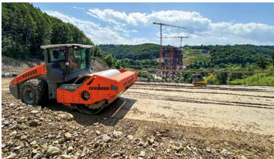
Hohe Verdichtungsleistung: Die Hamm-Walze THC 200i kann über Bluetooth Low Energy an die App Smart Doc zur flächendeckenden Verdichtungskontrolle und -dokumentation angebunden werden. (Foto: Hamm)
