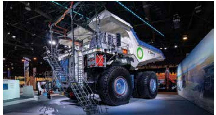
Der autonome, batterieelektrische T 264 ist wegweisend für die Dekarbonisierung im Bergbau. (Foto: Liebherr)
