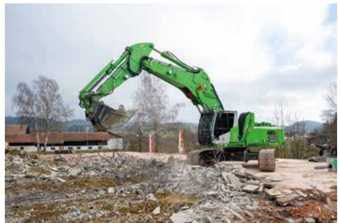
Der Sennebogen 830 E eignet sich mit dem 1,7m 3 fassenden Tieflöffel für Abbrucharbeiten und klassische Erdbewegungsaufgaben.
