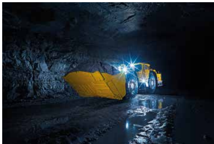
Die Schaufel des Scooptram ST18 SG Untertageladers ist mit Hardox 450 aus SSAB Zero gefertigt. (Foto: SSAB)
