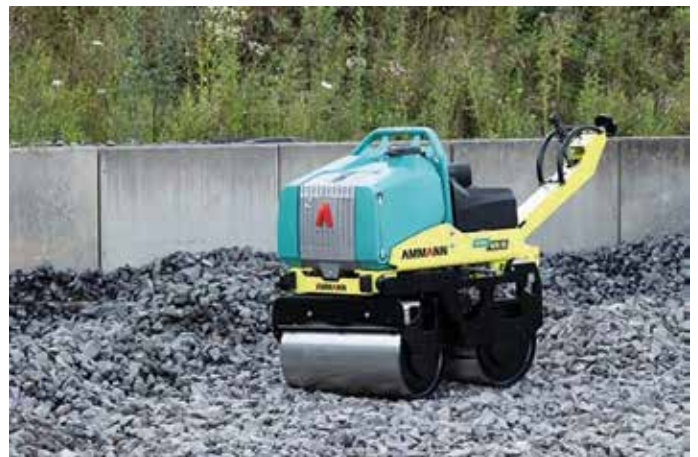
Die Handgeführte Walze ARW 65-S lässt sich vorwärts, rückwärts und seitlich bewegen.
