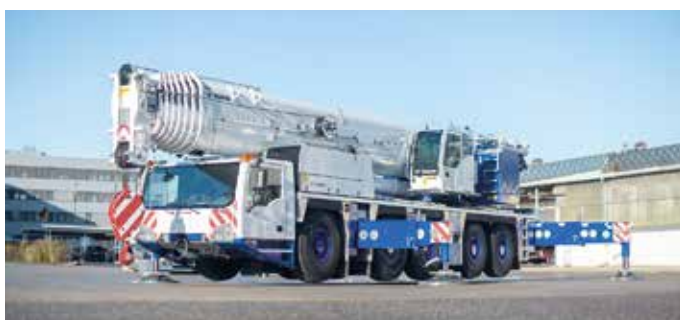
Der Hauptausleger des AC 5.250L-2 wurde gegenüber dem Vorgängermodell auf 79 m verlängert. (Foto: Tadano)
