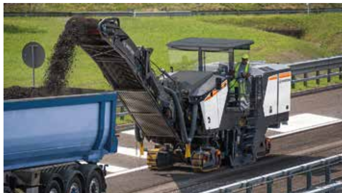
Die Großfräse W 210 XF kommt auf Autobahnen, Bundesstraßen und Flughäfen zum Einsatz. (Foto: Wirtgen)
