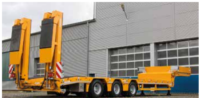
Die Baureihe ST von Zandt Cargo ist bestens für den Transport von Baggern geeignet. (Foto: Zandt Cargo)
