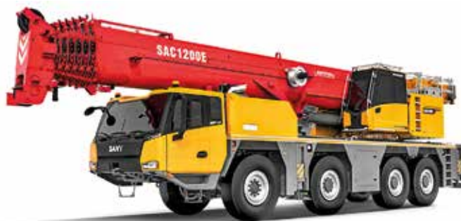
Der Sany SAC1200E All-Terrain-Kran eignet sich für sehr beengte Aufstellbedingungen. (Foto: Sany)
