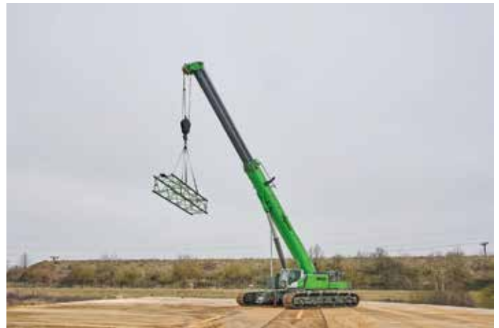
Der 6203 E verfügt über einen 6-teiligen Pin Boom-Ausleger, der auf bis zu 56,4 m austeleskopiert werden kann (Fotos: Sennebogen)
