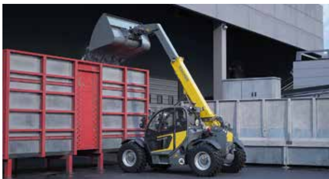
Der 3106 hebt Lasten von bis zu 3.100 kg auf eine maximale Stapelhöhe von 5,83 m. (Foto: Kramer)
