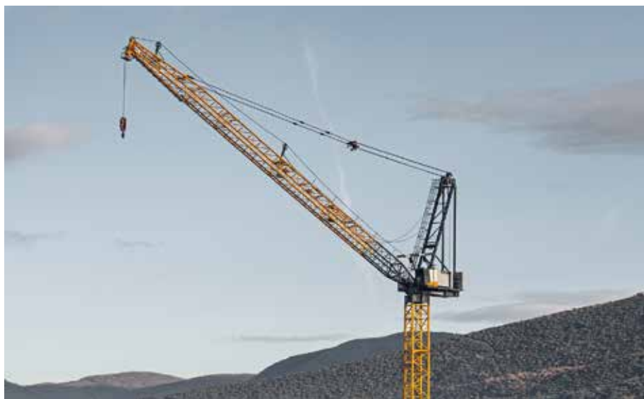
Kraftprotz: Der 620 HC-L von Liebherr kann bis zu 36 t heben. (Foto: Liebherr)
