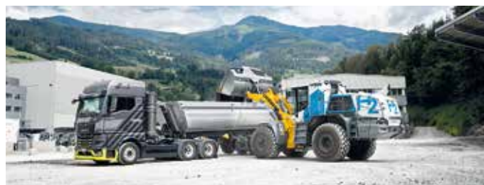
Der L 566 H ist der erste Prototyp eines Großradladers mit Wasserstoffmotor. (Foto: Liebherr)
