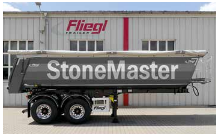
Der ZHKS 350 Stone Master mit Stahmulde bietet eine Nutzlast von 26.772 kg bei 27 m 3 Volumen. (Foto: Fliegl)
