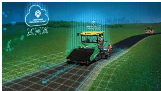
Smart Pave steuert Einbaubreite, -lage und -richtung auf Basis virtueller Daten vollautomatisch. (Foto: Vögele)
