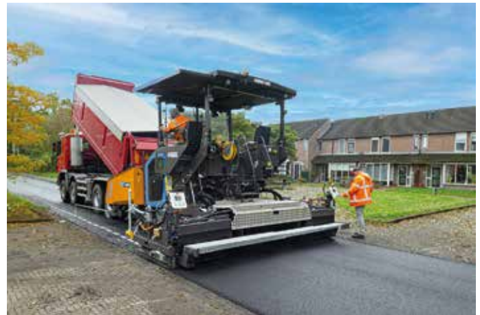
Ein Highlight bei Ammann ist der elektrisch angetriebene Straßenfertiger eABG 4820. (Fotos: Ammann)
