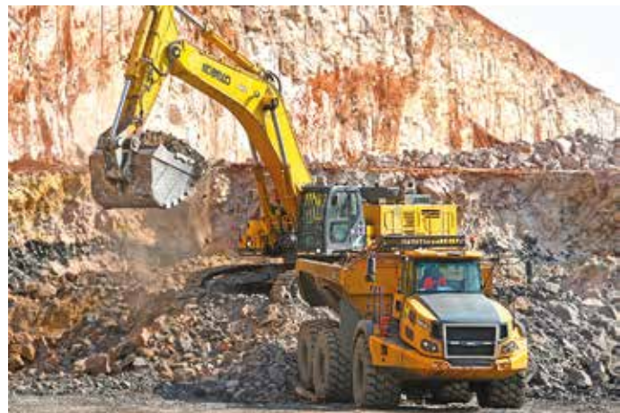
45,4 t Nutzlast machen den Bell B50E zu einer hochproduktiven Transportlösung. (Foto: Bell Equipment)
