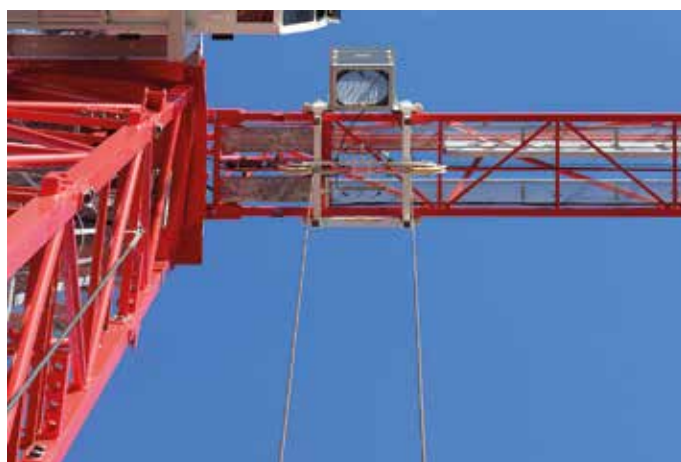
Das High-Speed-Positioning-System legt den Grundstein für den autonom fahrenden, digitalisierten Kran.
