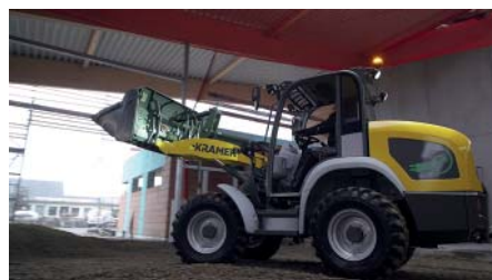
Dank des vollelektrischen Antriebs lassen sich mit dem Kramer 5055e Arbeiten im Innenbereich völlig emissionsfrei ausführen. (Foto: Kramer)
