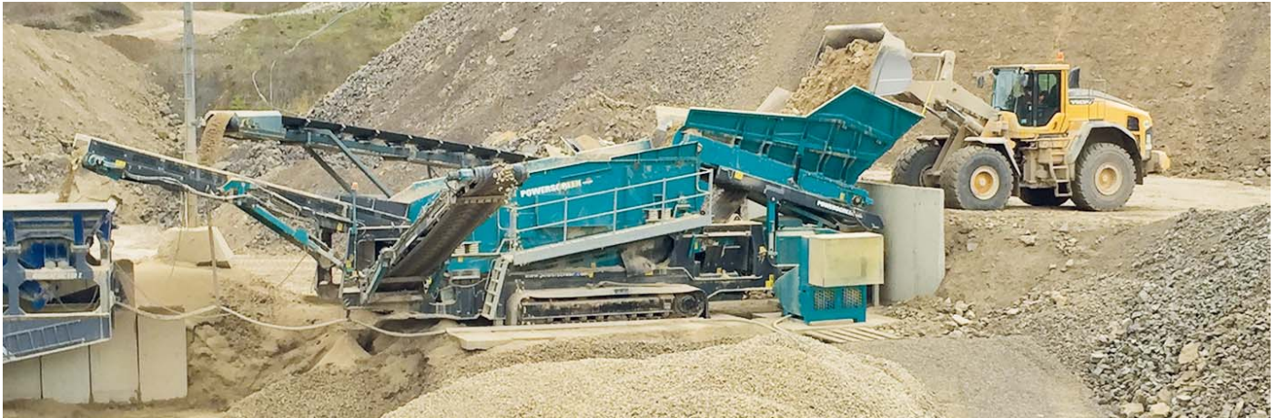
Zur rückwärtigen Radladerbeschickung wurde die Siebanlage auf Kundenwunsch mit einer seitlichen Trichterhöhung versehen. (Christophel)
