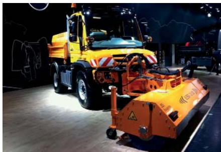
Der innenliegende Hydraulikmotor verleiht der neuen Anbau-Kehrmaschine eine kompakte Form. (Foto: AS Baugeräte)
