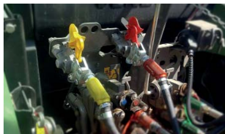
Jetzt auch für Druckluftleitungen: Schlauchmarkierungsgriffe in Rot und Gelb verhindern sicher ein Verwechseln der Leitungen. (Foto: Ernst Wagener Hydraulikteile)
