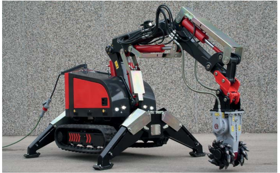
Der kleine Abbruchroboter kommt mit seiner geringen Transporthöhe und –breite durch jede Tür. (Fotos: Kiesel)
