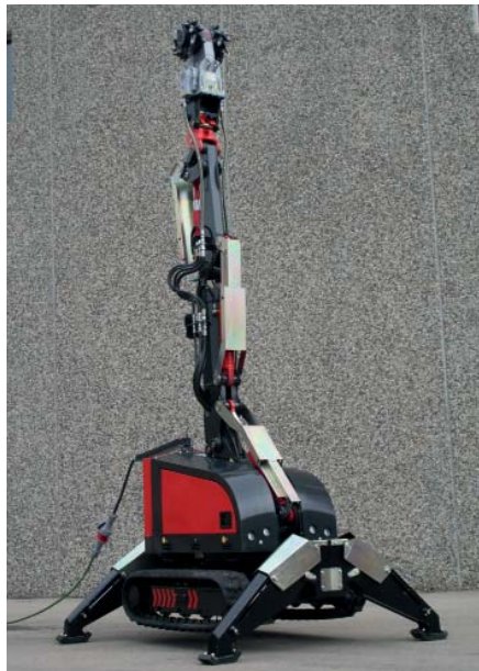
Über-Kopf-Arbeiten sind bis in eine Höhe von 4,5 m kein Problem.
