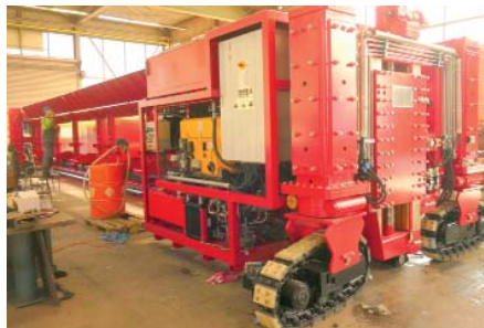
Bei diesem Straßenfertiger mit 14,5-m-Einbaubohle für Gussasphalt verbaute AGT einen luftgekühlten Vierzylindermotor mit Dieselpartikelfilter. (Foto: Hatz)
