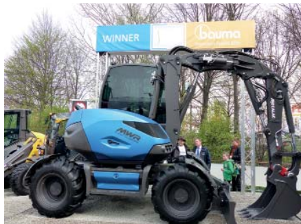
Revolutionäres Konzept: Oberwagen so niedrig wie möglich zwischen den Rädern positionieren und dabei die Rundumdrehung beibehalten. (Foto: (Mecalac))
