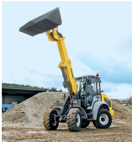
Der kleine Teleradlader 5065T überzeugt mit einem Schaufeldrehpunkt von bis zu 4,25 m bei einer maximalen Stapelnutzlast von 1.600 kg. (Foto: Kramer)
