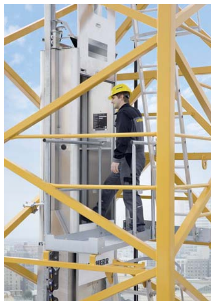
Witterungsunabhängig und sicher: Der Lift befördert den Kranfahrer in kürzester Zeit an seinen Arbeitsplatz. (Foto: Liebherr)
