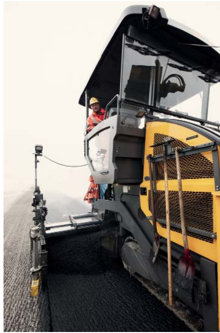
Sensoren ermitteln in Echtzeit , wie viel Asphalt verwendet wird. Bestellmengen können sofort angepasst, überschüssige Lieferungen vermieden werden.
