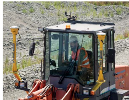
Auch Radlader können jetzt die neueste Version der Maschinensteuerung Grade Control System nutzen. (Foto: Trimble)
