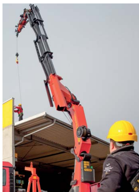
Palfinger kann die Personensicherung mit dem Ladekran als einziger Hersteller anbieten.
