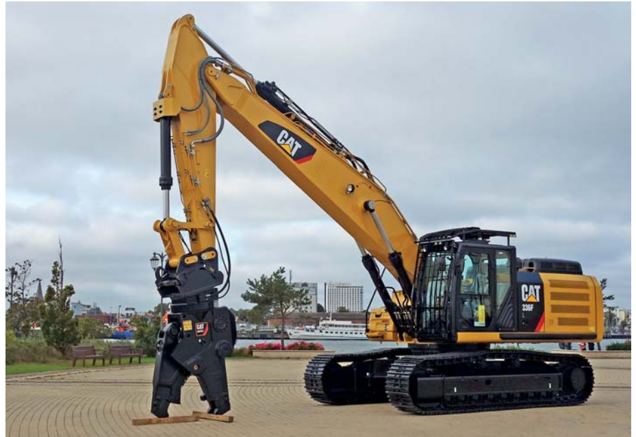
Speziell für den Abbruch: Der neue Cat 336F SB mit geradem Ausleger, mehr Kontergewicht und vielen anderen Ausstattungsmerkmalen. (Foto: Zeppelin)
