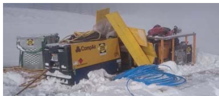
Eine Extra-Kaltstarteinrichtung sichert auch bei widrigen Klimasituationen den Motorstart, wie hier im Einsatz auf der Baustelle Lawensprenganlage Bettmeralp in der Schweiz.
