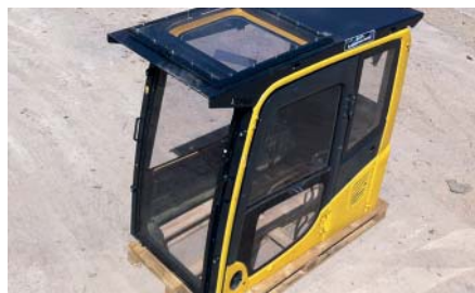
Bei der neuen FOPS-Kabine kann auf Schutzgitter verzichtet werden, der Fahrer hat freies Sichtfeld. (Foto: Echle)
