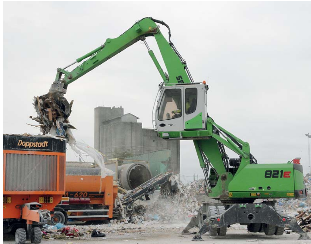
Zur Beschickung des Shredders wird der neue Sennebogen 821 vorrangig eingesetzt. Zudem unterstützt er die beiden 818 beim Sortieren und Verladen. (Fotos: Sennebogen)
