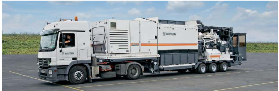
Kompakt „verpackt“: Beim Transport sind alle Anlagenkomponenten an Bord des Satteltiefdeckers, weitere Komponenten müssen nicht abgebaut und transportiert werden.
