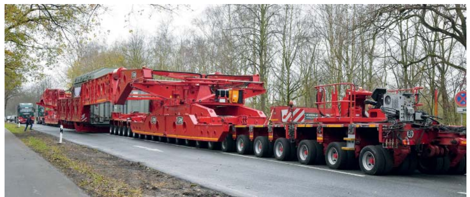
Die 600-t-Scherenhubbrücke transportierte die beiden schweren Transformatoren über eine Strecke von knapp 8 km. Dabei betrug das Gesamtzuggewicht je Fahrt rekordverdächtige 909 t. (Goldhofer)
