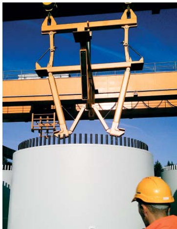
Mit der neuen Traverse ließ sich die Zeit zum Ein- und Auslagern reduzieren und das Personal auf den Kranführer beschränken. (Foto: Max Bögl)
