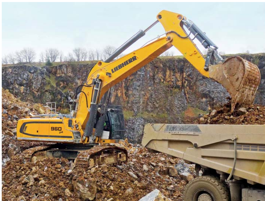
Der Raupenbagger R 960 SME ist an die schwierigen Arbeitsbedingungen im Steinbruch angepasst. Er wird bei Cemplapis Warstein zum Beladen von 50-t-Muldenkippern eingesetzt.
