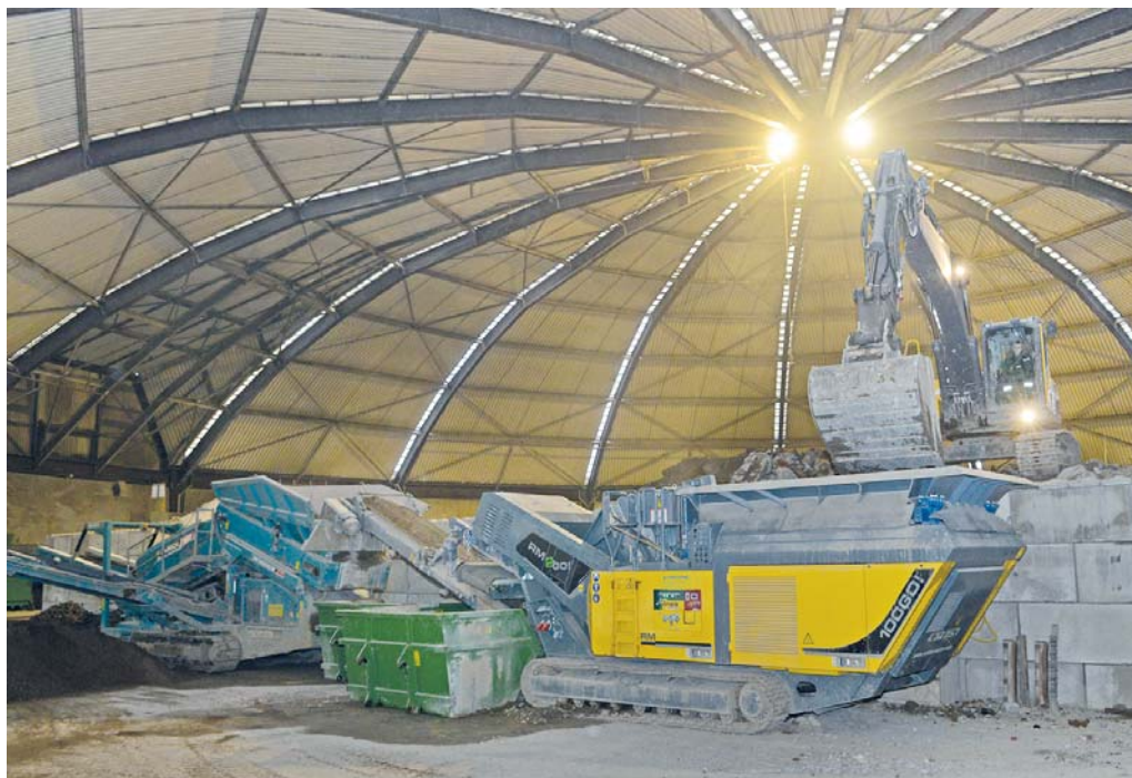
Recyclinginsatz in der Rundhalle: Der Rubblemaster RM 100 Two-Go! mit Hybridantrieb arbeitet besonders wirtschaftlich und umweltfreundlich. (Foto: Christophel)
