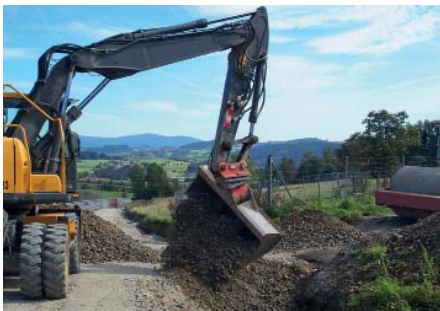
Für mehr Flexibilität im Tiefbau: Der Grabenräumlöffel mit Drehmotor lässt sich um 2x45 Grad schwenken. (Foto: Rädlinger)
