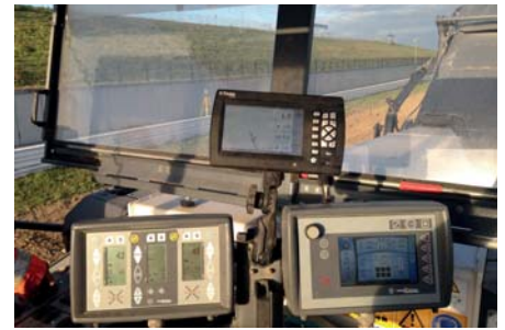
Über die auf der Fräse installierte Kontrollbox ist die Position der Fräswalze in Bezug auf das 3D-Projekt oder die definierte Vertikallinie jederzeit ersichtlich.
