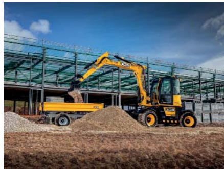
Mit Verstellausleger erreicht der Hydradig eine maximale Reichweite von bis zu 8 m.
