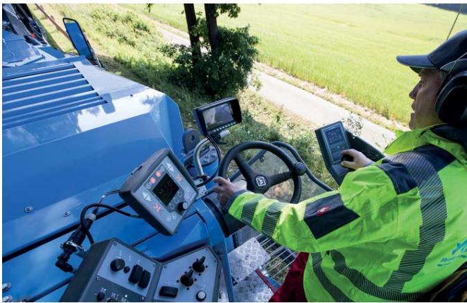
Die ergonomische Multifunktionsarmlehne der W 100 CFI von Wirtgen verfügt über vier Favoritentaster, die wahlweise mit 20 verschiedenen Funktionen belegt werden können, und ein farbiges Bediendisplay. Auf dem kleinen Monitor werden alle wichtigen Informationen – hierzu zählt unter anderem auch die Erfassung und Darstellung der Jobdaten – angezeigt.
