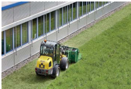
Hydraulische Anbaugeräte machen den Radlader zu einem vielseitigen Geräteträger.
