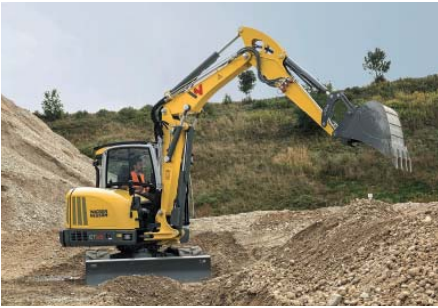
Der kompakte Kettenbagger ET65 bietet durch den seitlichen Versatz des Auslegers sowie eine stark nach vorn abgerundete Motorhaube eine beidseitige Sicht auf Kette und Werkzeug. (Foto: Wacker Neuson)
