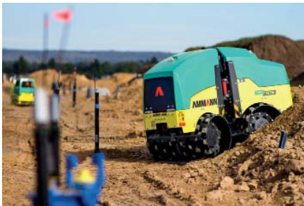
Die Grabenwalzen werden per Infrarot- oder Kabelsteuerung gesteuert und garantieren maximale Arbeitssicherheit. (Foto: Ammann)
