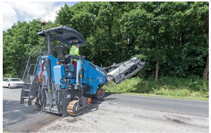
Dank des erhöhten Lenkeinschlags der Vorderachse schafft die Wirtgen W 100 CFI kleinste Wendekreise. Das hydraulische Faltband sorgt zudem für ein schnelles Zusammenfallen des Abwurfbandes. So macht sie auch beim Fräsen von Anschlüssen auf engem Raum eine gute Figur.
