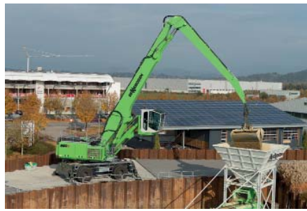
Der neue 860 E ist ein Umschlagbagger speziell für den Schrottschlag und Hafeneinsatz mit Reichweiten bis 23 m und zahlreichen Ausstattungsvarianten. (Foto: Sennebogen)
