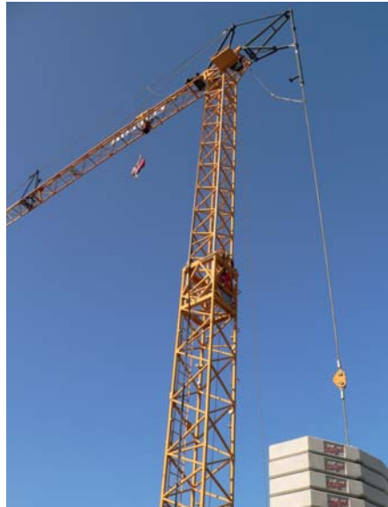
Unterdrehkran mit Fernbedienung: Erstmals können die angehenden Baugeräteführer im ABZ Geradstetten auch an einem Turmdrehkran ausgebildet werden. (Foto: BBW)
