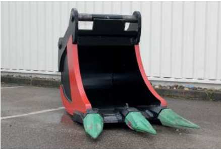
Der Reißlöffel entwickelt dank seiner speziellen Löffelgeometrie maximale Reißkräfte und macht den Einsatz eines Reißzahns oder Hydraulikhammers überflüssig. (Foto: HS-Schoch)
