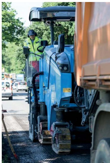
Der hydraulisch um 200 mm nach außen verschiebbare Fahrstand ermöglicht eine optimale Sicht vor das Fräsrollenaggregat und auf das rechte vordere Fahrwerk.
