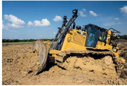
Der neue Kettendozer mit 161 kW (219 PS) Motorleistung (Stufe IV), bis zu 27 t Einsatzgewicht und maximal 5,9 m 3 Schildkapazität. (Foto: Zeppelin)
