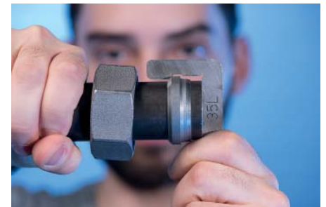
Die Schneidringlehre ermöglicht die sichere Messung der fachgerechten Montage von Stahlrohrverschraubungen. (Foto: Hansa-Flex)
