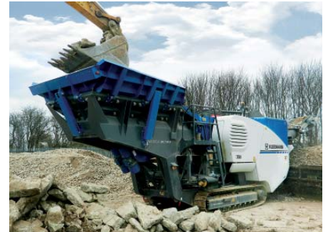
Mit einem Gewicht von 30 t und kompakten Maßen ist der Backenbrecher Mobicat MC 100 R EVO besonders gut transportierbar und eignet sich für Anwendungen an wechselnden Einsatzorten. (Foto: Wirtgen Group)
