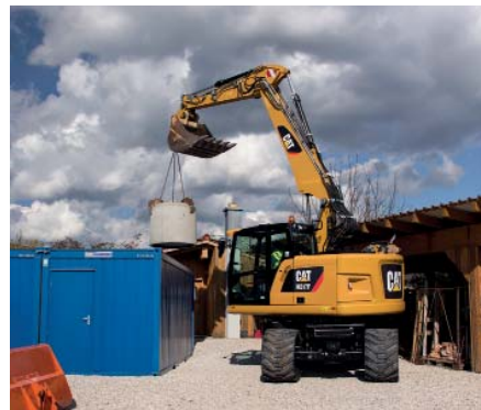
Der neue Mobilbagger M317F zeigt, dass trotz Kurzheck keine Kompromisse bei Leistungsfähigkeit und Standsicherheit eingegangen werden müssen. (Foto: Zeppelin)
