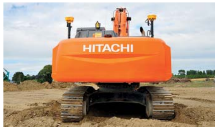
Bereits jetzt liefert Trimble werksmontierte Steuersysteme für die halbautomatischen Bagger von Hitachi. (Foto: Trimble)
