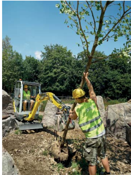
Mit einem Gewicht von 1,5 t ist der Minibagger optimal für den Einsatz auf sensiblen Böden geeignet. (Fotos: Wacker Neuson)
