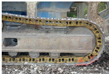
Drei Laufwerksketten einer Cat-Raupe vom Typ D3 wurden für die neue Kette zusammengepresst.
