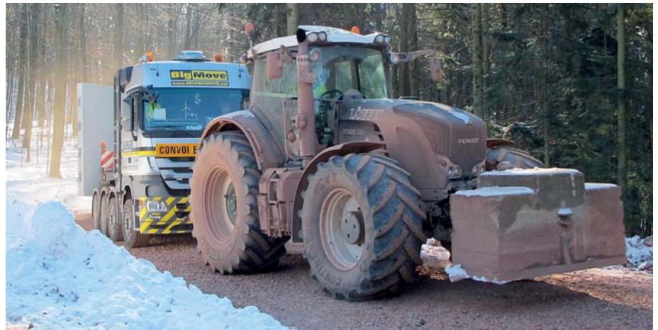
Schwertransport im Hochschwarzwald: Steigungen von 18 Prozent auf den Zufahrtswegen und Außentemperaturen von -15\text{ }^{\circ}\text{C} im Januar. (Foto: BigMove)
