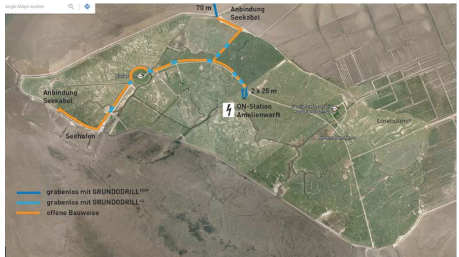
De Hallig Nordstrandischmoor aus der Vogelperspektive mit eingezeichneter Kabeltrasse. (Fotos: Tracto Technik)
